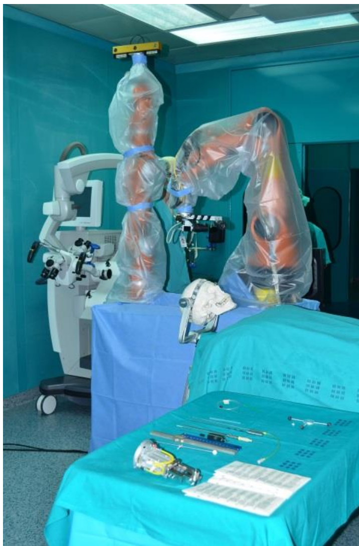
Slika 8. Operacijska sala sa RONNA sustavom robota
