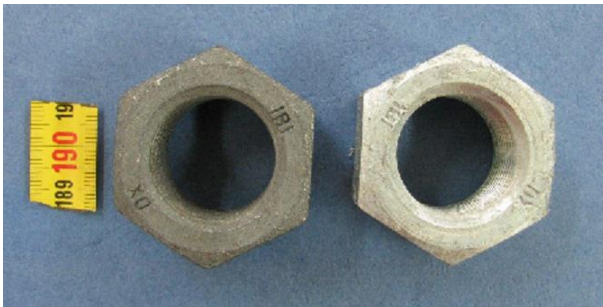
Slika 6.12. Oznake na uzorcima nakon prevlačenja [22]
