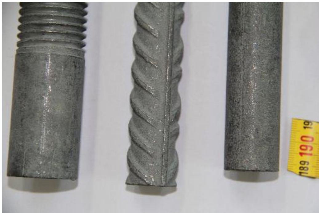
Slika 6.14. Vijci prevučeni postupkom šerardiziranja [22]
