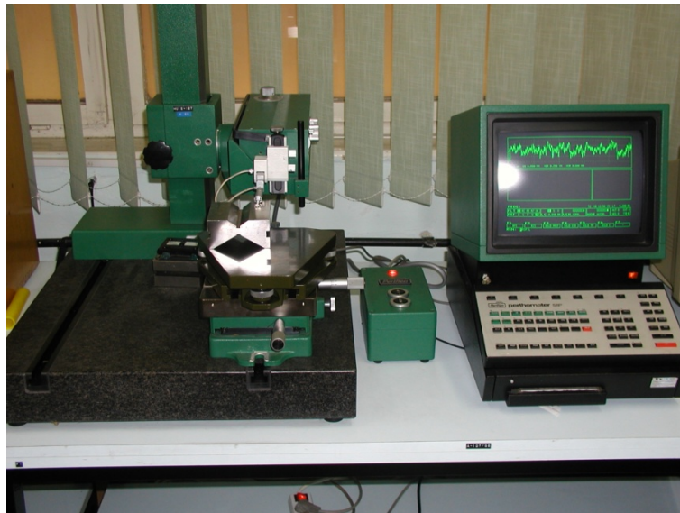
Slika 21. Elektromehanički uređaj za ispitivanje hrapavosti površine MU2-127
