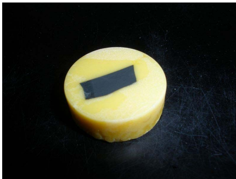
Slika 14. Izgled uzorka nakon zalijevanja
