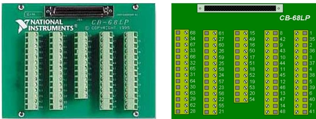
Slika 34: Konektor-blok NI CB-68LP
