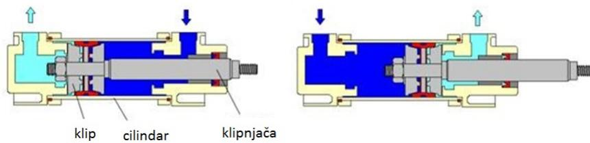
Slika 29: Dvoradni hidraulički cilindar
