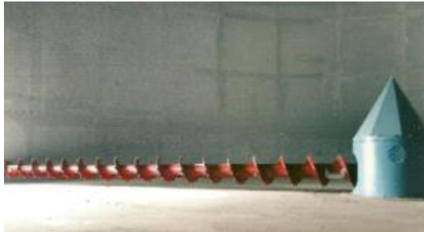
Sustav za pražnjene sa oprugama, pogodan je za transport lake drvene sječke, piljevine ili peleta iz manjih ili srednje velikih silosa okruglog ili kvadratnog profila. Kod projektiranja sustava potrebno je poštivati ograničenja u dužini, kosini transporta, efikasnosti doziranja.
