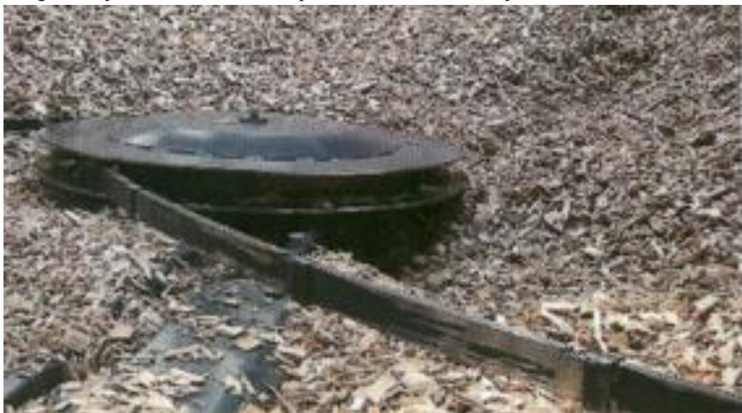
Sekundarni transportni sustav dobavlja gorivo direktno do kotlovnice. Pomoću spremnika ispred ložišta omogućava regulaciju dobave goriva u ložište. Na slici se vidi sustav koji onemogućuje rasipanje goriva po kotlovnici.
