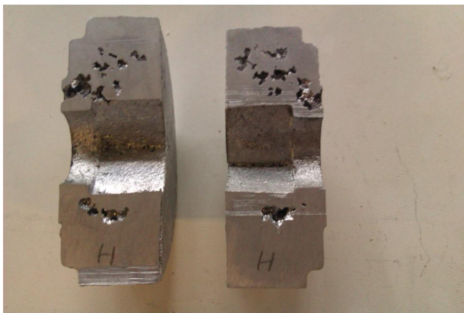
Slika 68. Poroznost u odljevku lijevanom s hladilom
