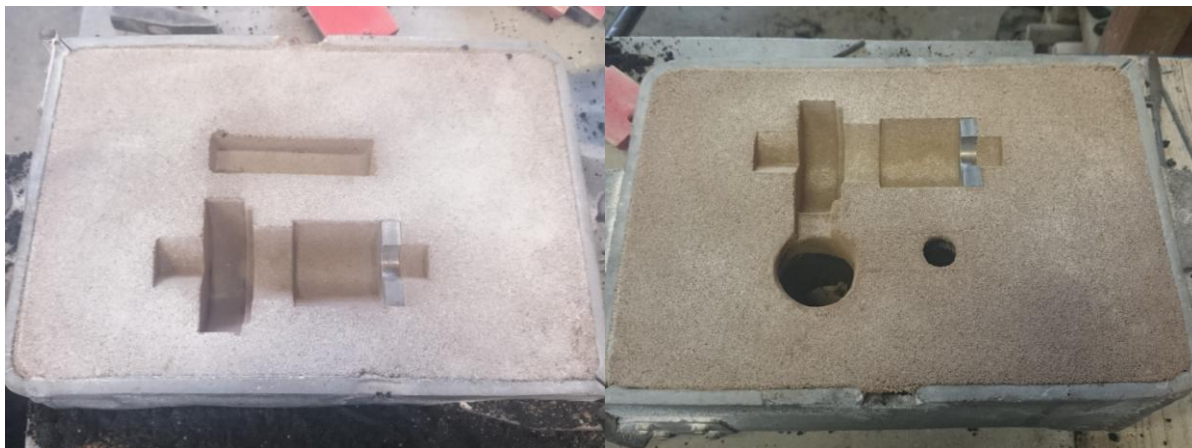
Slika 54. Izvađeni dijelovi modela i uljevnog sustava iz donjaka (lijevo) i gornjaka (desno)
