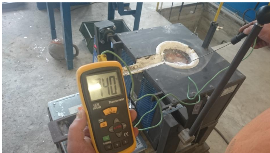
Slika 58. Temperatura taljevine u peći
