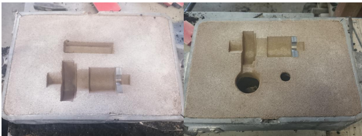
Slika 54. Izvađeni dijelovi modela i uljevnog sustava iz donjaka (lijevo) i gornjaka (desno)
