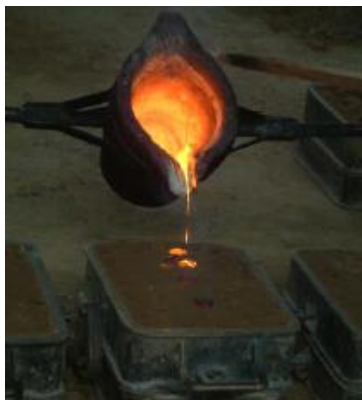
Slika 6. Ulivanje taline u kalup [10]
