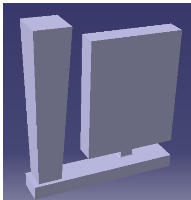
Slika 34: Vertikalni uljevni sustav s ušćem odozdo
