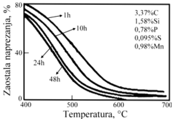
Slika 11: Utjecaj temperature i vremena zadržavanja na uklanjanje zaostalih naprezanja u odljevcima od nelegiranog sivog lijeva [8]
