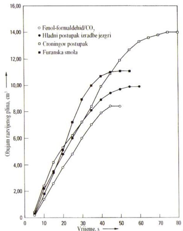
Slika 8: Tijek razvijanja plina različitih jezgrenih materijala za 2 g pokušne tvari pri zagrijavanju na 850 °C (brzina nastajanja plina) [9]
