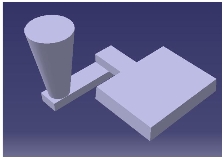
Slika 39: Horizontalni uljevni sustav s jednim ušćem
