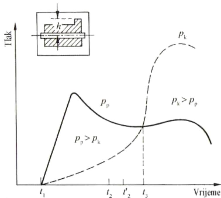
Slika 7: Mehanizam nastajanja plinskih mjeđura iz organski vezanih jezgrenih materijala [9]
