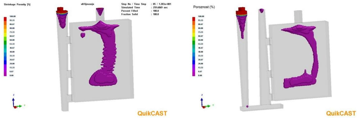
Slika 23: Poroznost u odljevcima sa stepenastim uljevnim sustavom
