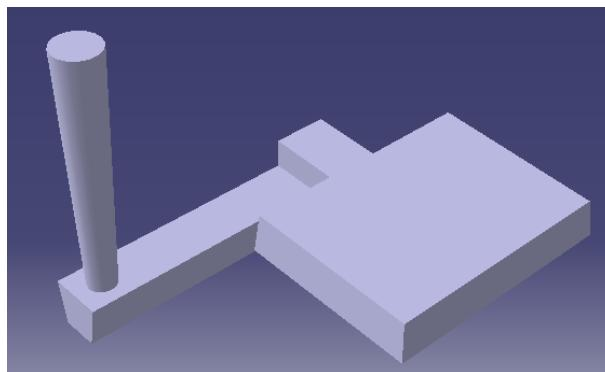
Slika 28: Horizontalni uljevni sustav s jednim ušćem
