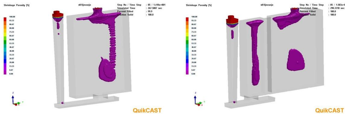
Slika 22: Poroznost u odljevcima s ulijevanjem odozdo
