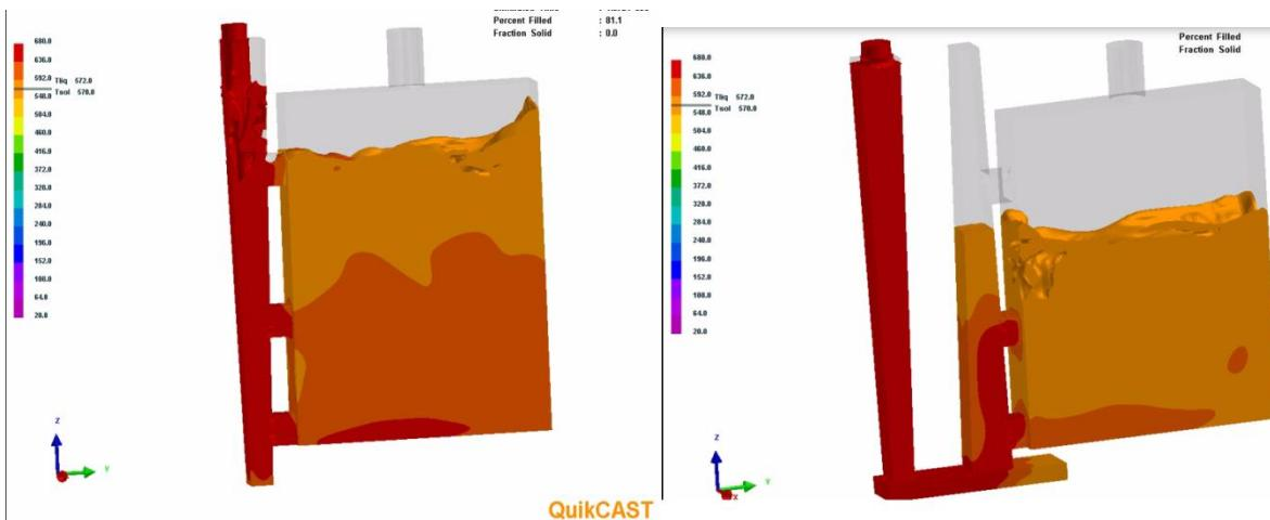
Slika 27: Prikaz punjenja kalupa za stepenasti uljevni sustav
