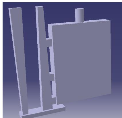
Slika 21: Stepenasti vertikalni uljevni sustav s ulijevanjem iz vertikalnog razvodnika
