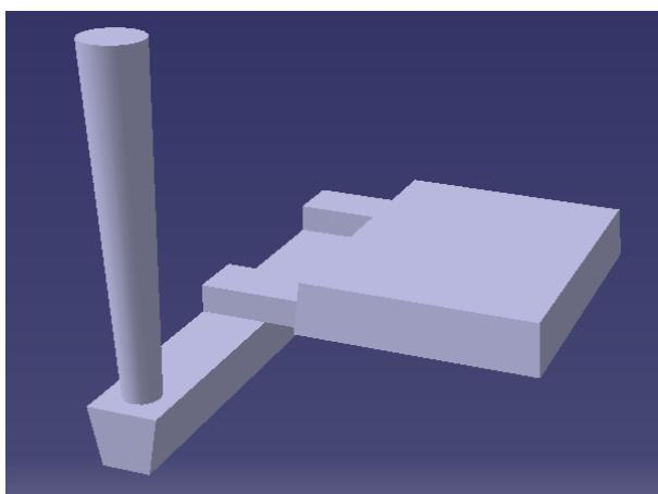
Slika 29: Horizontalni uljevni sustav s dva ušća
