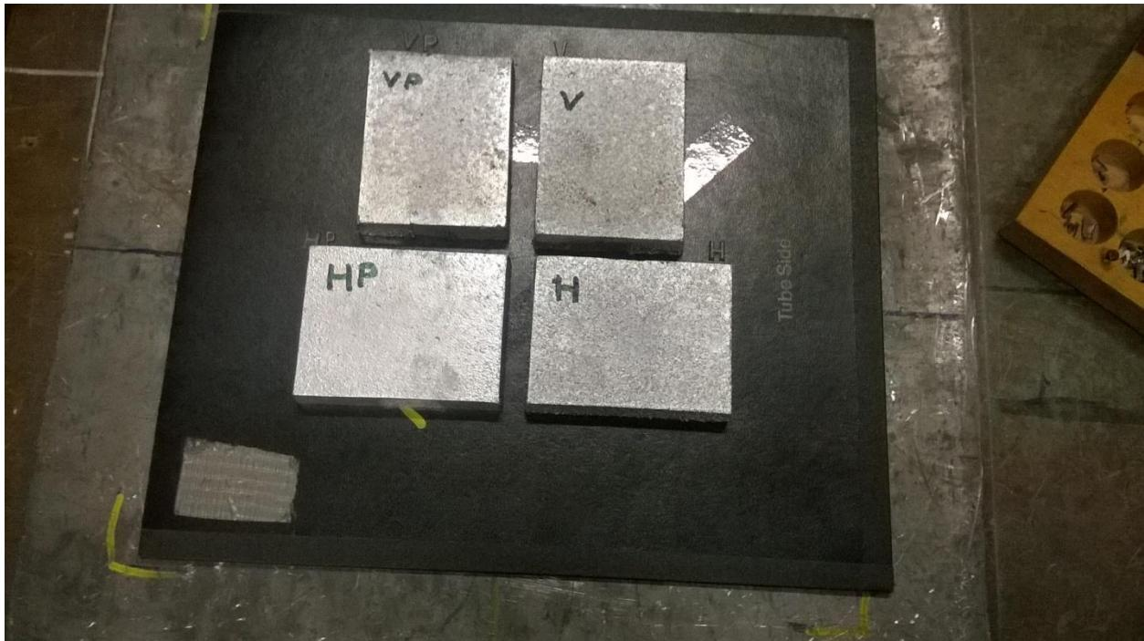
Slika 59: Prikaz odljevaka spremnih za radiografsko ispitivajne na rentgenu
