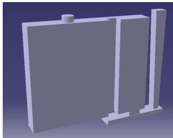
Slika 19: Vertikalni uljevni sustav sa ušćem odozdo – uljevanje preko pojila
