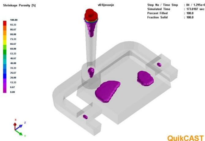
Slika 33: Poroznost u odljevcima s horizontalnim uljevnim sustavom s dva ušća smještenih s bočne strane odljevka
