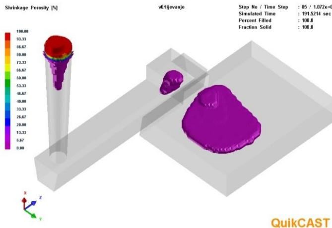
Slika 31: Poroznost u odljevcima s horizontalnim uljevnim sustavom s jednim ušćem
