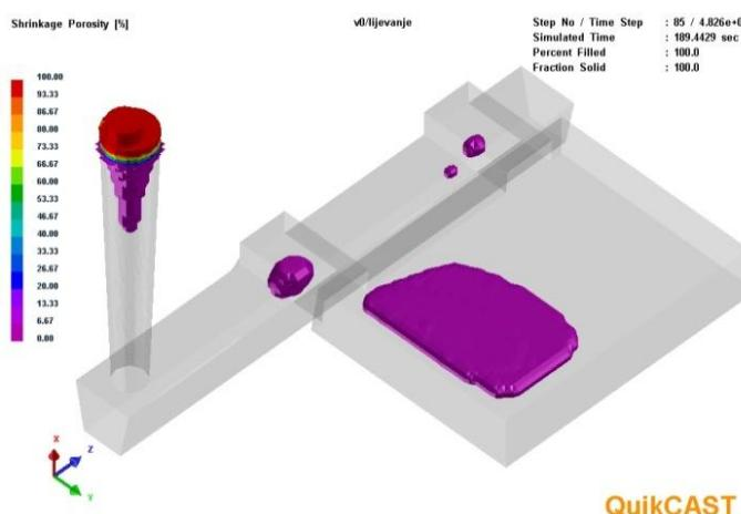
Slika 32: Poroznost u odljevcima s horizontalnim uljevnim sustavom s dva ušća
