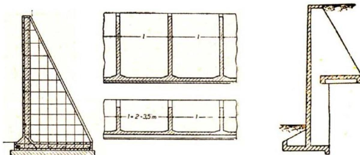
**Slika 29. Izvedba konzolno potpornih zidova s kontraforom [18]**
