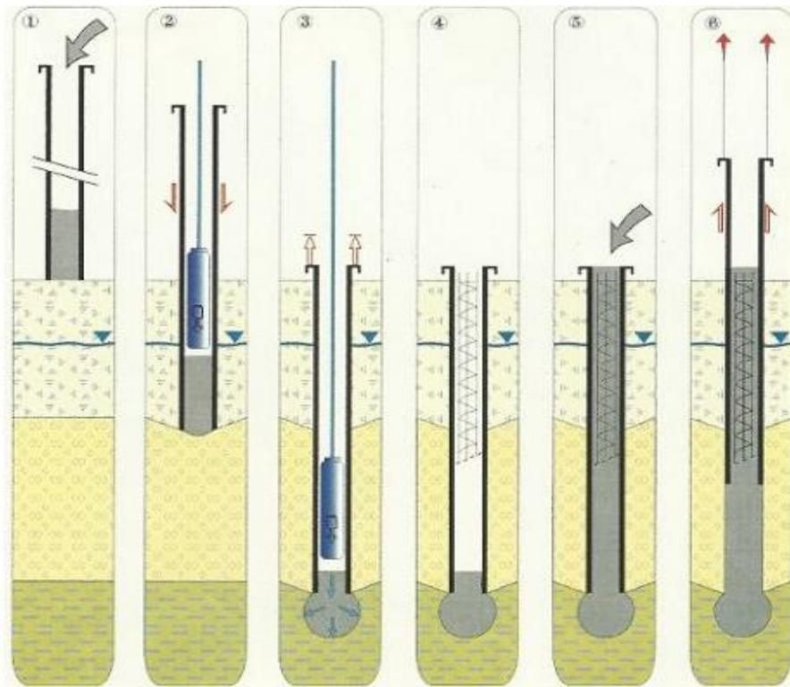
Slika 17. Sustav izgradnje Franki pilota [12]
