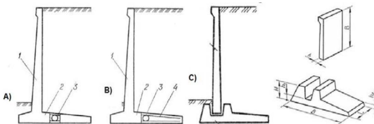
Slika 28. Izvedba konzolnih potpornih zidova [18]
