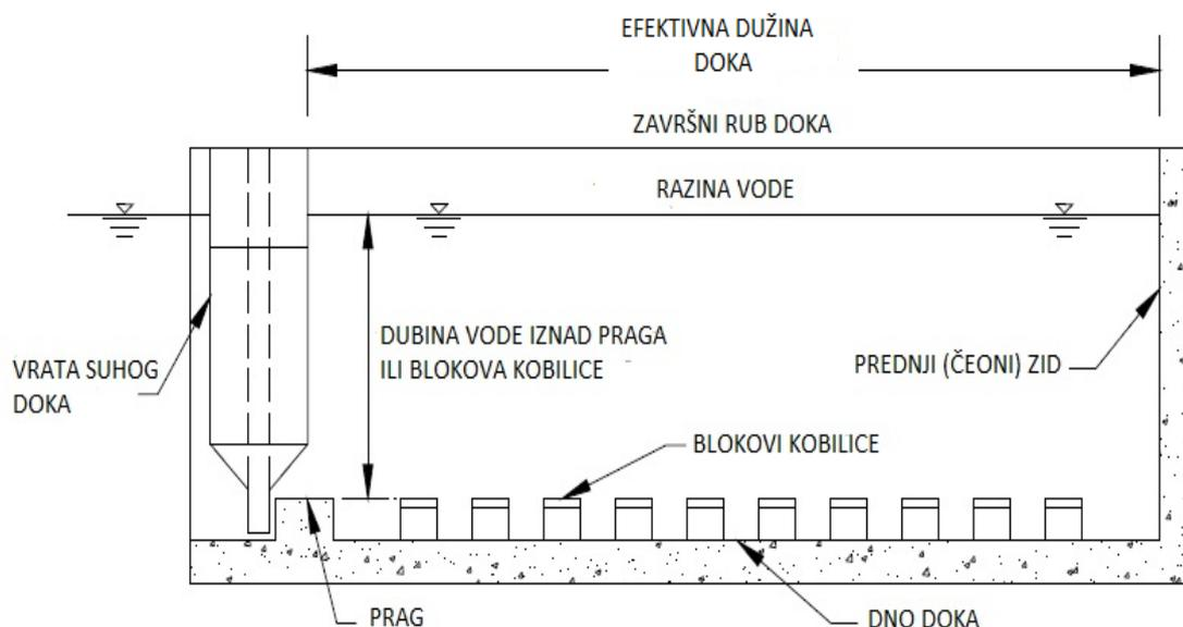
**Slika 7. Uzdužni presjek doka s elementima strukture [4]**
