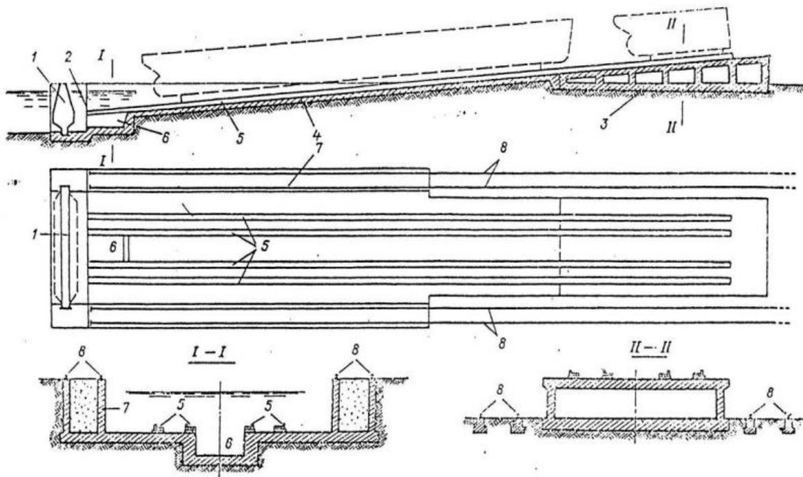
**Slika 1. Uzdužni navoz sa pripadajućim dijelovima [3]**
