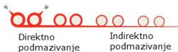
Slika 37. Razlika direktnog i indirektnog podmazivanja
