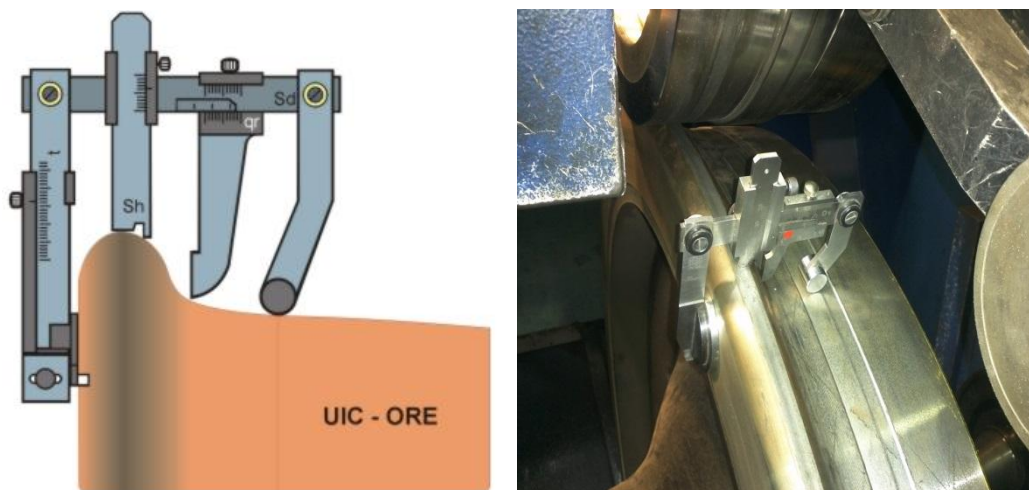
Slika 32. Mjerenje dimenzija profila kotača s punim i stisnutim vijencem pomoću mjerke
