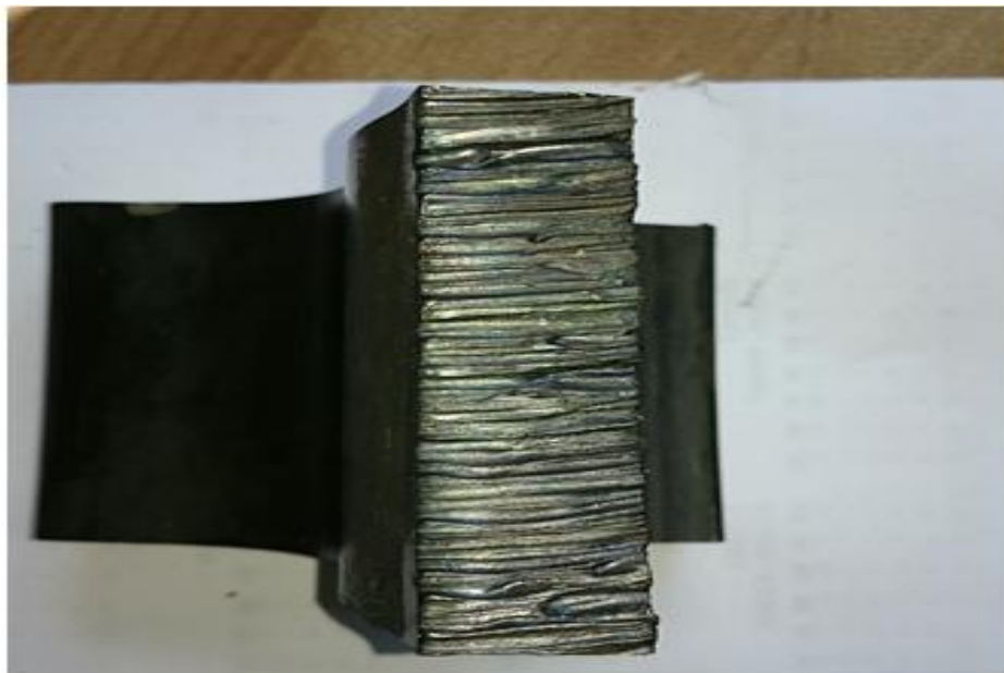
Slika 46. Deformacije monoblok kotača u području lista prilikom izrezivanja uzorka
