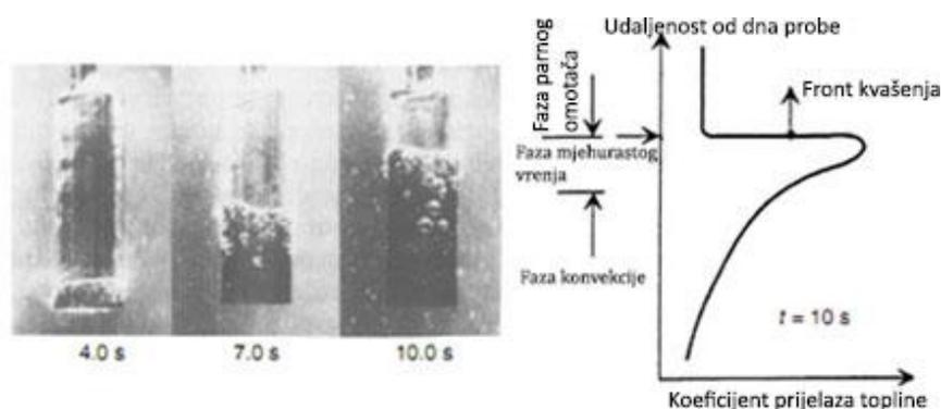
Slika 16. Napredovanje fronta kvašenja na čeličnom valjku [1]
