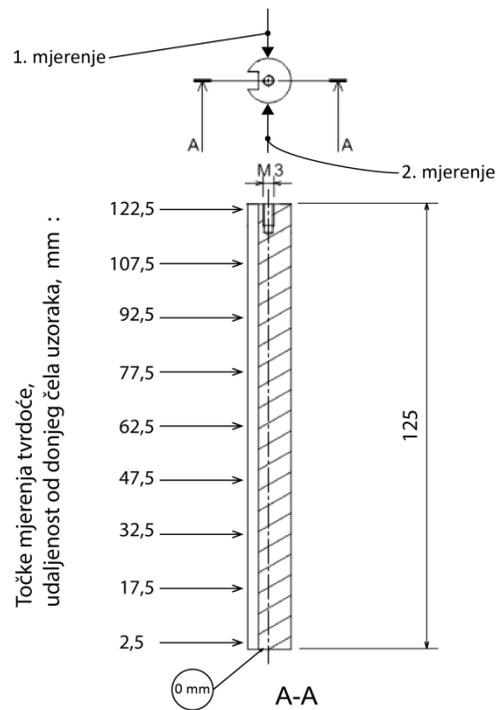
Slika 62. Točke mjerenja tvrdoće po duljini uzoraka
