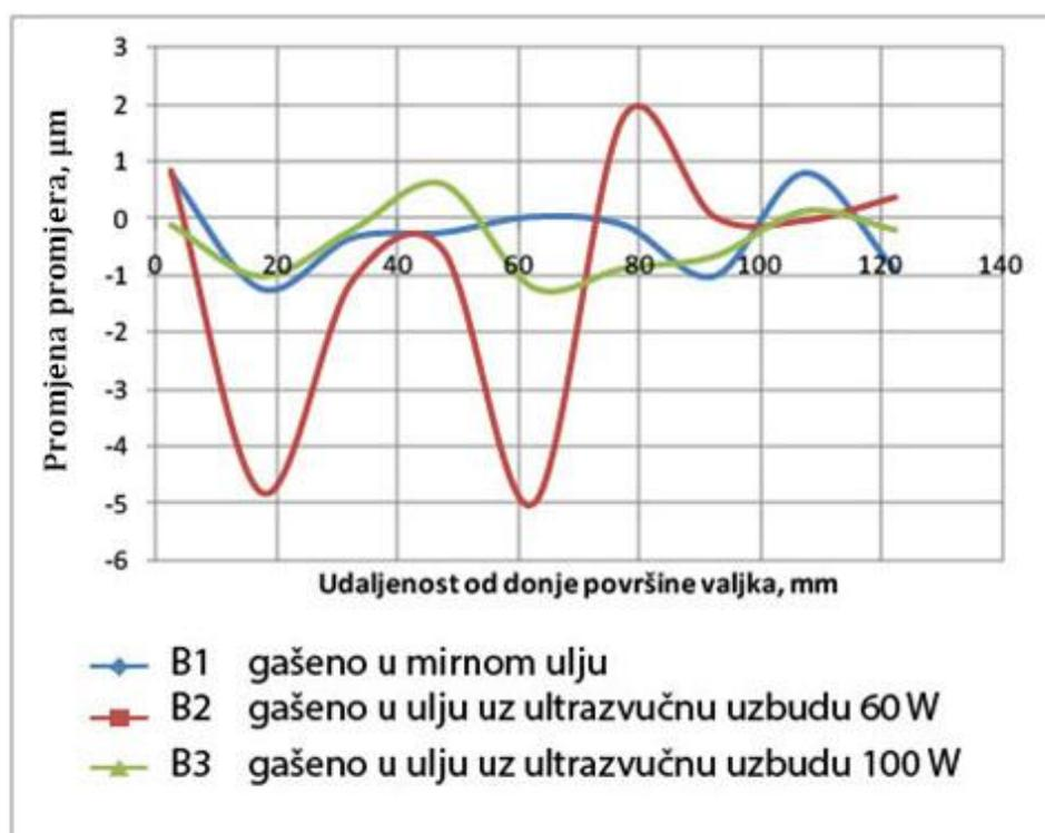
Slika 73. Promjena promjera po duljini valjaka od čelika C45E gašenih u ulju s i bez djelovanja ultrazvučne uzbude
