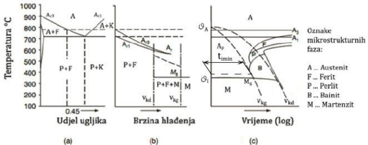
Slika 1. Utjecaj brzine hlađenja na fazne pretvorbe podeutektoidnog čelika [1]
