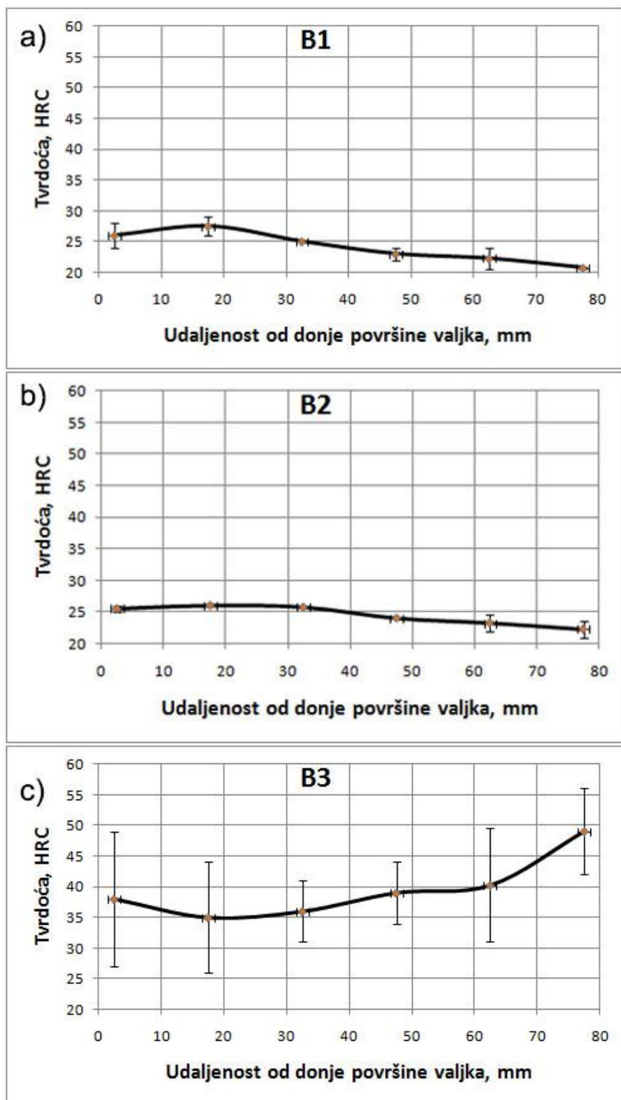
Slika 64. Raspodjela površinske tvrdoće ispitnih uzoraka od čelika C45E gašenih u ulju s i bez ultrazvučne uzbuđe:
