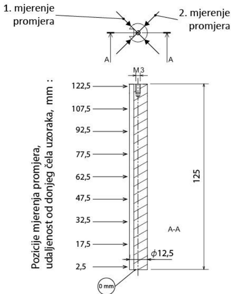
Slika 71. Pozicije mjerenja odstupanja od nazivnog promjera
