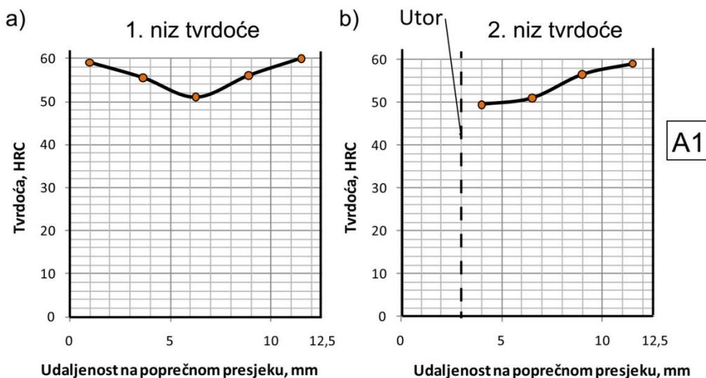
Slika 67. Raspodjela tvrdoća po poprečnom presjeku uzorka gašenog u mirnoj vodi
