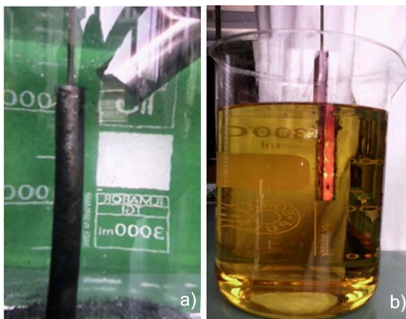
Slika 56. Gašenje obradaka u vodi i ulju za kaljenje
