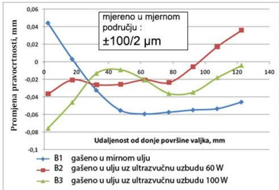
Slika 77. Promjena pravocrtnosti uzoraka od čelika C45E gašenih u ulju s i bez ultrazvučne uzbuđe
