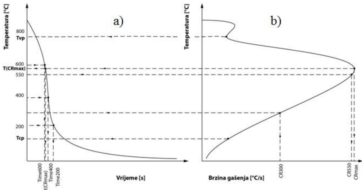
Slika 11. Osnovni parametri gašenja određeni s krivulje ohlađivanja
