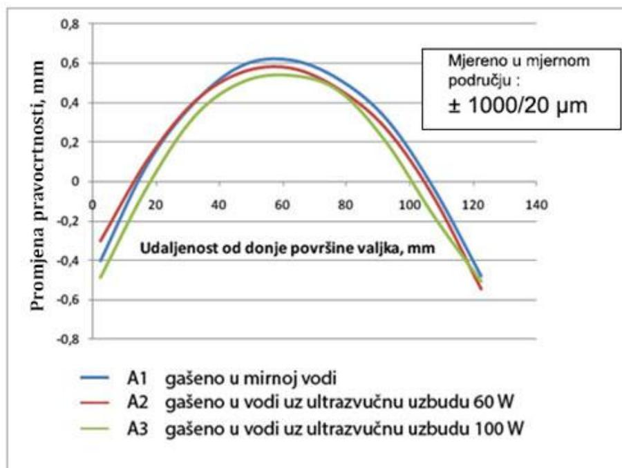
Slika 76. Promjena pravocrtnosti uzoraka od čelika C45E gašenih u vodi s i bez ultrazvučne uzbuđe
