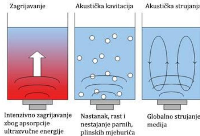
Slika 34. Efekti uslijed propagacije ultrazvuka kroz tekućinu [3]
