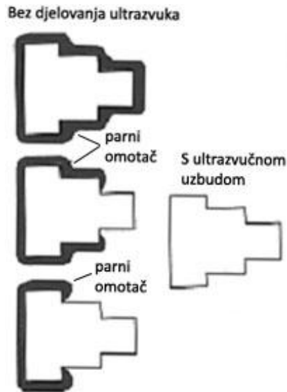
Slika 27. Shematski prikaz djelovanja ultrazvučne pobude na parni omotač [13]
