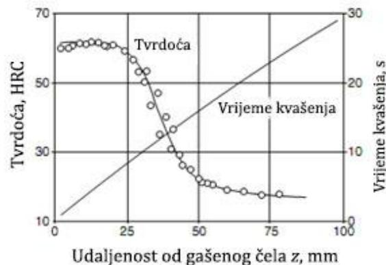
**Slika 18. Tvrdoća površine i vrijeme kvašenja kao funkcija udaljenosti od donjeg dijela čeličnog valjka\* [1]**
