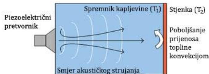
Slika 35. Poboljšanje prijenosa topline konvekcijom pomoću ultrazvučnih valova [3]
