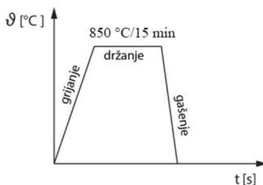
Slika 53. Dijagram postupka kaljenja obradaka od čelika C45E
