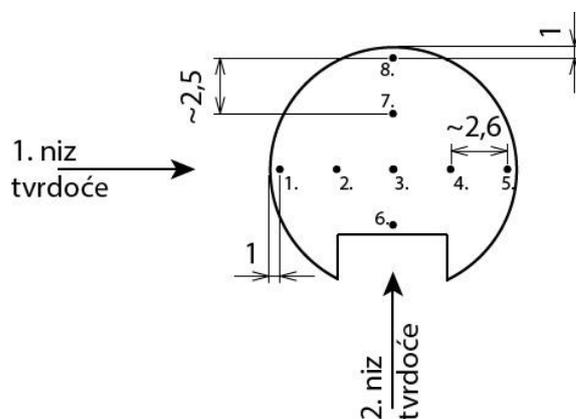
Slika 66. Točke mjerenja tvrdoće po poprečnom presjeku
