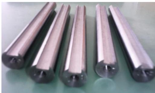
Slika 52. Obradci za ispitivanje deformacija
