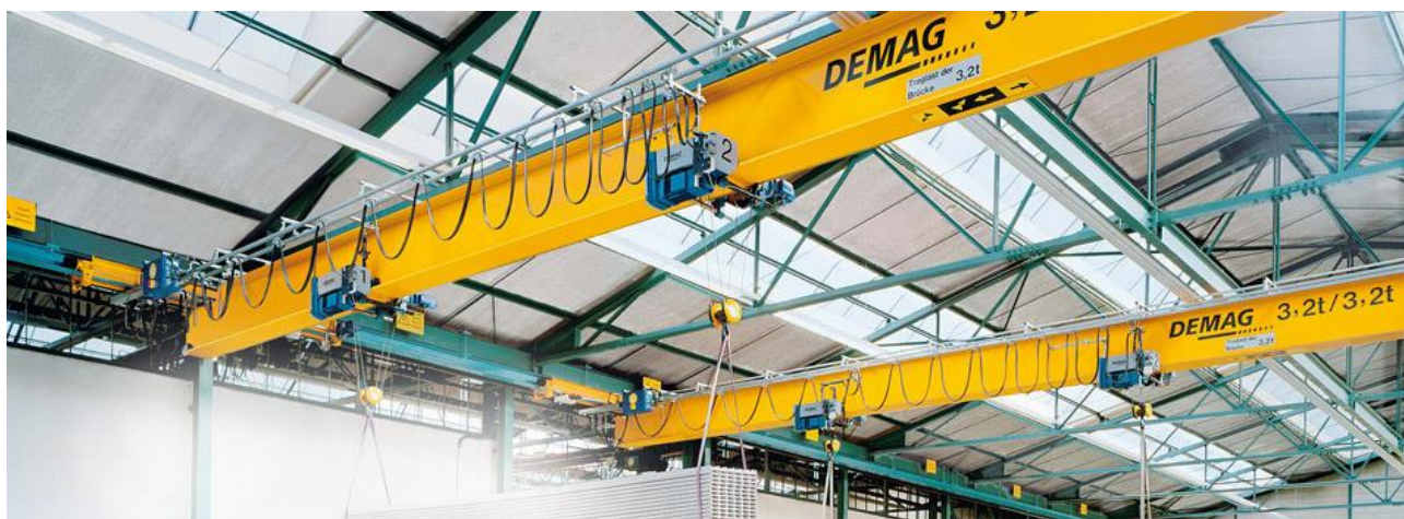
Slika 2.3. Mosni granik s jednim glavnim nosačem [11]
