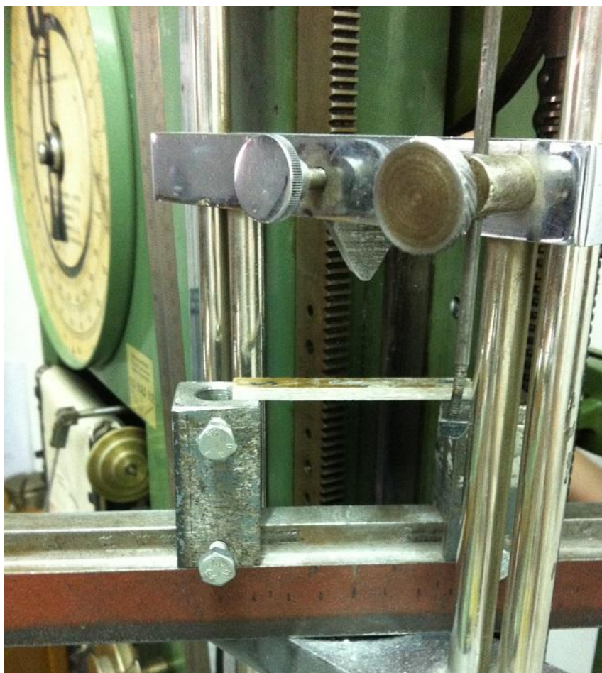
Slika 11. Ispitivanje savojne čvrstoće i savojnog modula elastičnosti na univerzalnoj kidalici
