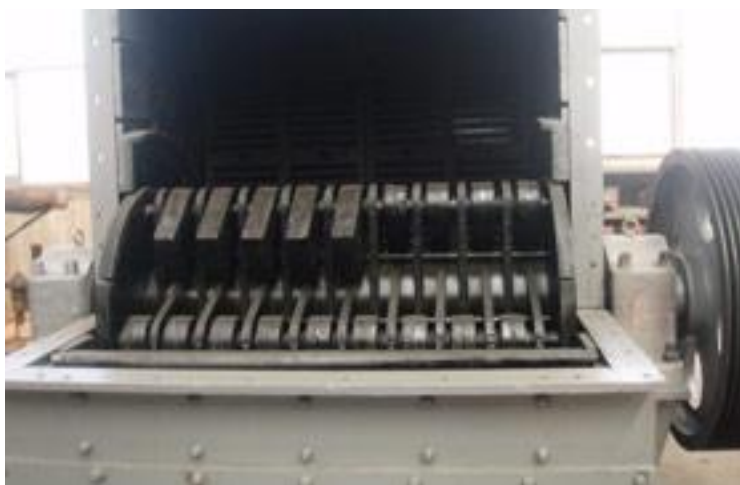
Slika 21. Čekići drobilice izloženi trošenju [16]
