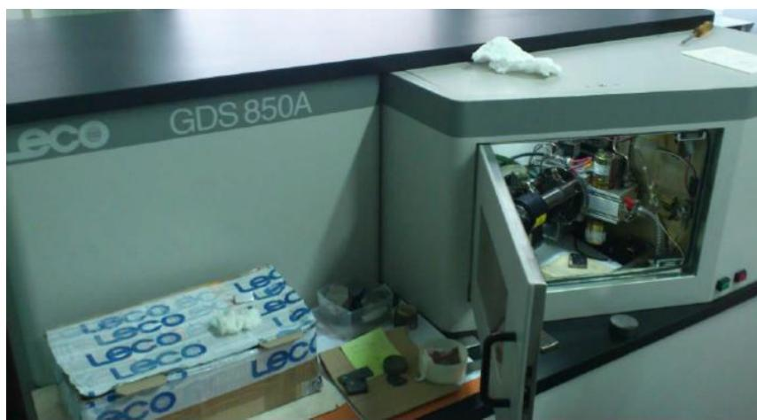
Slika 51. Optički emisijski spektrometar LECO GDS 850A
