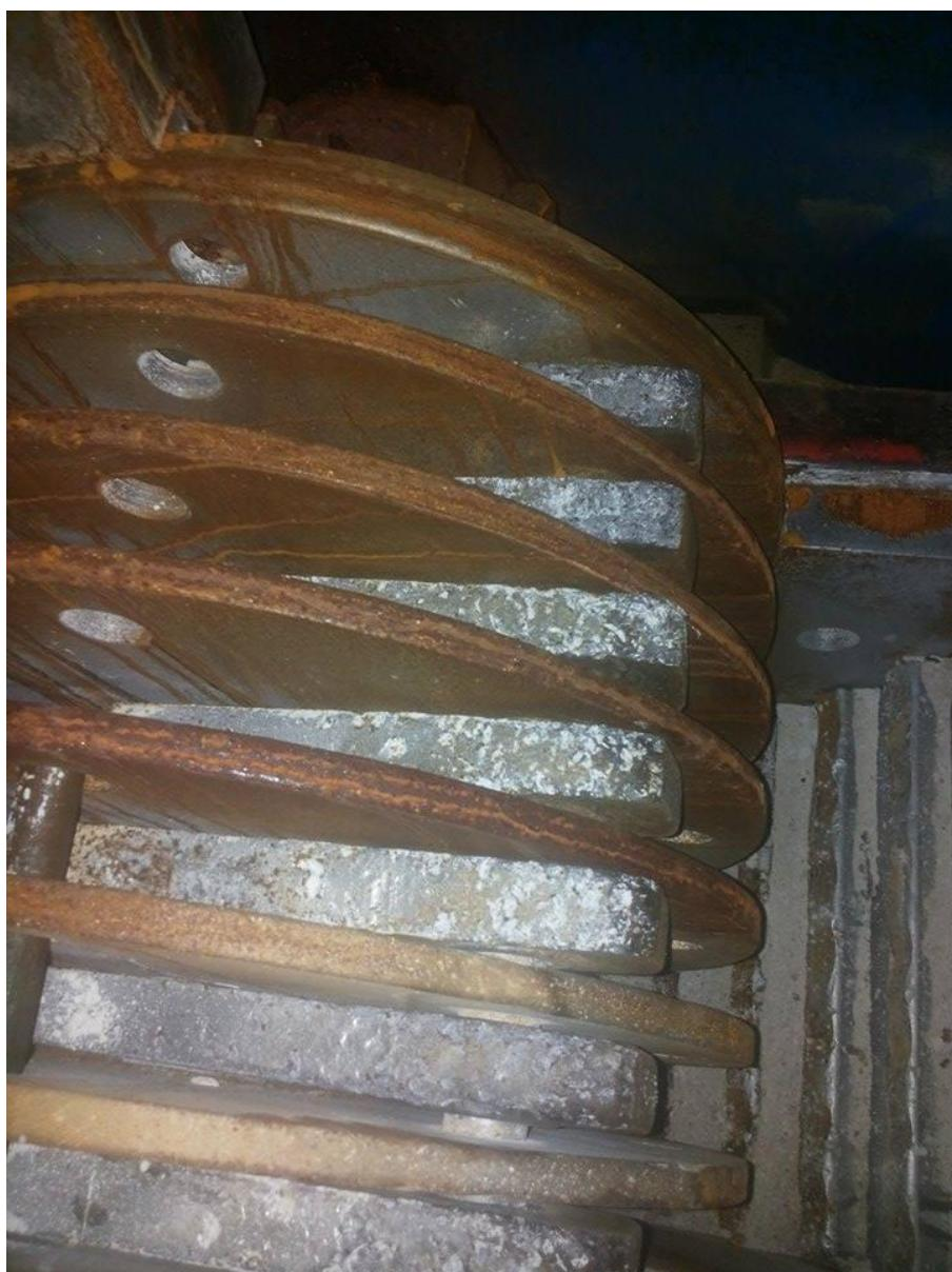
Slika 34. Čekići na rotoru i udarna pruga – elementi najizloženiji trošenju
