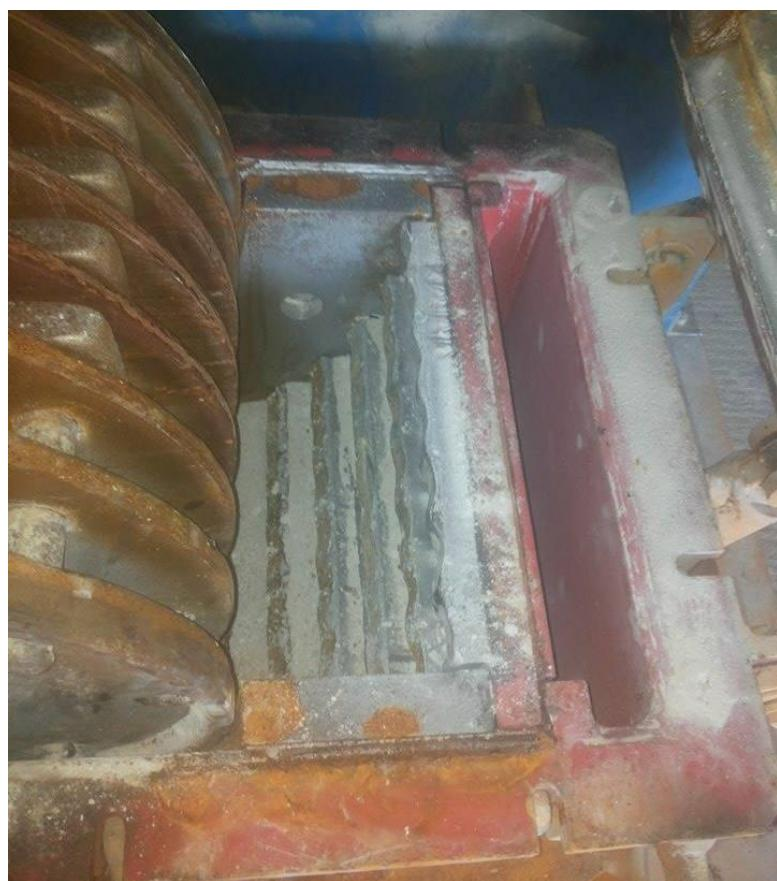
**Slika 46. Udarne oblage ispod rotora u kućištu mlina**
