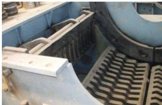
Slika 22. Udarne obloge drobilice izložene trošenju [17]
