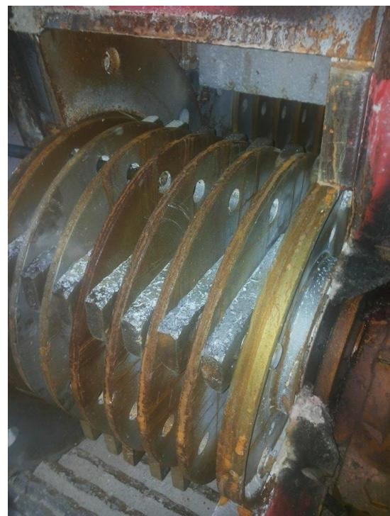
Slika 30. Rotor s čekićima i udarne obloge
