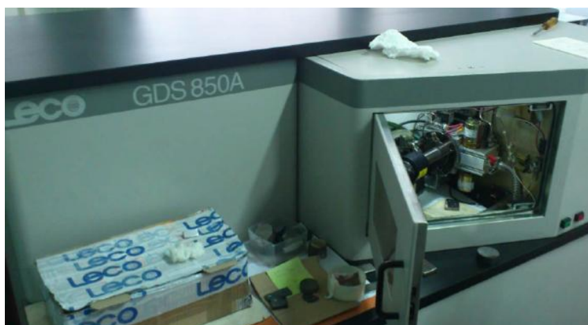
Slika 51. Optički emisijski spektrometar LECO GDS 850A
