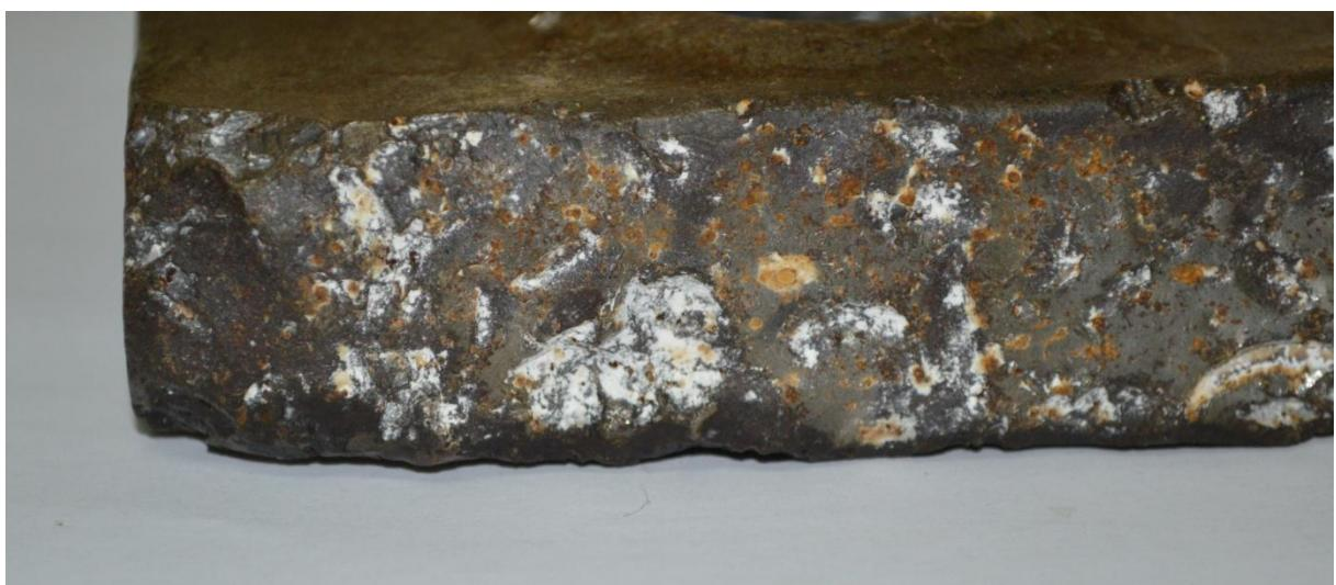
**Slika 45. Tragovi trošenja kidanjem materijala**
