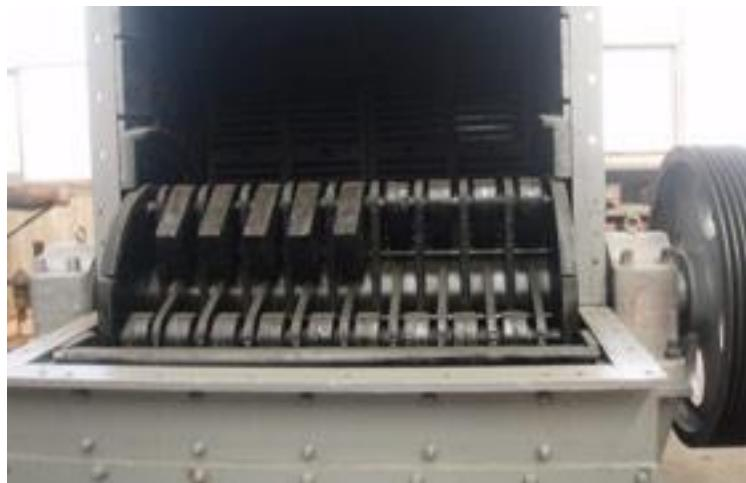
Slika 21. Čekići drobilice izloženi trošenju [16]
