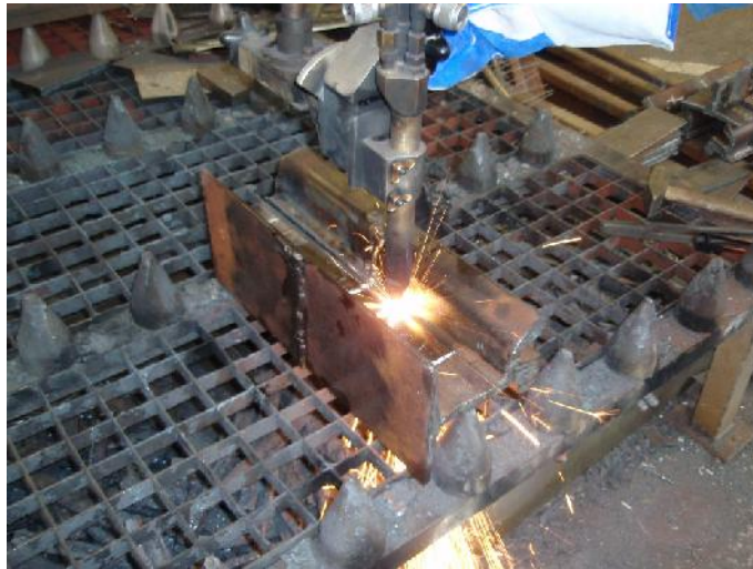
Slika 5.13. Rezanje uzoraka automatiziranim plinskim postupkom
