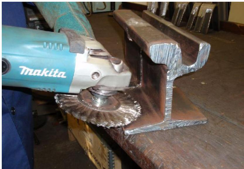
Slika 5.1. Dodatno mehaničkočišćenje uzoraka
