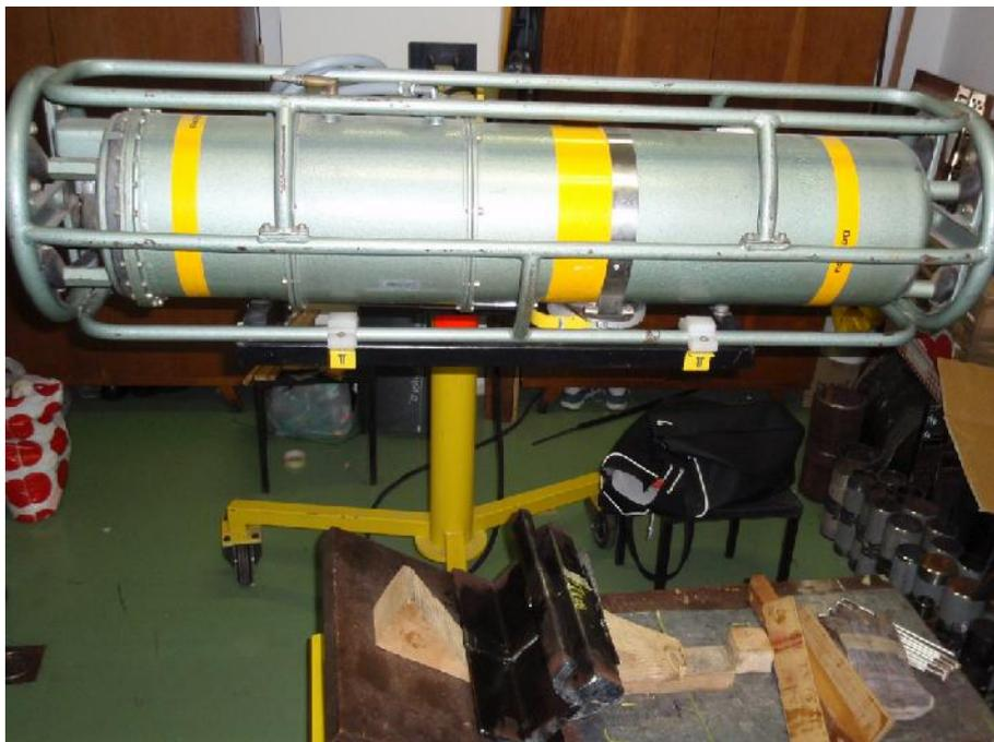
Slika 5.7. Radiografsko ispitivanje uzoraka
