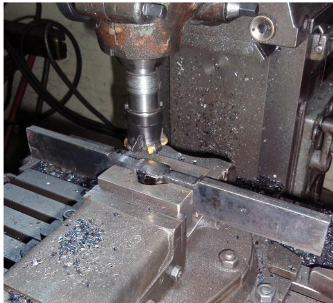
Slika 5.15. Glodanje epruvete za statički vlačni pokus
