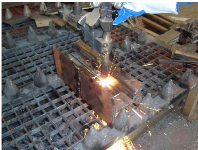
Slika 5.13. Rezanje uzoraka automatiziranim plinskim postupkom
