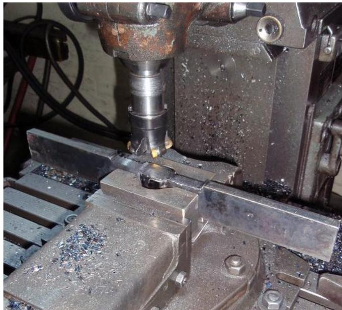
Slika 5.15. Glodanje epruvete za statički vlačni pokus
