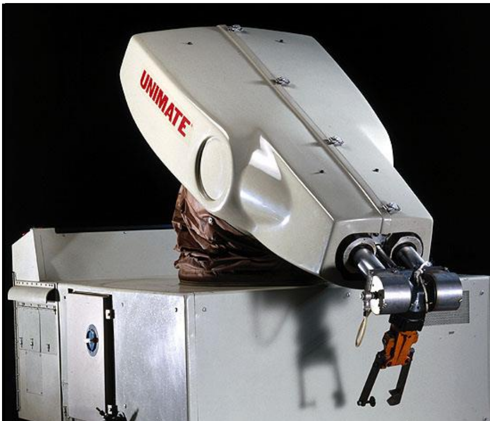
Slika 1. UNIMATE – prvi industrijski robot
