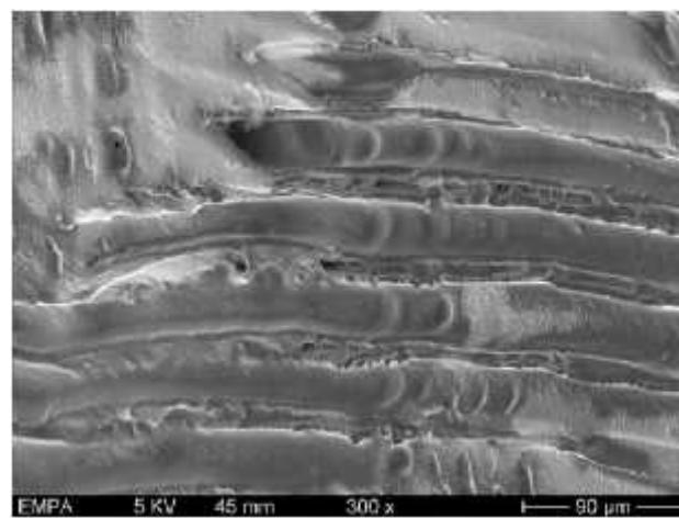
**Slika 14. Analiza elektronskom mikrosondom hidrofobnog premaza na drvu [10].**
