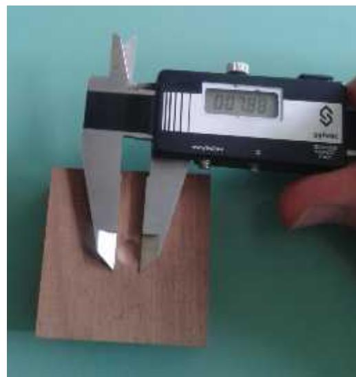
**Slika 31. Mjerjenje otiska kuglice digitalnim pomijerilom.**
