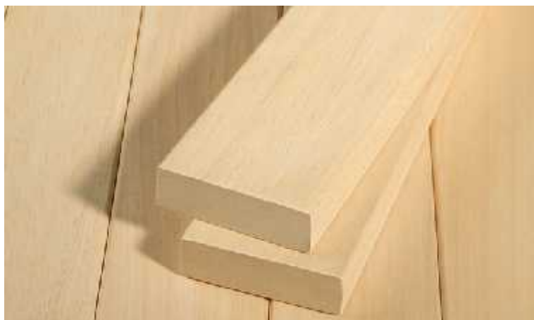
Slika 15. Izgled uzorka od drva abachi [35].
