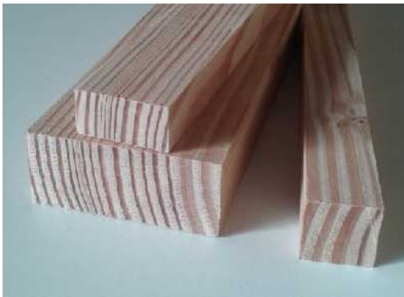
Slika 17. Izgled uzoraka od drva borovine [37].
