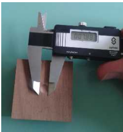
Slika 31. Mjerenje otiska kuglice digitalnim pomi nim mjerilom.
