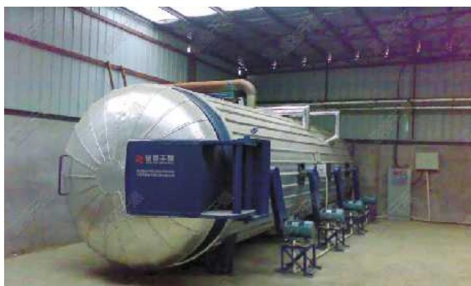
Slika 5. Komora za toplinsko modificiranje drva [14].
