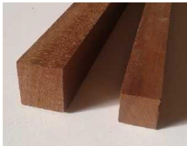
Slika 16. Izgled termotretiranog drva abachi [37].
