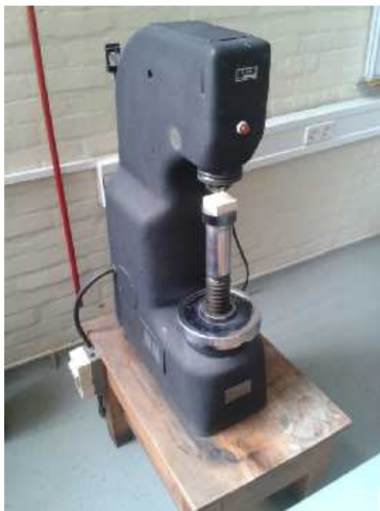
Slika 28. Postupak ispitivanja tvrdoće metodom po Brinell-u [37].
