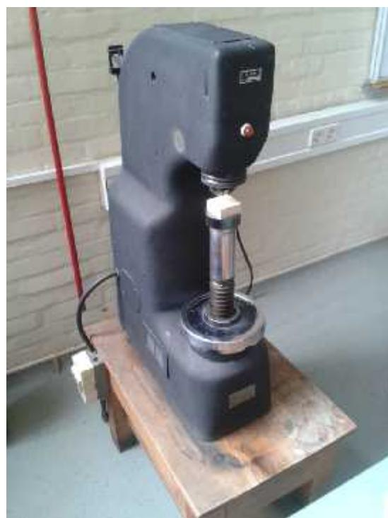
Slika 28. Postupak ispitivanja tvrdoće metodom po Brinell-u [37].
