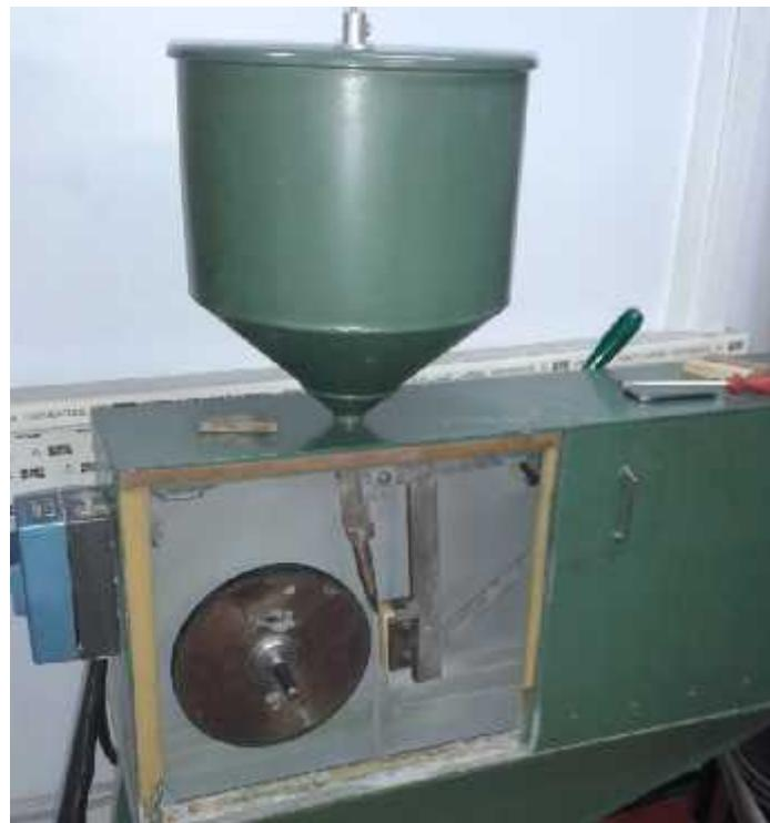
Slika 21. Uređaj za ispitivanje trošenja na abraziju [42].
