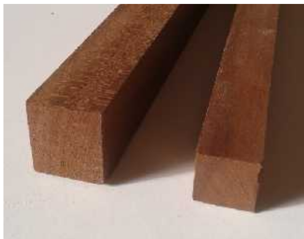
Slika 16. Izgled termotretiranog drva abachi [37].
