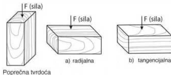
Slika 27. Mjerenje tvrdoće drva u odnosu na presjek [44].
