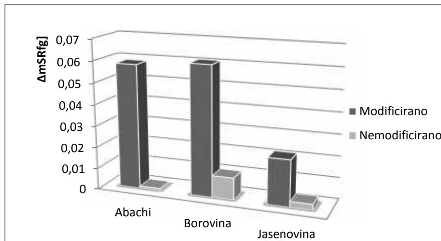
**Slika 25. Raspored trošenja modificiranih i nemodificiranih uzoraka.**
