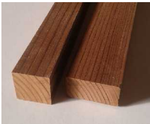
Slika 18. Izgled uzoraka od termotretirane borovine [37].
