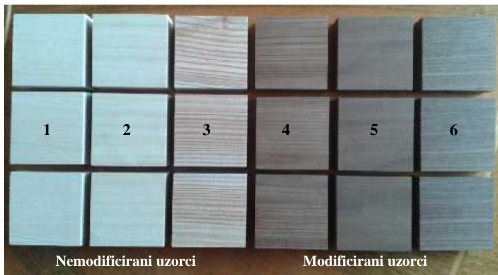
**Slika 30. Izgled uzoraka prije ispitivanja na tvrdo u po Brinell-u:**
