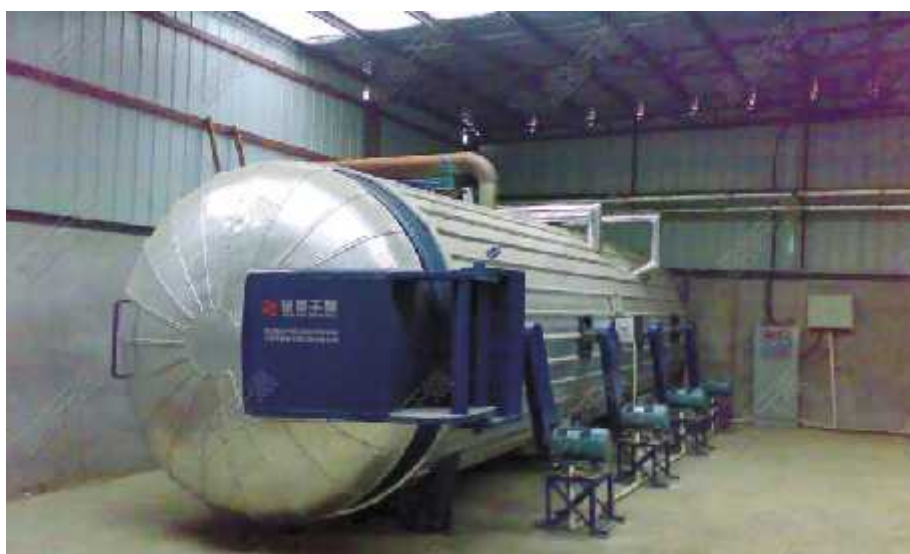
Slika 5. Komora za toplinsko modificiranje drva [14].
