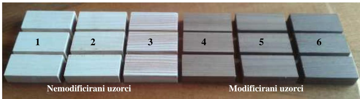
**Slika 24. Izgled uzoraka prije ispitivanja na abraziju:**
