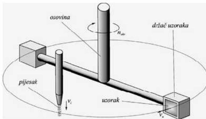
Slika 34. Shematski prikaz uređaja na erozijsko trošenje [45].
