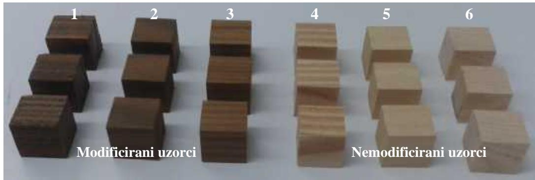
**Slika 39. Izgled uzorka prije ispitivanja na eroziju:**
