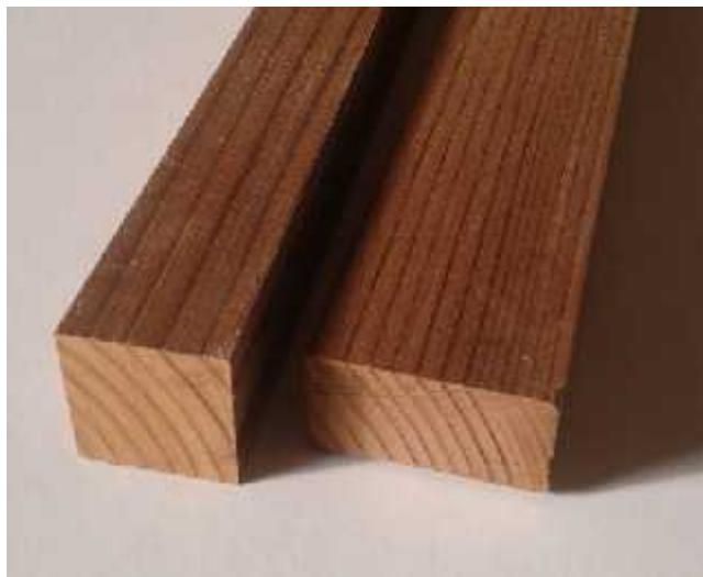
Slika 18. Izgled uzorka od termotretirane borovine [37].
