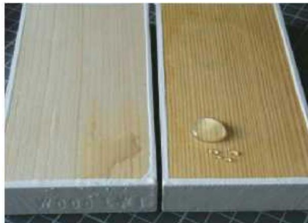
**Slika 13. Poveanje hidrofobnosti drva obra enog hidrofobnim imregnacijskim sredstvom (desno) u usporedbi s neobra enim drvom (lijevo) [10].**
