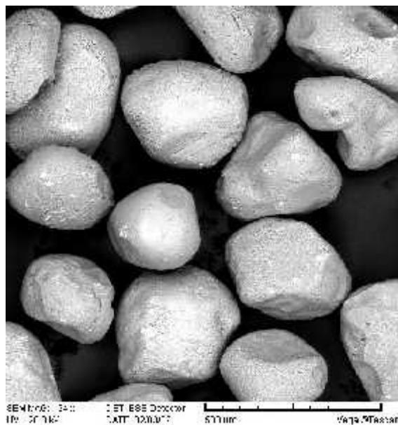
Slika 38. Estice erodenta  $\text{SiO}_2$  snimljene pretražnim elektronskim mikroskopom [45].
