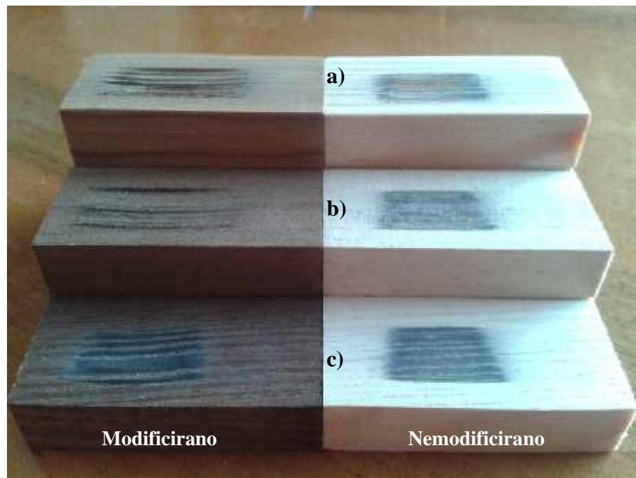
**Slika 26. Izgled uzoraka nakon ispitivanja na abraziju:**
