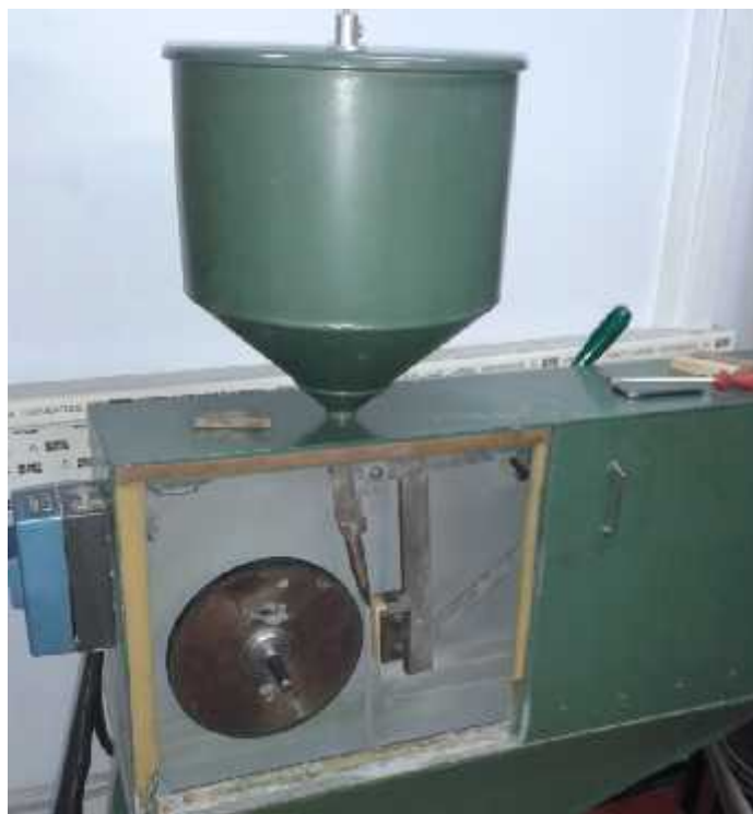
Slika 21. Uređaj za ispitivanje trošenja na abraziju [42].
