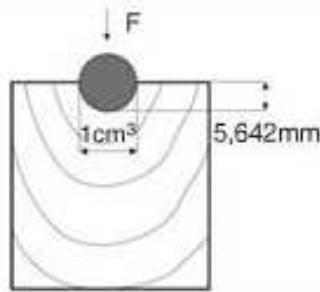
Slika 29. Postupak ispitivanja tvrdoće metodom janka [44]
