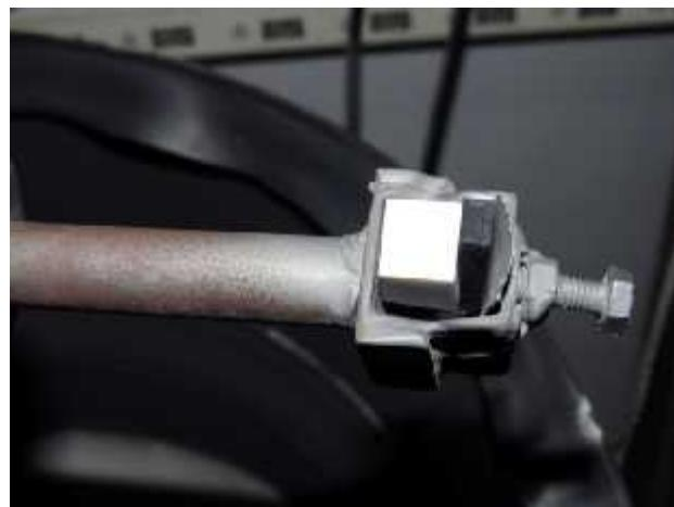
Slika 37. Uzorak na držaču ure aja za ispitivanje otpornosti na erozijsko trošenje [45].
