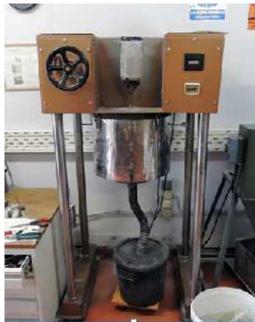
**Slika 35. Uređaj za ispitivanje otpornosti na erozijsko trošenje [45].**
