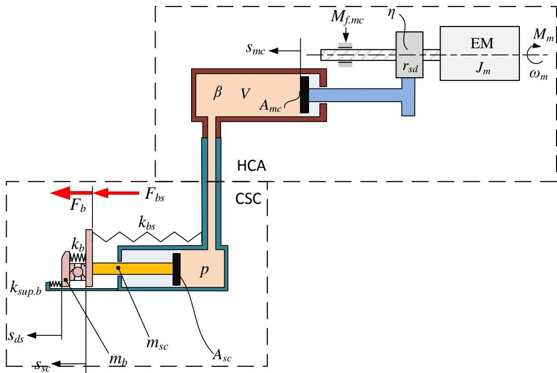
Slika 7. Shematski prikaz aktuatororskog sustava
