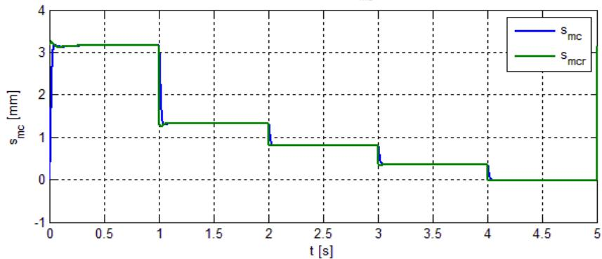
Slika 50. Odzivi pozicija klipova pogonskog i radnog cilindra na promjenjivu odskočnu referencu normalne sile
