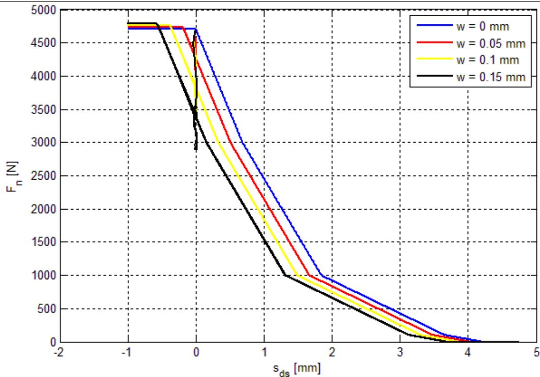
Slika 30.  $F_n(s_{sc})$  karakteristika za različite progresivne stupnjeve trošenja
