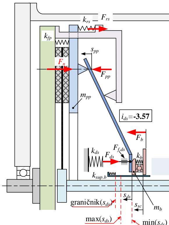
Slika 14. Shema spojke i aktuatora s ogledom sustava
