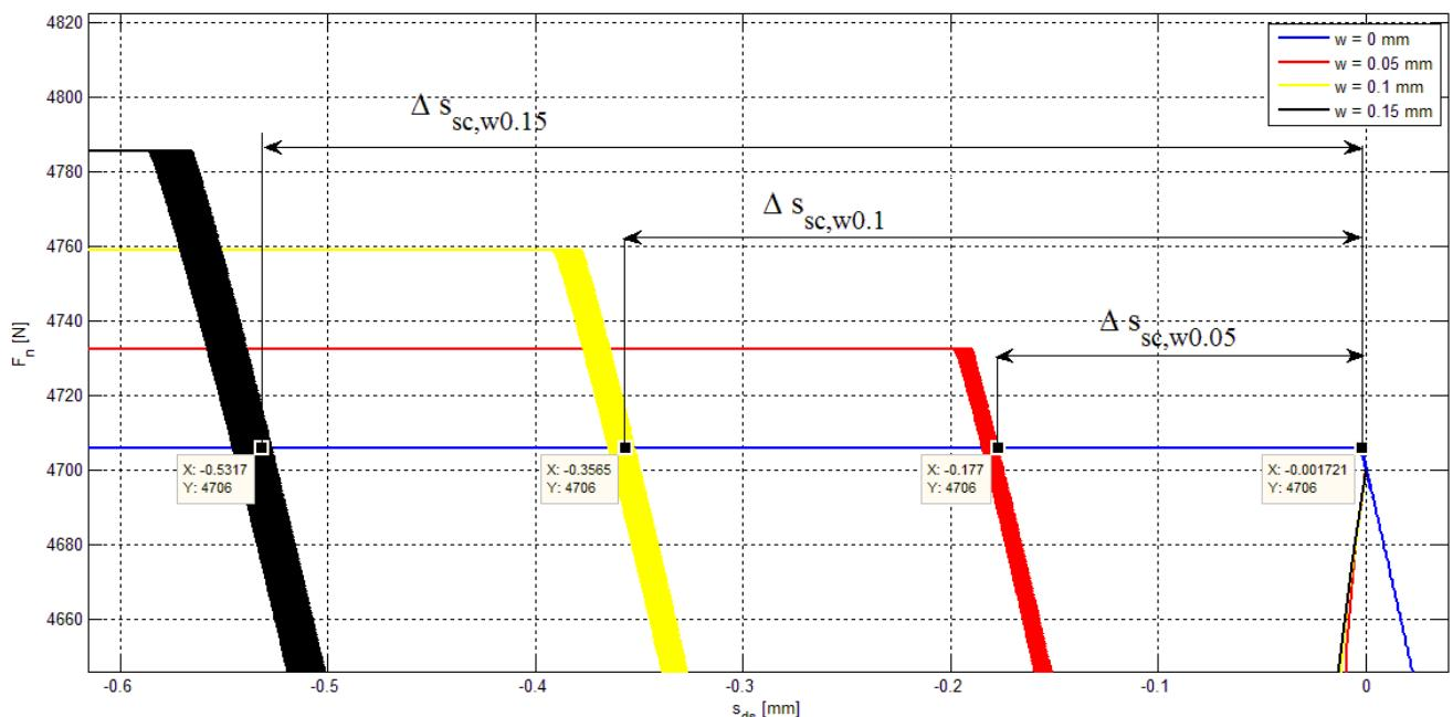
**Slika 34. Ilustracija kompenzacijskih hodova klipa radnog cilindra u slučaju različitih stupnjeva trošenja da bi se postigla normalna sila jednaka maksimalnoj normalnoj sili u nominalnom slučaju bez trošenja**
