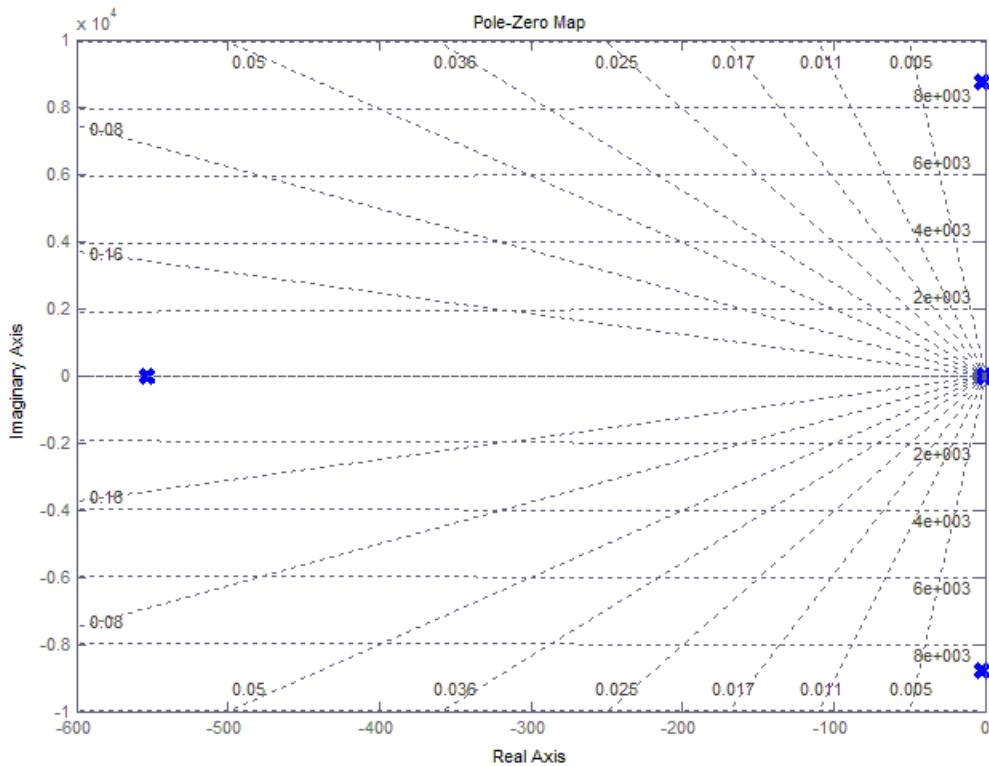
**Slika 12. Polovi prijenosne funkcije  $G_p(s) = s_{mc}(s)/i(s)$  potpunog dinamičkog modela aktuatororskog sustava**
