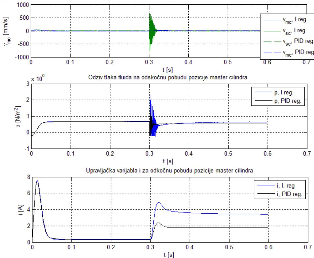
**Slika 48. Odzivi brzina klipova cilindra na odskočnu pobudu pozicije radnog cilindra s udarnim opterećenjem u  $t = 0.25$  s u slučaju kaskadne strukture s nadređenim I regulatorom i u slučaju samo PID regulatora**
