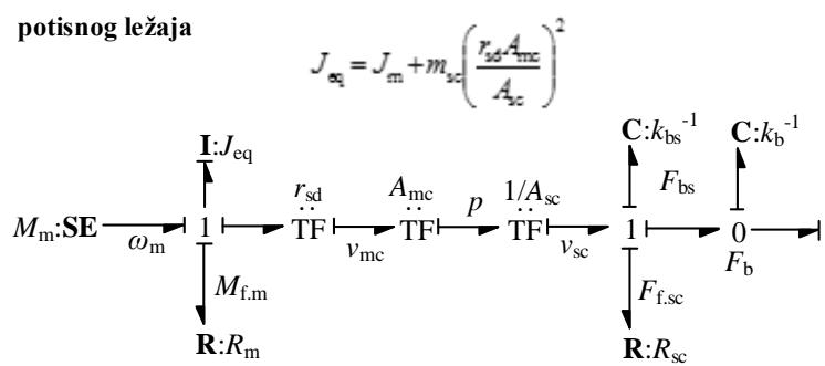
Slika 8. Vezni dijagram lineariziranog aktuatororskog sustava a) i pojednostavljenog aktuatororskog sustava
