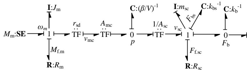
b) Vezni dijagram lineariziranog pojednostavljenog aktuatororskog sustava i potisnog ležaja
