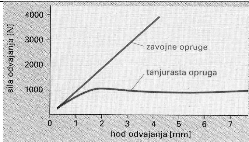
Slika 4. Karakteristika sile odvajanja na papuči spojke [1]
