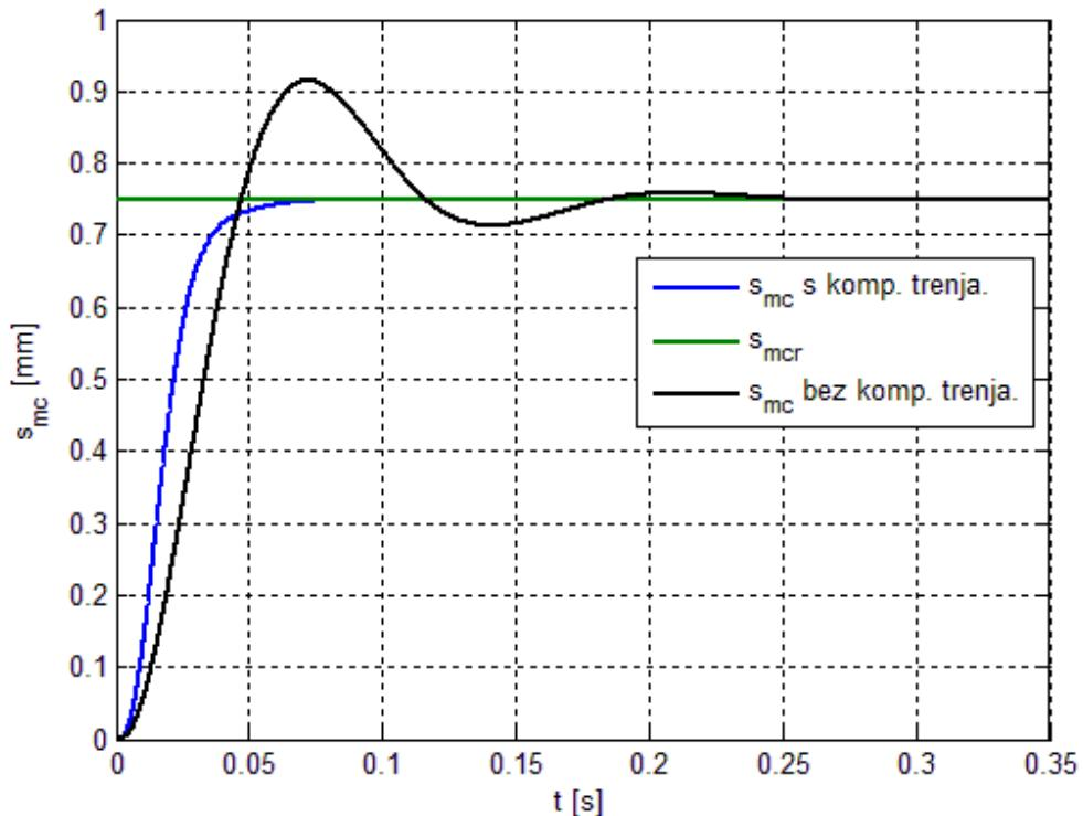
Slika 43. Nadvišenje pozicije pogonskog cilindra uzrokovane velikim trenjem
