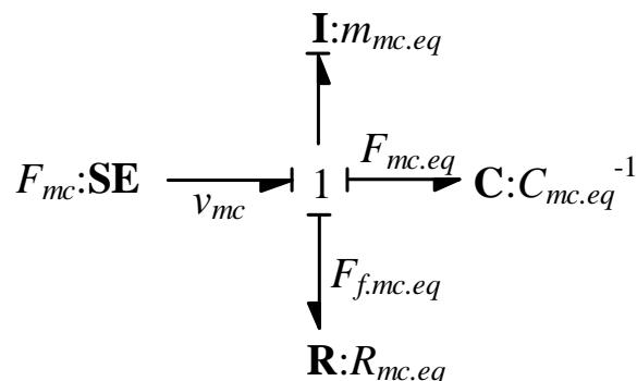
**Slika 11. Vezni dijagram reduciranog dinamičkog modela aktuatororskog sustava na stranu pogonskog cilindra**
