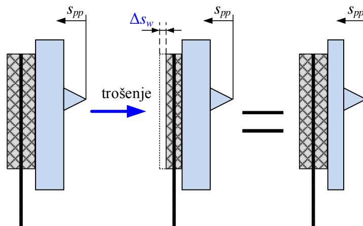
Slika 19. Shema trošenja spojke i pojednostavljenje modela trošenja
