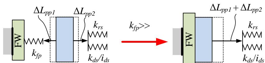
Slika 18. Shema pojednostavljenog modela toplinskog širenja spojke
