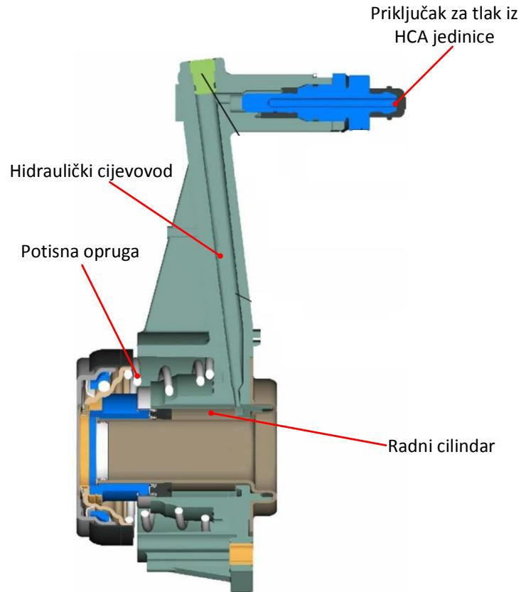
Slika 6. Koncentrični radni cilindar za otpuštanje spojke [6]
