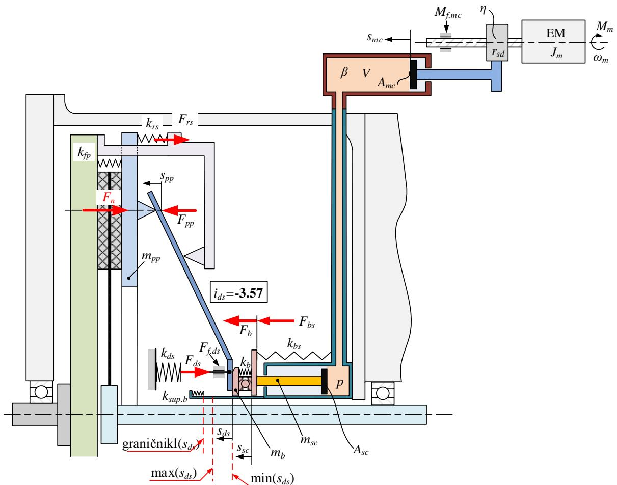
Slika 23. Funkcionalna shema cjelokupne e-spojke namijenjena modeliranju
