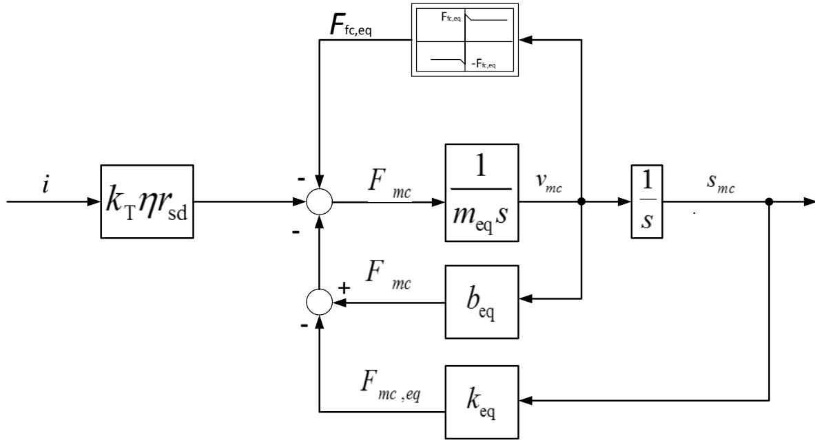
**Slika 10. Blokovski dijagram reduciranog dinamičkog aktuatororskog sustava na strani pogonskog cilindra**
