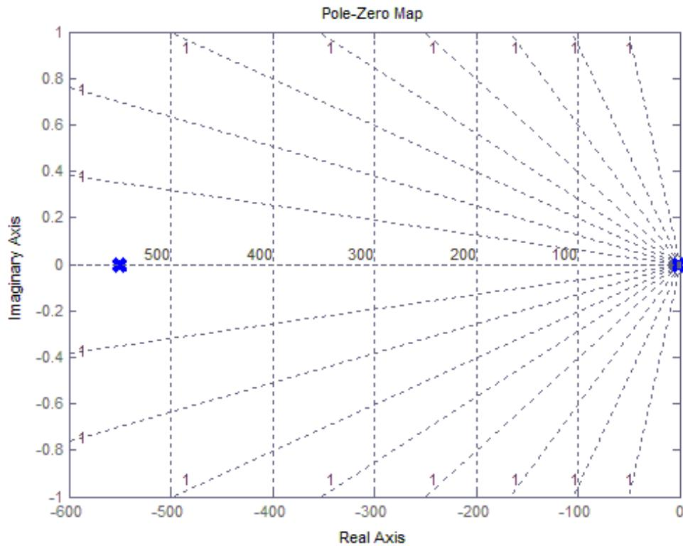
**Slika 13. Polovi prijenosne funkcije  $G_p(s) = s_{mc}(s)/i(s)$  reduciranoj dinamičkoj modela aktuatororskog sustava**
