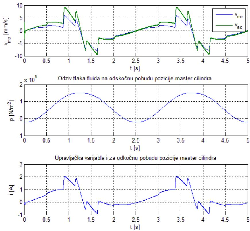
Slika 54. Odzivi brzina klipova, tlaka fluida i struje DC motora na sinusnu pobudu
