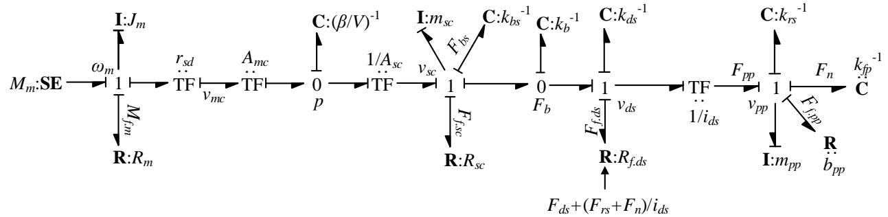
Slika 21. Vezni dijagram cijelokupne e-spojke
