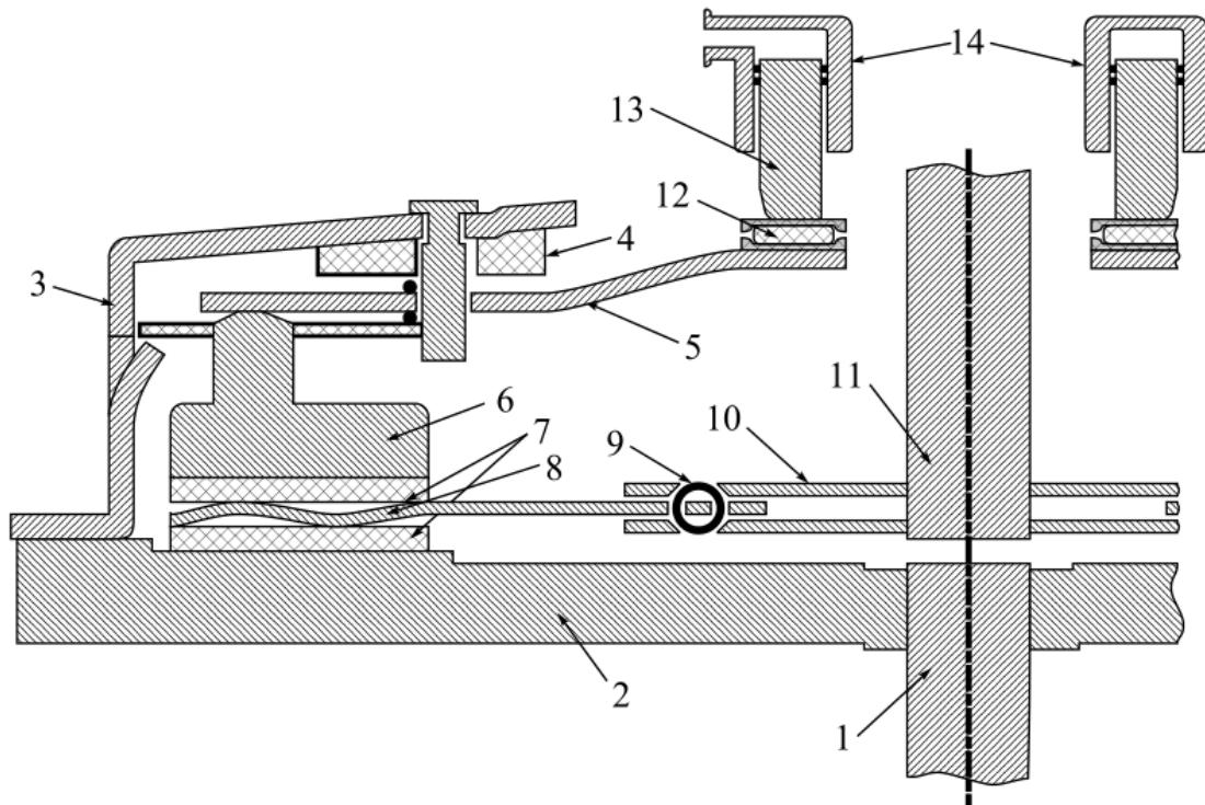
Slika 2. Strukturna shema suhe spojke s tanjurastom oprugom [3]
