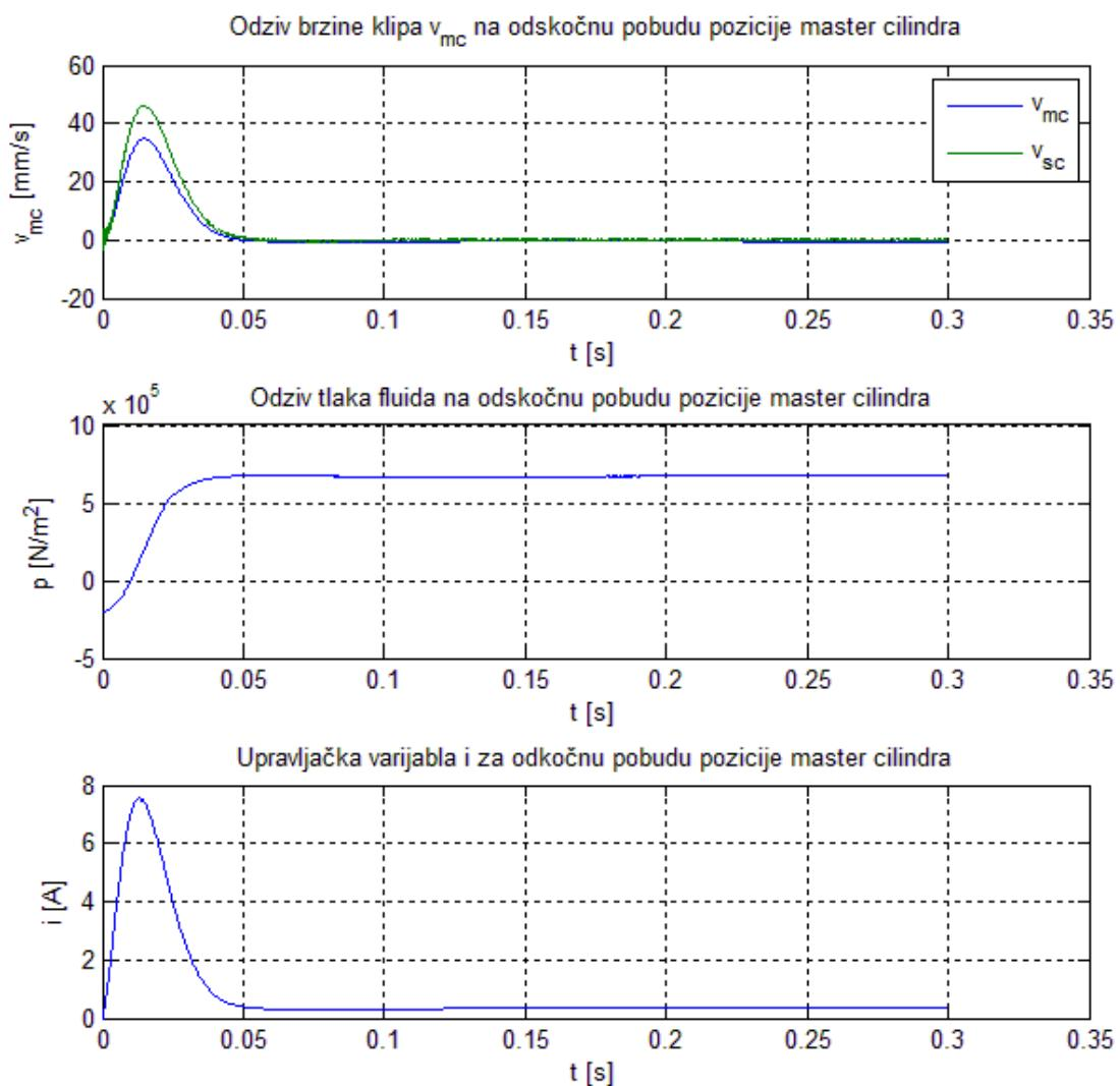
**Slika 46. Odzivi brzine radnog i pogonskog klip, tlaka fluida i struje na odskočnu pobudu pozicije klipa radnog cilindra**
