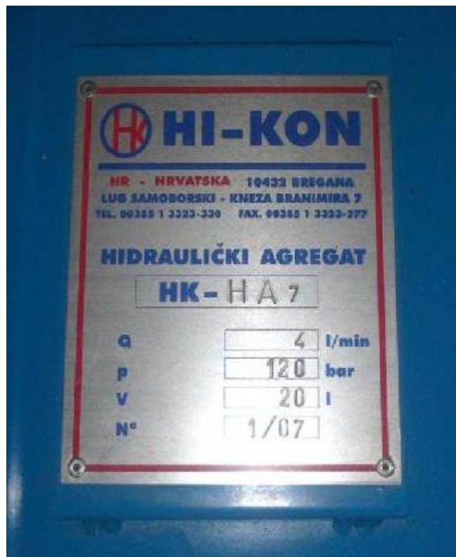
**Slika 2.2 Pločica sa hidrauličkog agregata s važnim karakteristikama**
