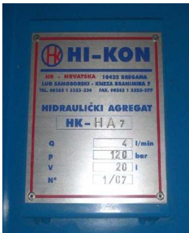
Slika 2.2 Pločica sa hidrauličkog agregata s važnim karakteristikama
