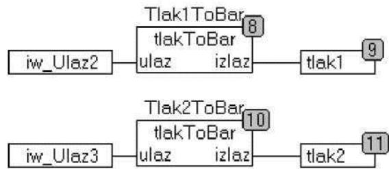
Slika 6.7 Obrada signala tlaka
