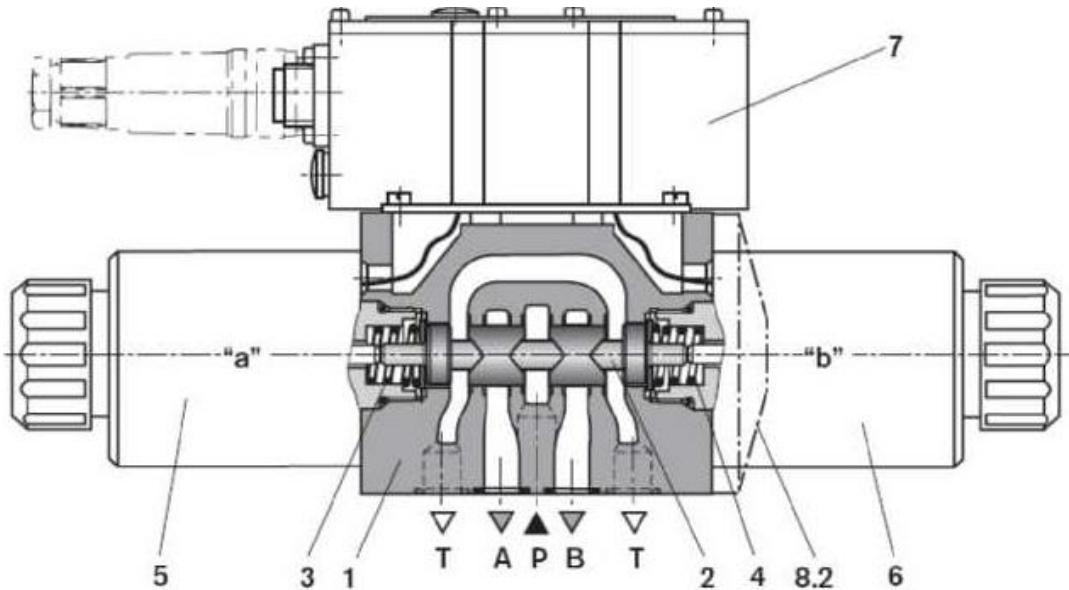
Slika 2.5 Presjek proporcionalnog ventila te njegovi dijelovi
