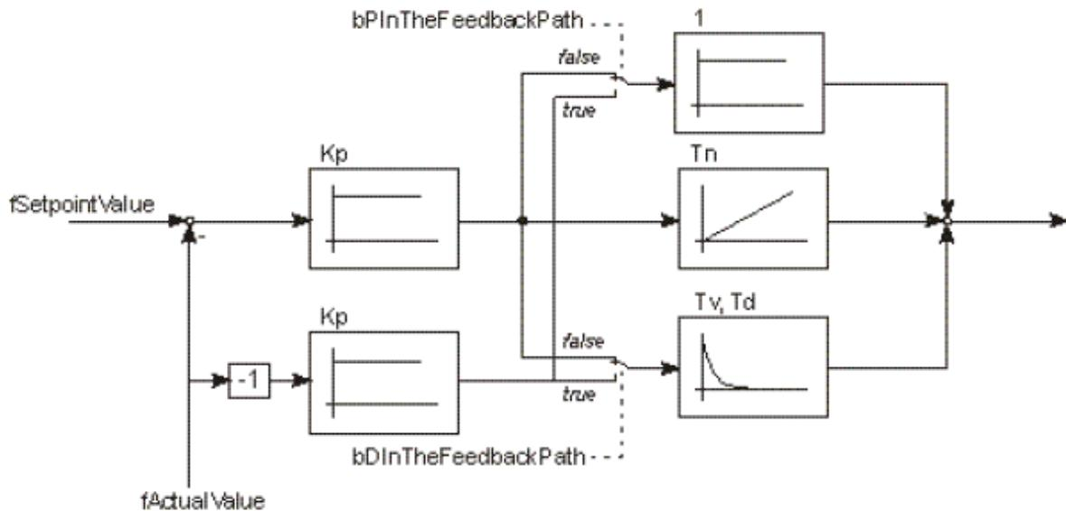
**Slika 6.3 Struktura PID regulatora u PLC Controlu**
