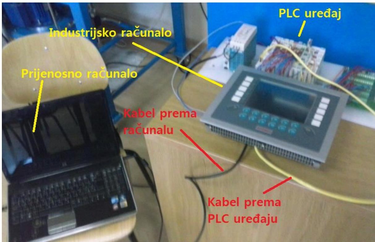
Slika 4.10 Spajanje PC-a, PLC-a i prijenosnog računala
