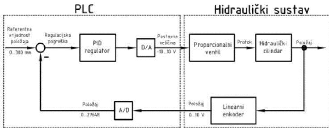
Slika 6.1 Blok shema regulacijskog kruga elektrohidrauličkog sustava
