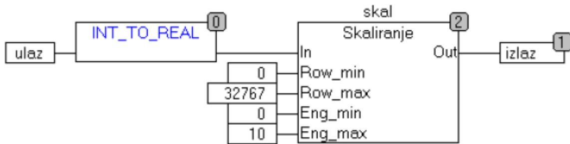
Slika 6.5 Skaliranje signala
