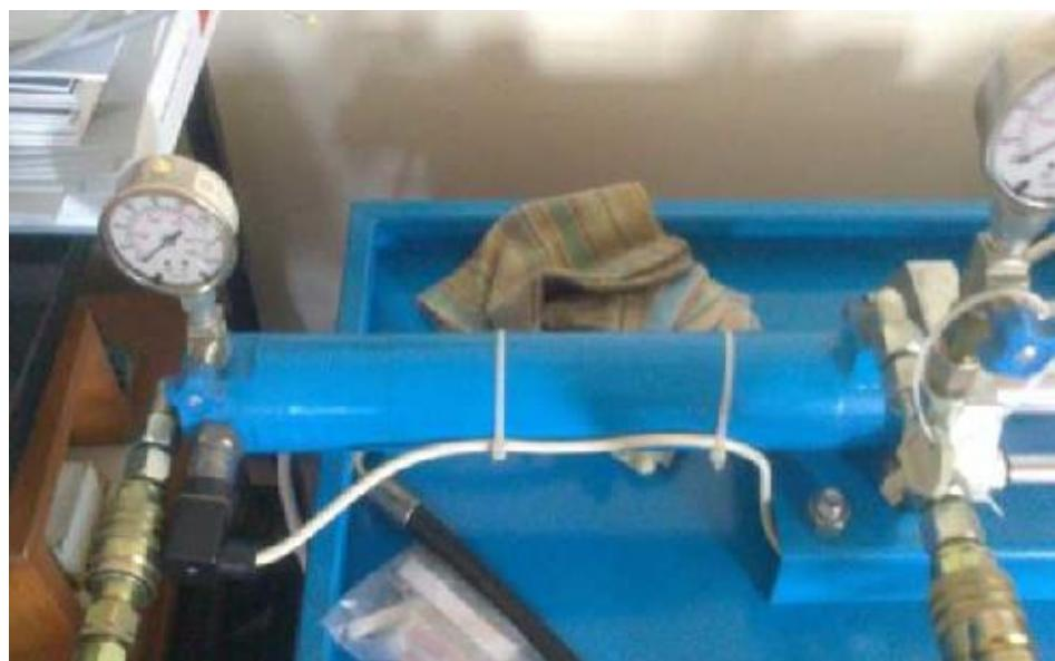
Slika 2.7 *Pogonski dvoradni cilindar na laboratorijskom postavu*
