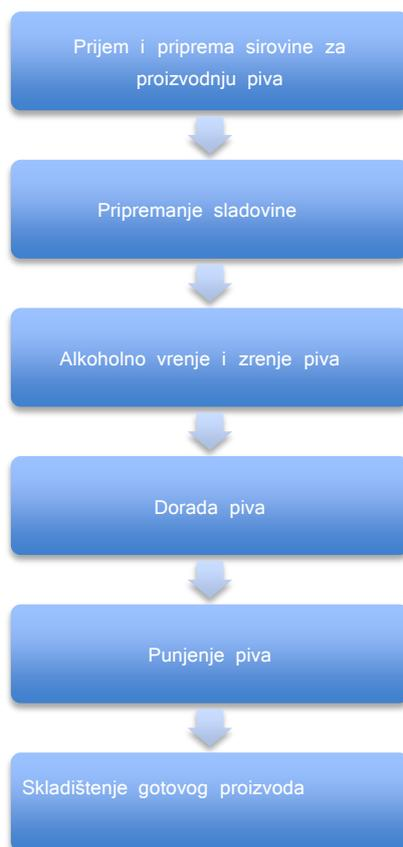
**Slika 11. Dijagram toka tehnološkog procesa proizvodnje piva [11]**
