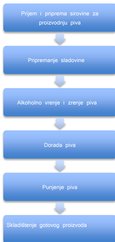
Slika 11. Dijagram toka tehnološkog procesa proizvodnje piva [11]
