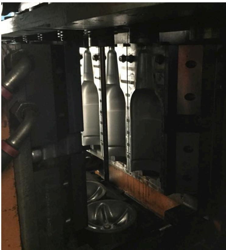
**Slika 30. Kalupi za ekstruzijsko puhanje u Istarskoj pivovari**
