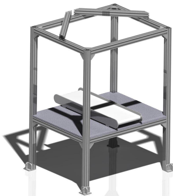
Slika 5. CAD model postolja Fanuc M3iA/6A robota sa pripadajućim transportnim sustavom
