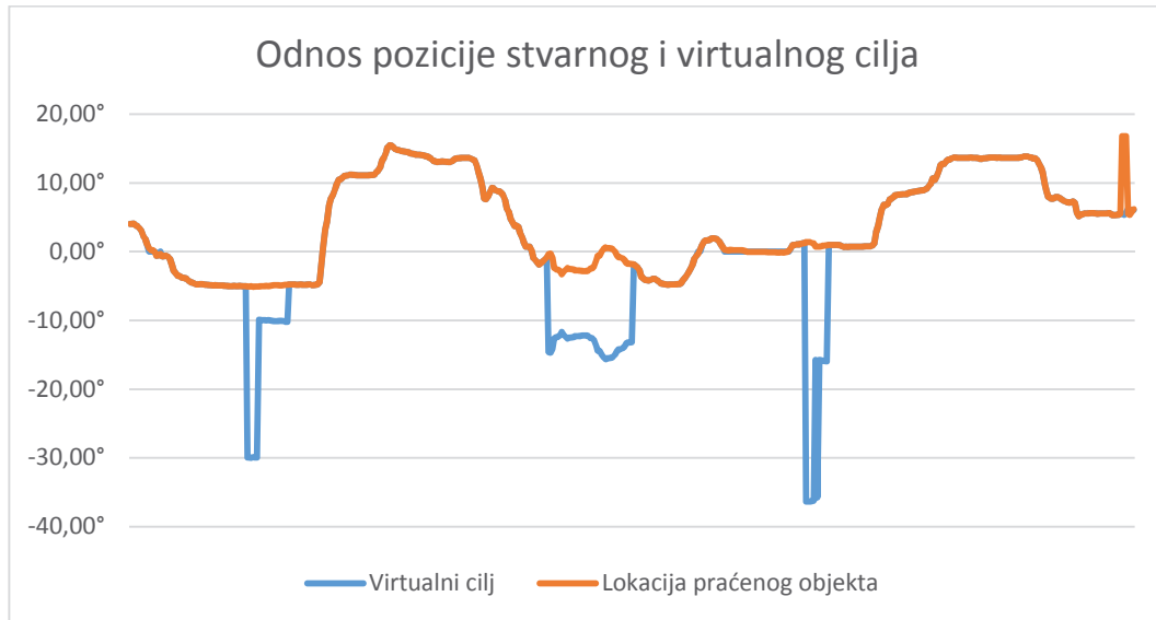
Slika 28: Pozicija stvarnog i virtualnog cilja u odnosu na središte simuliranog robota
