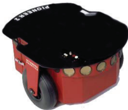
Slika 4: Pioneer 2 mobilni robot
