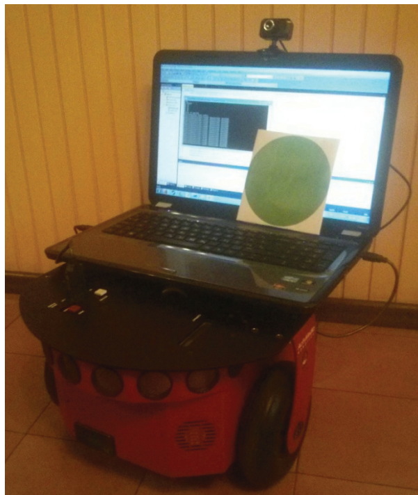
Slika 31: Pioneer 2 mobilni robot s prijenosnim računalom kao upravljačkim računalom
