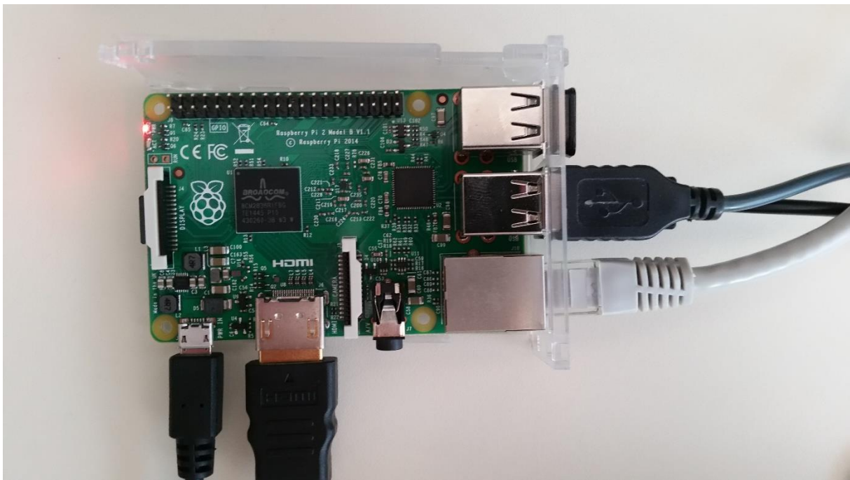
Slika 15. Raspberry Pi 2 sa priključenim svim perifernim jedinicama, Ethernet kabelom i napajanjem
