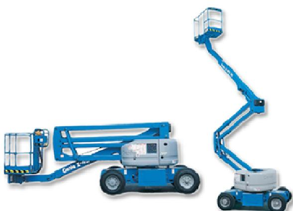
**Slika 6. Radna platforma sa više spojenih paralelograma**
