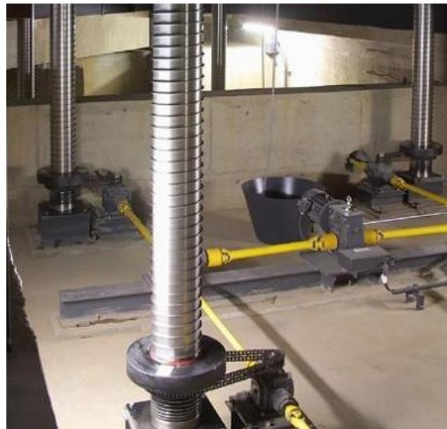
Slika 11. Elektromotorni pogon i prijenosnici snage
