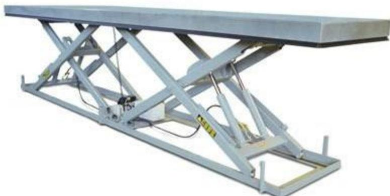
**Slika 17. Serijska izvedba škarastog mehanizma**
