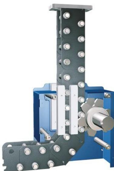
Kod prve izvedbe lanac pogonjen lančanikom ulazi u vodilicu koja ga usmjerava u vertikalnom smjeru. Prolaskom kroz vodilicu karike lanca, spojnice, se međusobno ukliješte te na taj način tvore nosivi stup. Bitno je da se sila prenosi preko spojница, karika lanca, koje nasjedaju jedna na drugu, a ne preko svornjaka. Na taj način se sprečava trošenje svornjaka i potreba za učestalim podmazivanjem.
