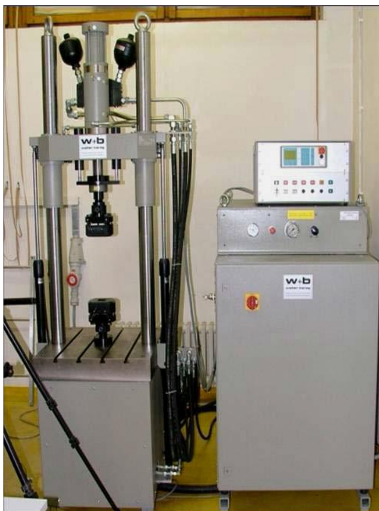
Slika 33. Umaralica Walter+Bai LFV 50-HH
