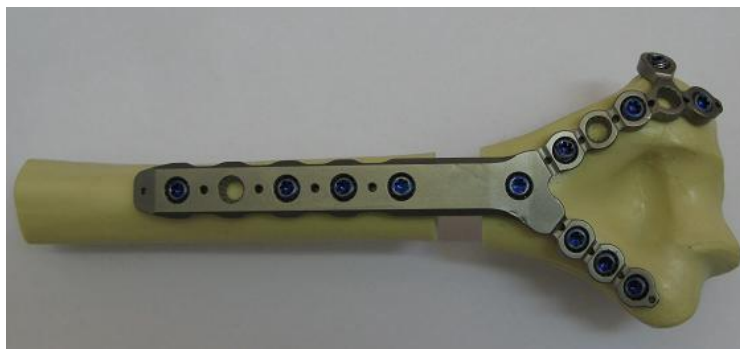
Slika 29. Osteosinteza s novokonstruiranom Y pločicom
