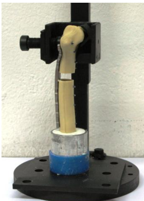
Slika 30. Model distalnog humerusa postavljen u napravi za fiksiranje i zaliven PMMA smjesom
