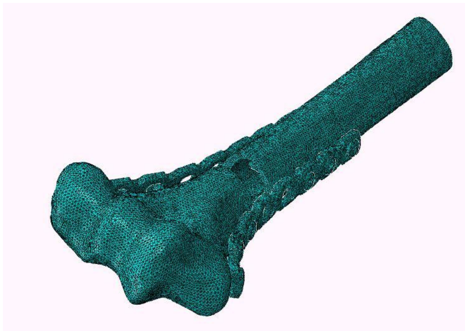
Slika 19. Mreža konačnih elemenata na modelu s dvije rekonstrukcijske pločice u paralelnoj konfiguraciji
