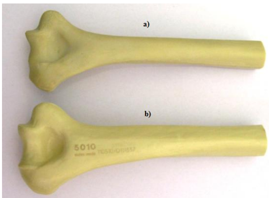
Slika 20. Umjetni modeli distalnog humerusa: a) osteoporotična kost, b) neosteoporotična kost
