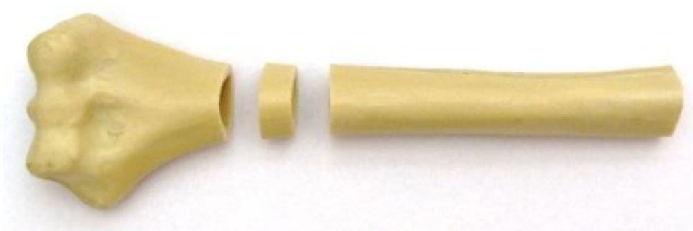
Slika 26. Umjetni osteoporotični distalni humerus – stanje po osteotomiji
