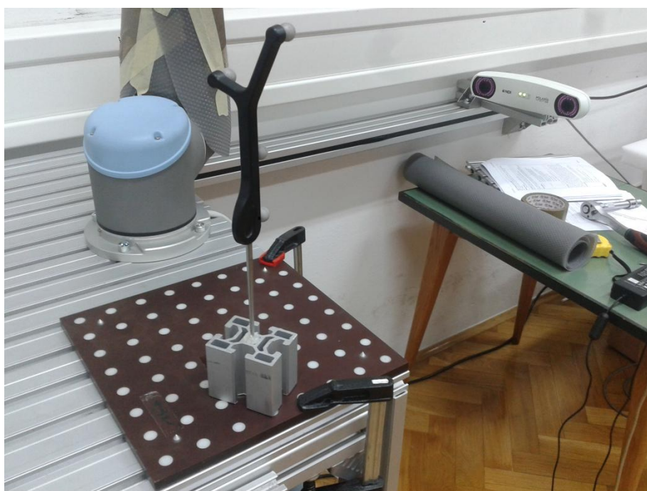
Slika 21. Ručno pomicanje sonde po kalibracijskoj ploči
