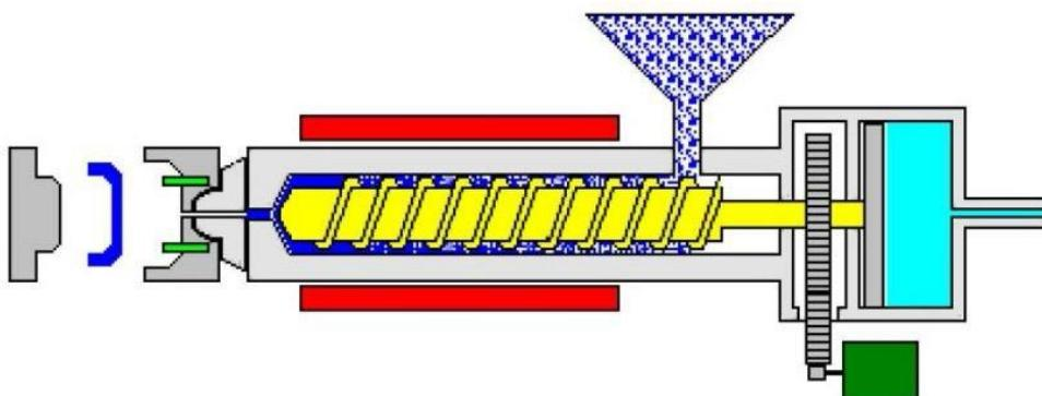
Slika 3.8. Hlađenje i vađenje otpreska iz kalupa [3]
