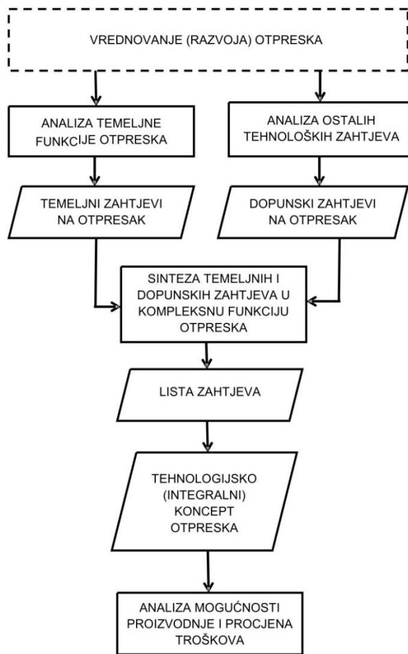
Slika 2.2. Polazišni postupci tehnologiskog konstruiranja otpreska [1]
