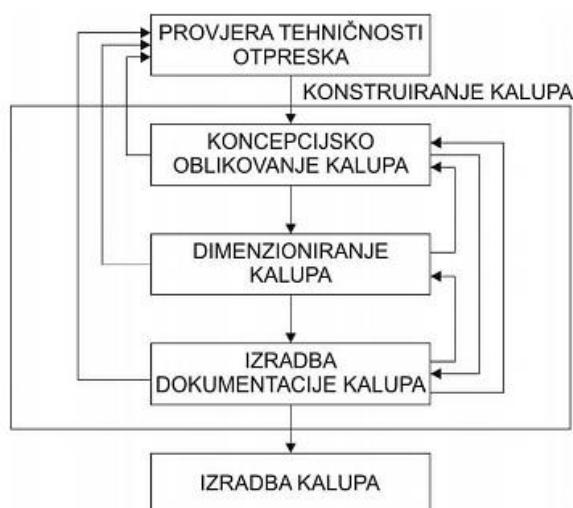
Slika 6.1. Temeljne faze konstruiranja kalupa za injekcijsko prešanje [8]
