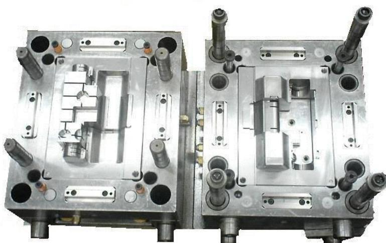
Slika 3.2. Kalup za injekcijsko prešanje [7]
