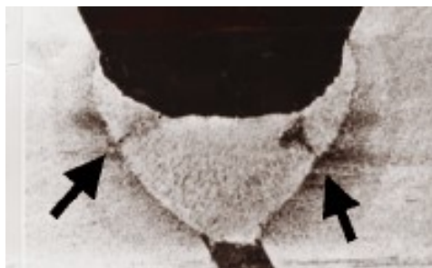
Slika 24. Pukotina uzrokovana prevelikim sadržajem sumpora u OM [20]
