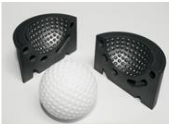
Slika 2.1. Čelični kalup za razvlačno puhanje načinjen postupkom izravnog srašćivanja metala s pomoću lasera (e. Direct metal laser sintering - DMLS ) [7]
