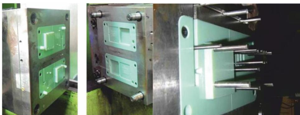
Slika 3.8. Kalupni umetci od materijala *PolyJet GreenFire* [8]
