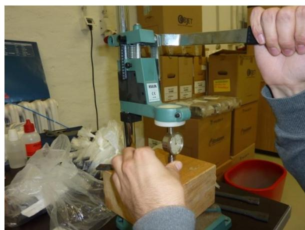
Slika 4.4. Mjerenje tvrdoće ispitnog tijela
