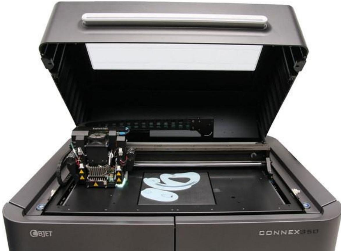
Slika 3.16. *Objet350 Connex* uređaj za postupak *PolyJet Matrix* [22]
