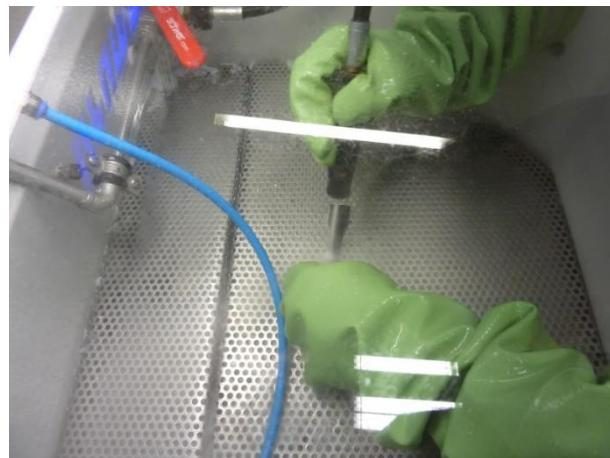
Slika 4.2. Ispiranje (odvajanje) potpornog materijala
