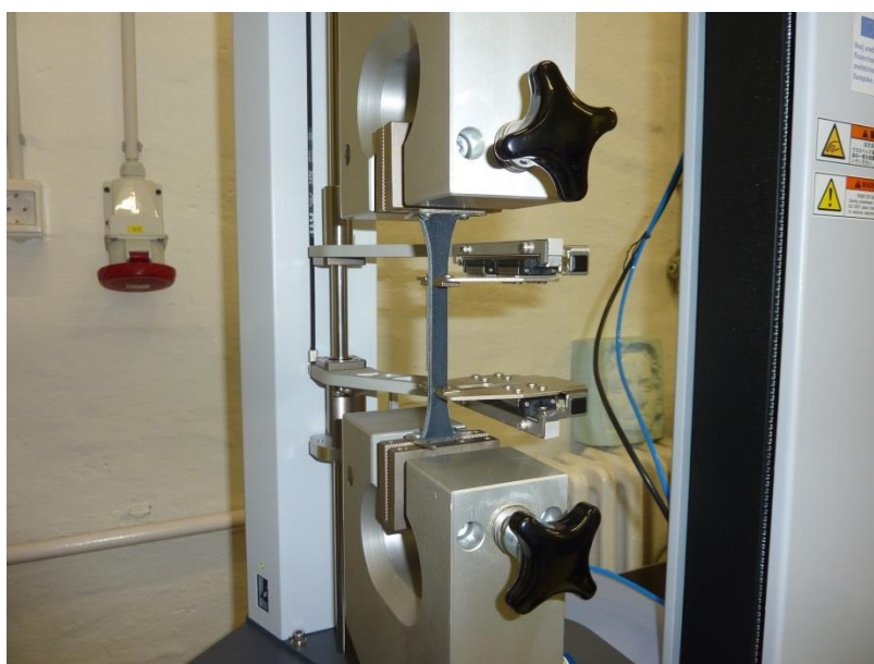
Slika 4.9. Čeljusti za ispitivanje rasteznih svojstava
