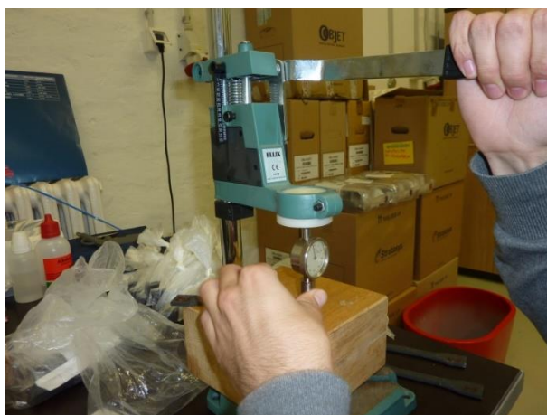
Slika 4.4. Mjerenje tvrdoće ispitnog tijela
