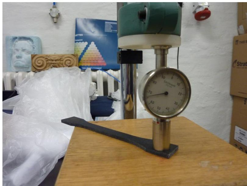
Slika 4.12. Mjerenje tvrdoće ispitnog tijela
