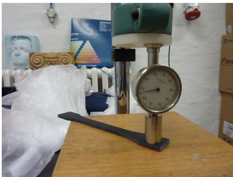
Slika 4.12. Mjerenje tvrdoće ispitnog tijela
