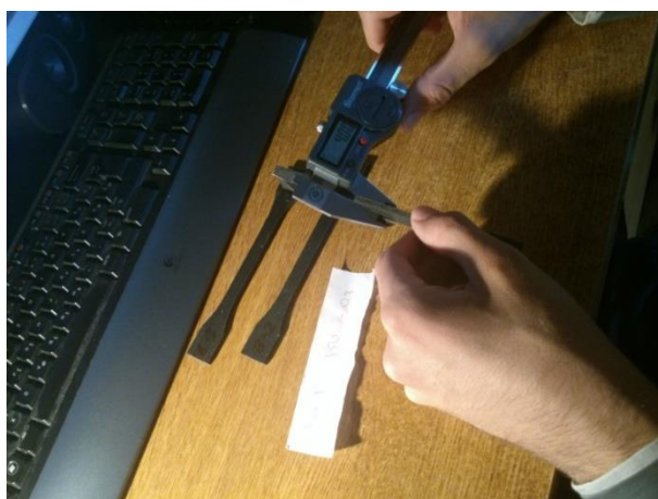
Slika 4.3. Mjerenje dimenzija ispitnog tijela
