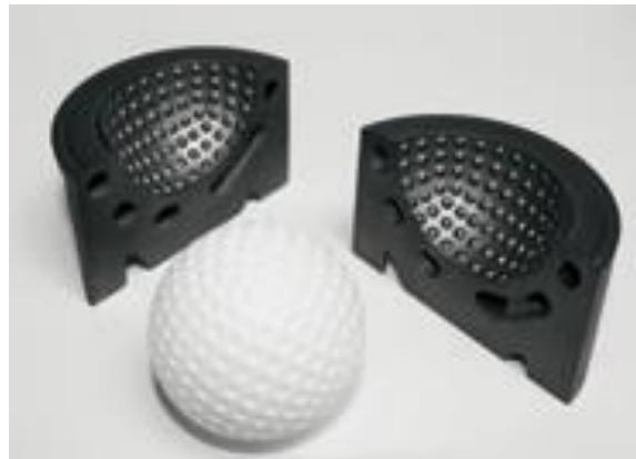
Slika 2.1. Čelični kalup za razvlačno puhanje načinjen postupkom izravnog srašćivanja metala s pomoću lasera (e. *Direct metal laser sintering - DMLS*) [7]
