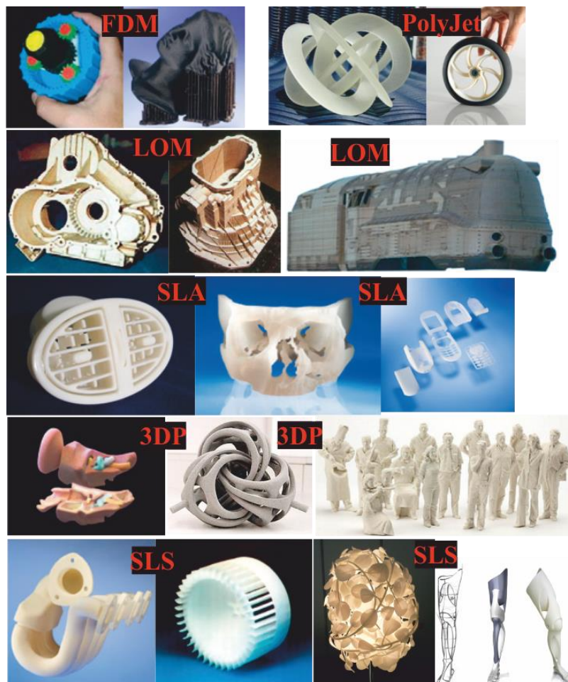
Slika 2.18. Primjeri proizvoda načinjenih AM postupcima [7, 1]
