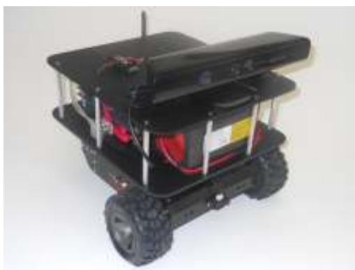
Slika 26. Primjer primjene Kinect senzora u mobilnoj robotici
