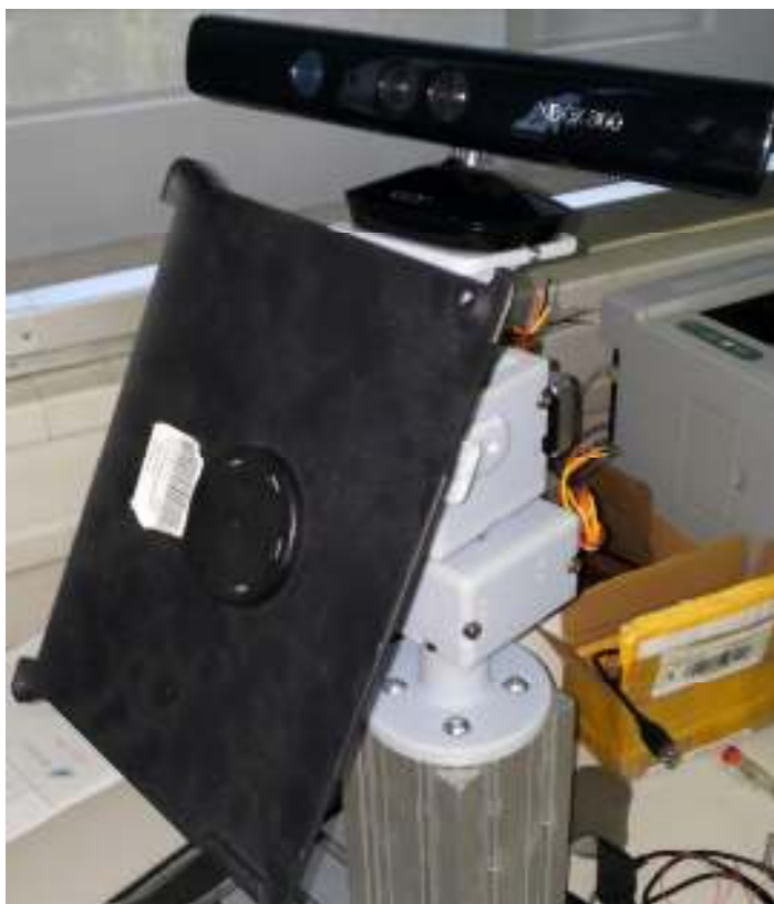
Slika 3. Sklop mehanizma robotske glave
