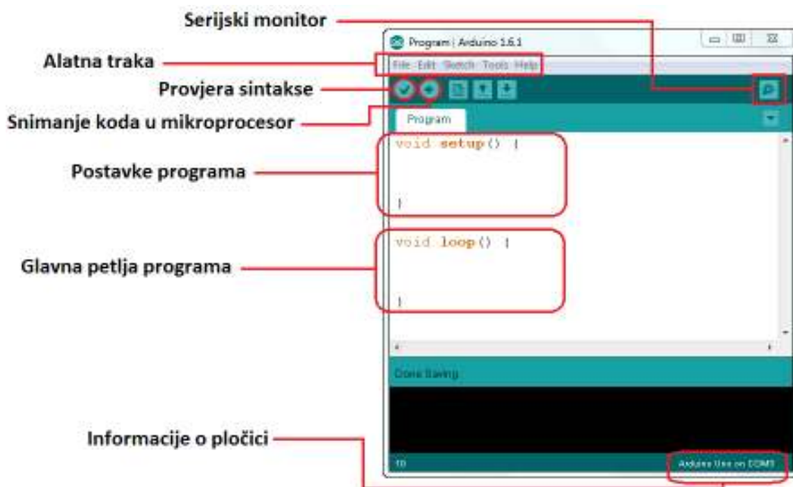
Slika 10. Osnovni dijelovi Arduino IDE sučelja za programiranje
