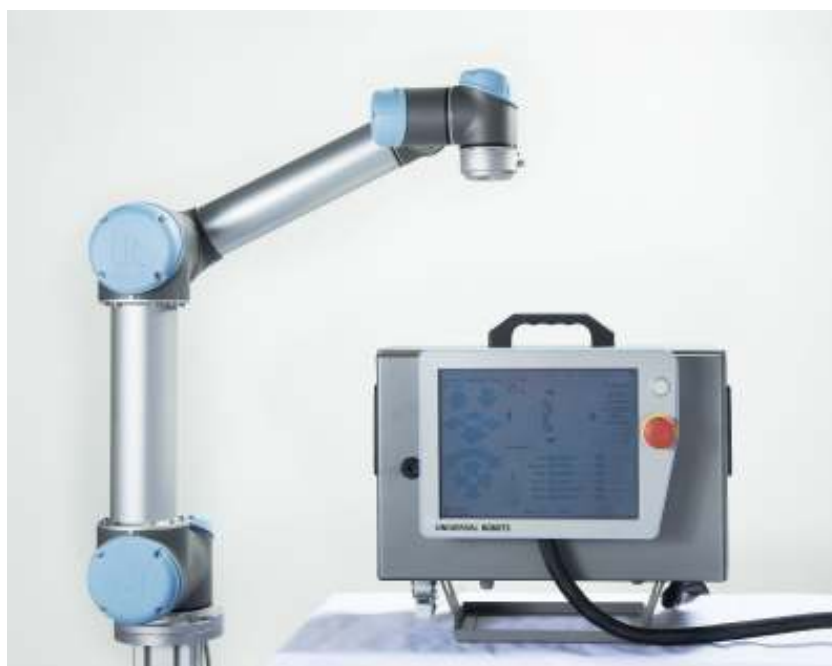
Slika 29. Upravljačka jedinica robotske ruke sa privjeskom za učenje
