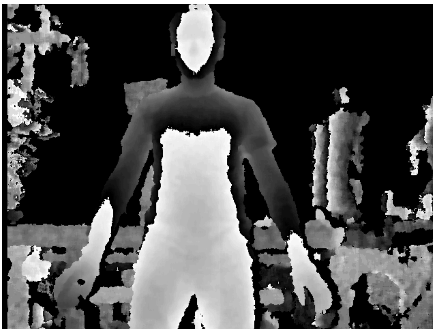
Slika 24. Prikaz mape dubine sa Kinect-a
