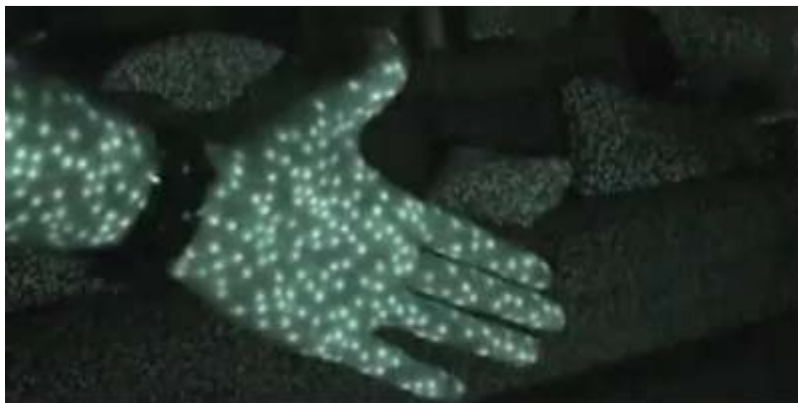
Slika 23. Projekcija infracrvenog uzorka sa Kinect-ove dubinske kamere
