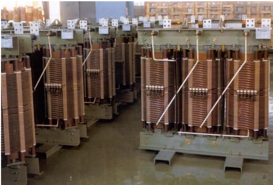
Slika 13. Primjer suhog distributivnog transformatora. [22]
