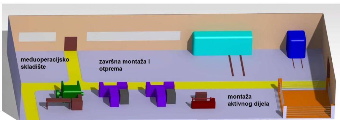
Slika 48. Hala 4: novi raspored strojeva (3D).
