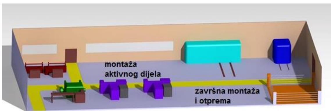
Slika 47. Hala 4: sadašnje stanje rasporeda strojeva (3D).
