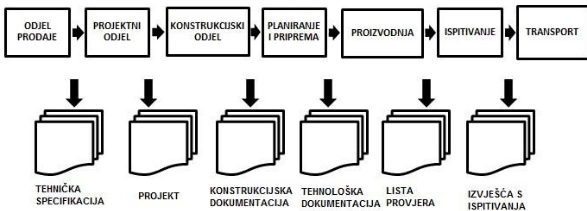
Slika 16. Pojednostavljeni prikaz razvojnog ciklusa transformatora po odjelima.
