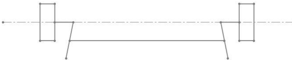
Slika 29. Davisov sustav s letvom iza osovine
