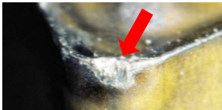
Slika 24. Krzanje oštrice alata [1]
