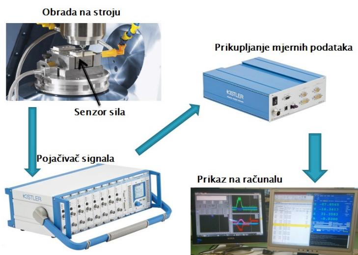
Slika 45. Primjer toka i obrade signala iz senzora sile [40]
