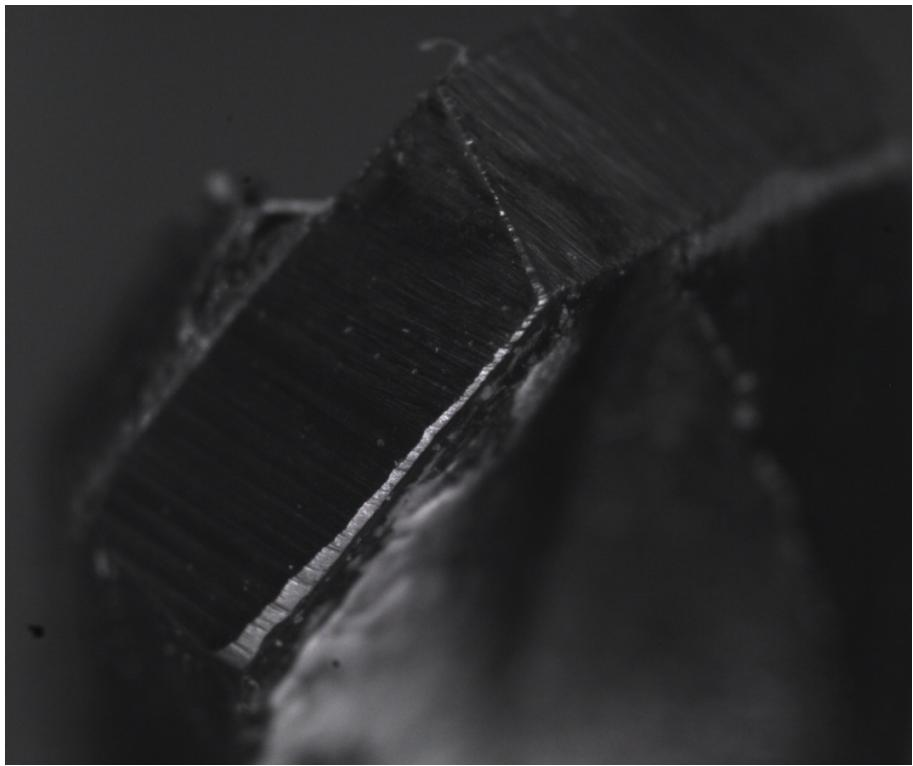
Slika 68. Izgled rezne oštice i stražnje površine "2" svrdla "A2" nakon 1378 izbušenih prvrta
