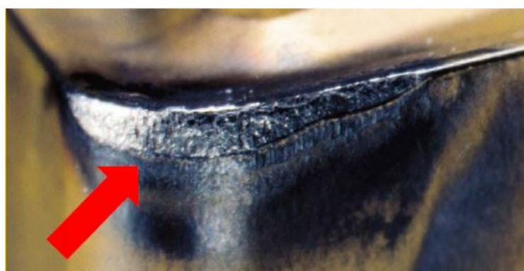
Slika 20. Trošenje stražnje površine alata [5]
