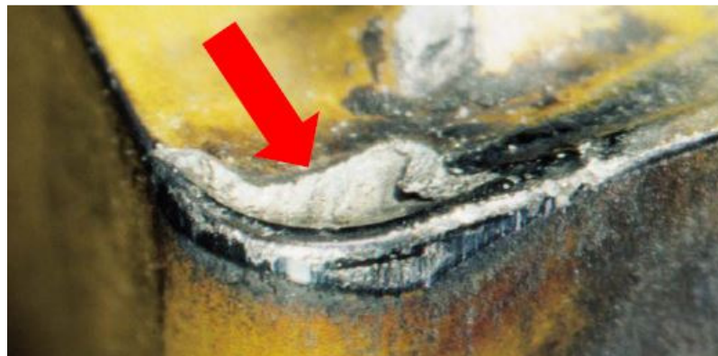
Slika 21. Kratersko trošenje alata [5]
