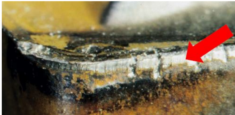
Slika 23. Toplinska napuknuća na alatu [1]
