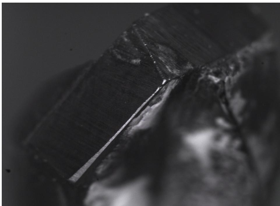
**Slika 64. Izgled rezne oštice i stražnje površine "1" svrdla "A2" nakon 1378 izbušenih provrta**
