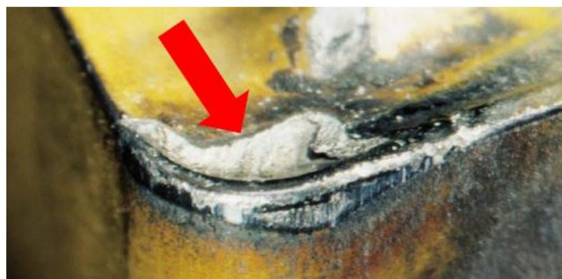
Slika 21. Kratersko trošenje alata [5]
