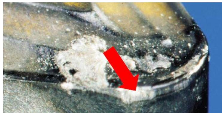
**Slika 25, Naljepak na oštrici alata [5]**
