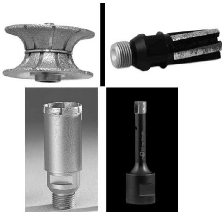
Slika 28. Prikaz različitih alata za obradu kamena s dijamantnim zrnima [7]
