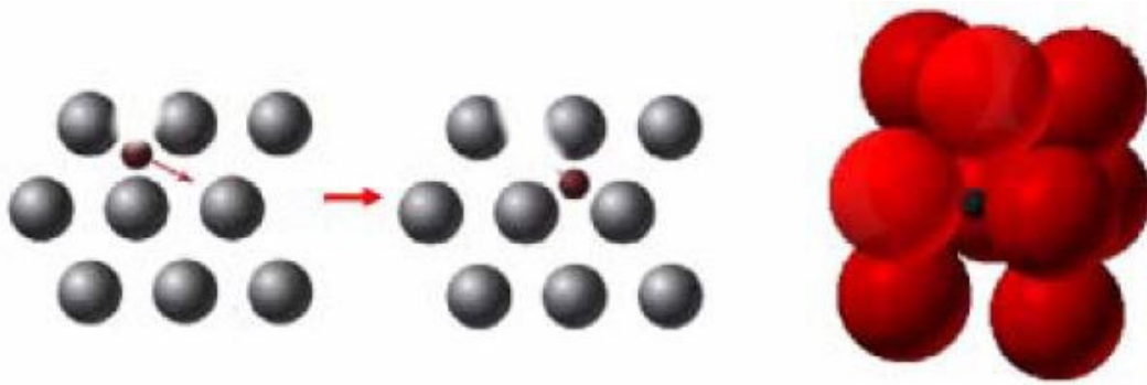
Slika 17. Intersticijski mehanizam kretanja atoma [11]
