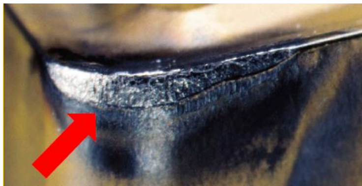
Slika 20. Trošenje stražnje površine alata [5]
