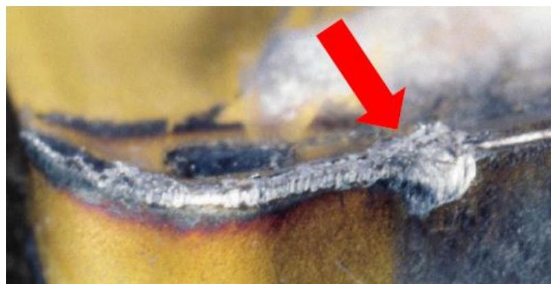
Slika 22. Zarezno trošenje alata [5]
