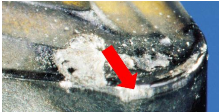
Slika 25, Naljepak na oštrici alata [5]
