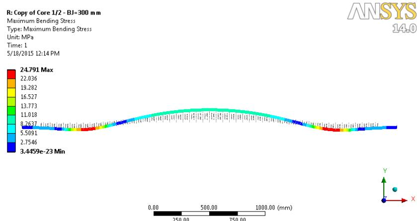
Slika 84. Naprezanja uslijed savijanja – Jezgra ½ s bandažama
