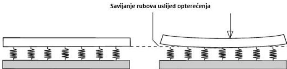
**Slika 13. Primjer promjenjivih rubnih uvjeta uslijed opterećenja [25]**
