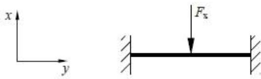
**Slika 21. Horizontalna greda uklještena na oba kraja opterećena poprečnom silom u sredini [23]**
