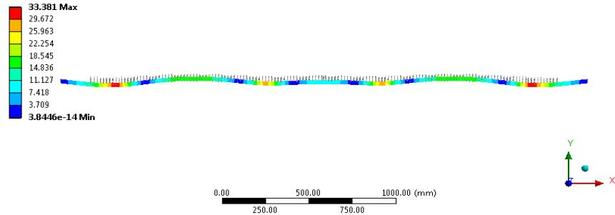
Slika 94. Naprezanja uslijed savijanja – Jezgra 1/2 s vijcima
