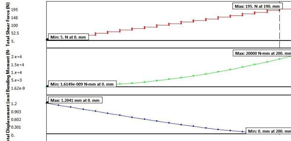
Slika 26. Raspodjela poprečnih sila (crveno), momenata savijanja (zeleno) i vertikalnog progiba (plavo) po duljini konzole za najgušću mrežu K.E. (20 K.E.)
