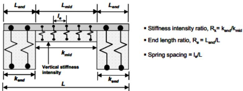
**Slika 12. Diskretizacija grede na nelinearnoj elastičnoj podlozi s promjenjivom krutosti pod duljinu grede [35]**
