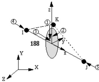
Slika 15. BEAM188 linearni prostorni jednodimenzijski konačni element [55]
