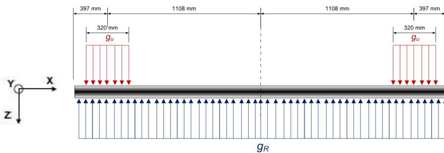
Slika 39. Pojednostavljeni analitički proračun grede (Jezgra  $\frac{1}{2}$ )
