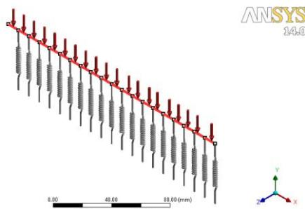
Slika 33. Konzola na elastičnoj podlozi – 1-D ANSYS model
