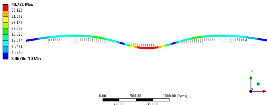
Slika 104. Naprezanja uslijed savijanja – Jezgra 2/0 s bandažama
