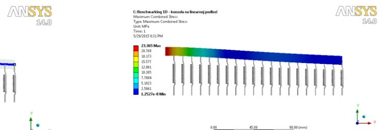
Slika 35. Raspodjela naprezanja konzole na elastičnoj podlozi
