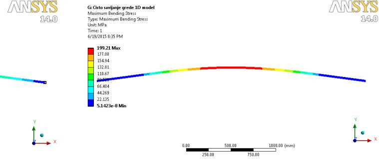
Slika 46. Naprezanje uslijed savijanja
