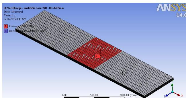
Slika 62. 3D Numerički model grede na elastičnoj podlozi – ANSYS 14.0
