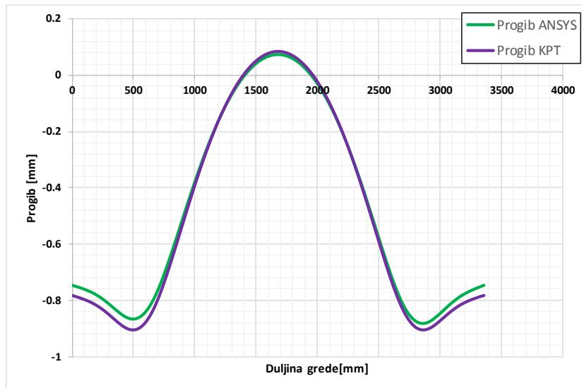
Slika 86. Usporedba vertikalnog progiba u smjeru y-osi između KPT modela i ANSYS modela
