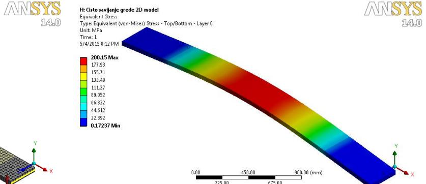
Slika 48. Raspodjela naprezanja 2D modela čistog savijanja grede
