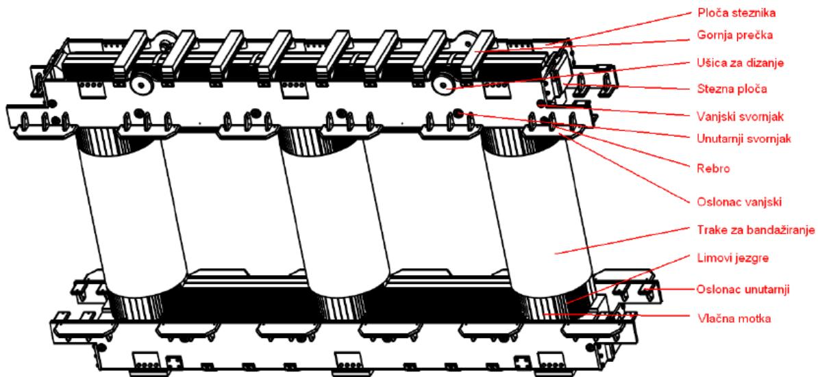
**Slika 5. Dijelovi gornjeg dijela steznog sustava [2]**
