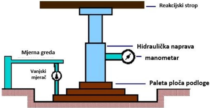
Slika 9. Određivanje modula podloge pomoću hidrauličke naprave [37]
