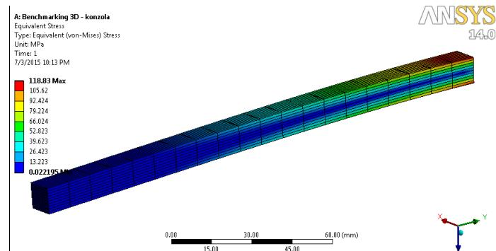
Slika 27. Ekvivalentna naprezanja 3D modela konzole opterećene kontinuiranim opterećenjem
