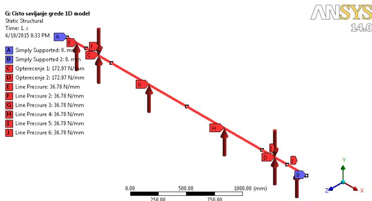
Slika 44. Čisto savijanje grede - 1D model (Jezgra 1/2 )
