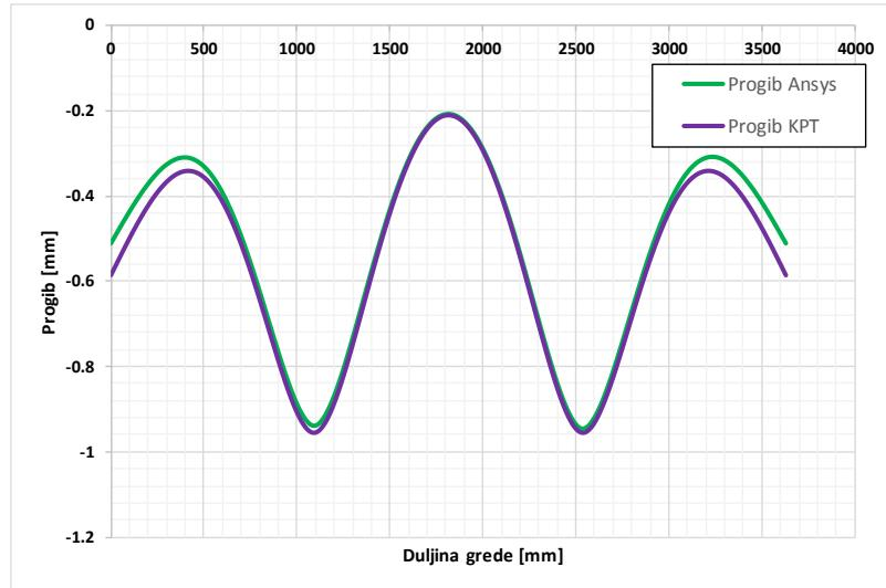
**Slika 119. Usporedba vertikalnog progiba u smjeru y-osi između KPT modela i ANSYS modela
