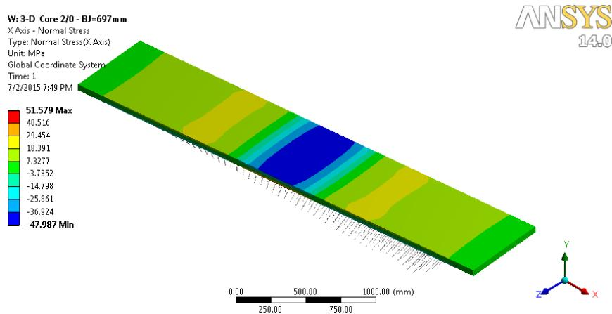
Slika 123. Raspodjela normalnih naprezanja 3D modela u smjeru X-osi → Jezgra 2/0
