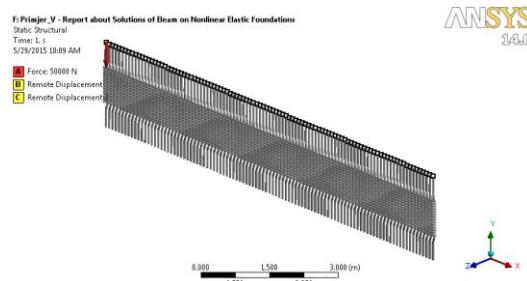
Slika 74. ANSYS 1D model grede na nelinearnoj podlozi
