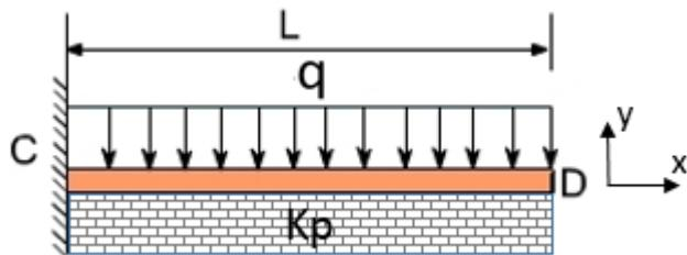
**Slika 30. Konzola na elastičnoj podlozi opterećena kontinuiranim opterećenjem**
