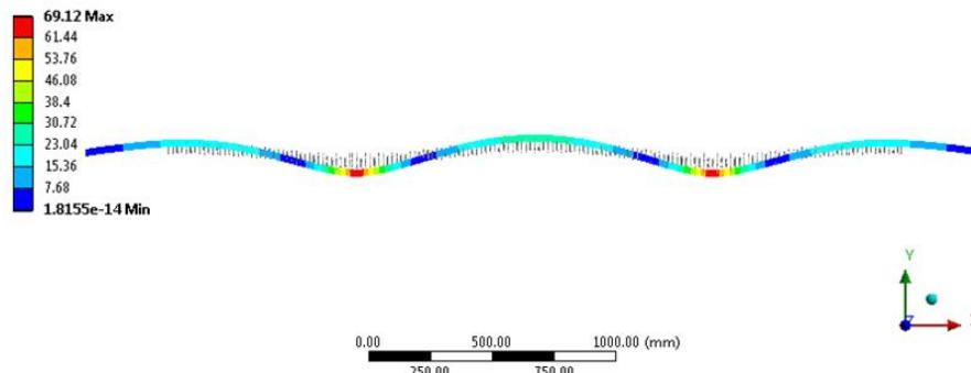
Slika 117. Naprezanja uslijed savijanja – Jezgra 2/0 s vijcima
