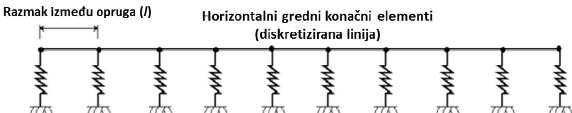
Slika 14. Diskretizirani pristup proračuna grede na elastičnoj podlozi [38]
