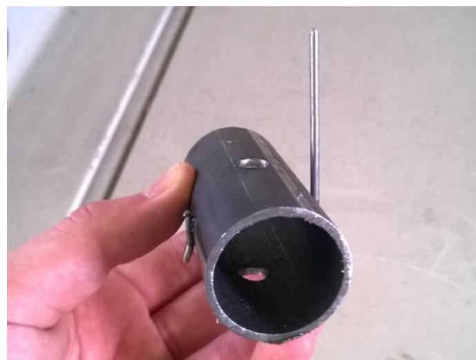
Slika 47. Uzorak pripremljen za smičnu probu [19]
