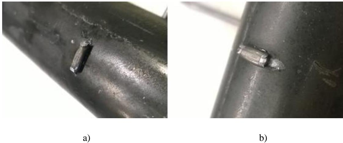
Slika 46. a) pucanje žice u ZUT-u uzorka test 4, b) pucanje žice u zavaru uzorka test 2 [19]
