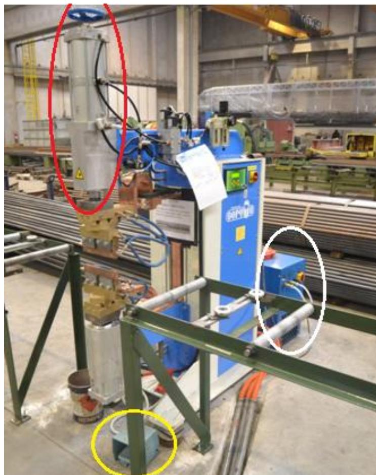
Slika 40. Stroj za bradavičasto elektrootporno zavarivanje sklopa žica-cijev [19]
