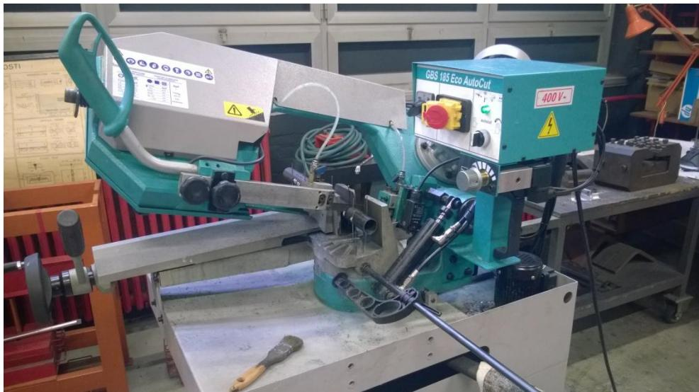
Slika 43. Priprema uzoraka rezanjem na tračnoj pili [19]
