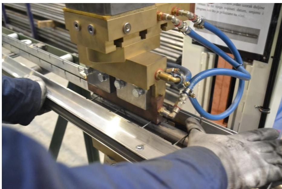
Slika 37. Trenutak neposredno prije zavarivanja sklopa žica-cijev [19]
