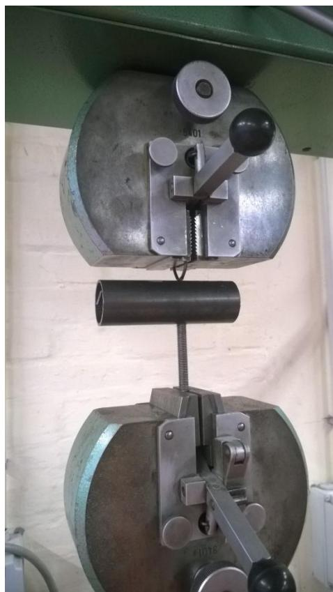
Slika 51. Ispitivanje probom čupanja [19]
