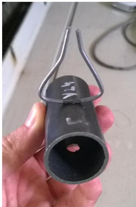
Slika 50. Uzorak pripremljen za mehaniziranu probu čupanja [19]
