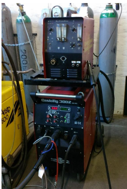
Slika 17 (a) Izvor struje za zavarivanje CastoTig 3002, (b) Identifikacijska pločica izvora struje
