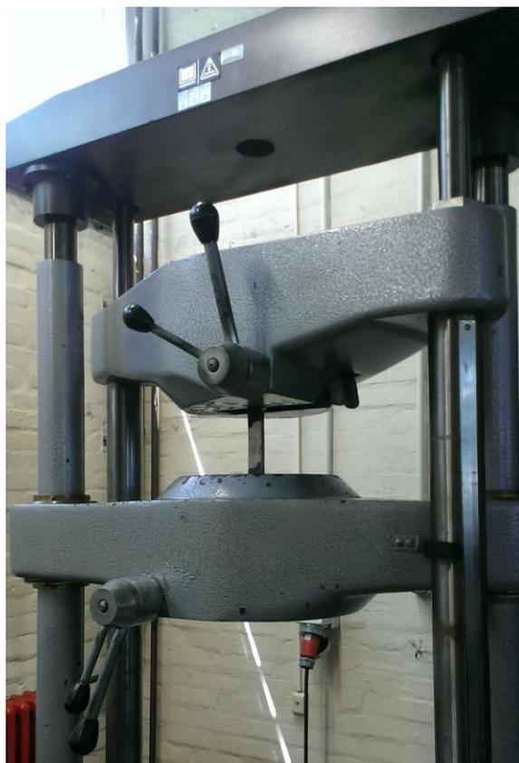
Slika 26 Kidalice EU 40 mod s epruvetom
