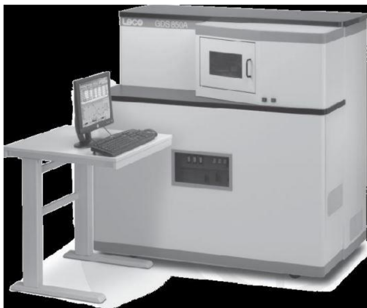
Slika 22. Uređaj za optičku emisijsku spektrometriju s tinjajućim izbojem
