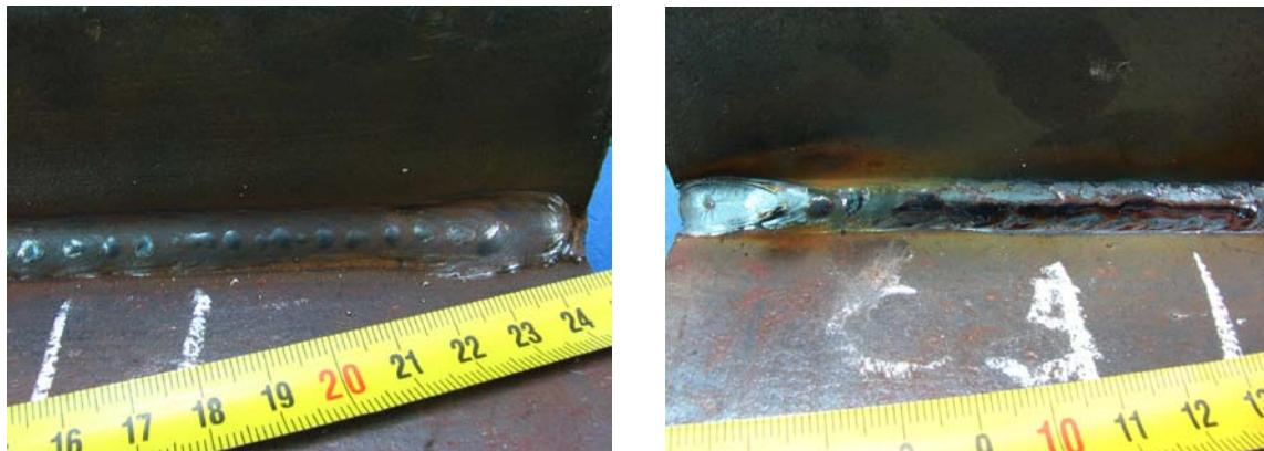
*Slika 4.13 Kutni spojevi dobiveni zavarivanjem pri prijelaznim vrijednostima: uzorak 4. (lijevo) i uzorak 5. (desno)*
