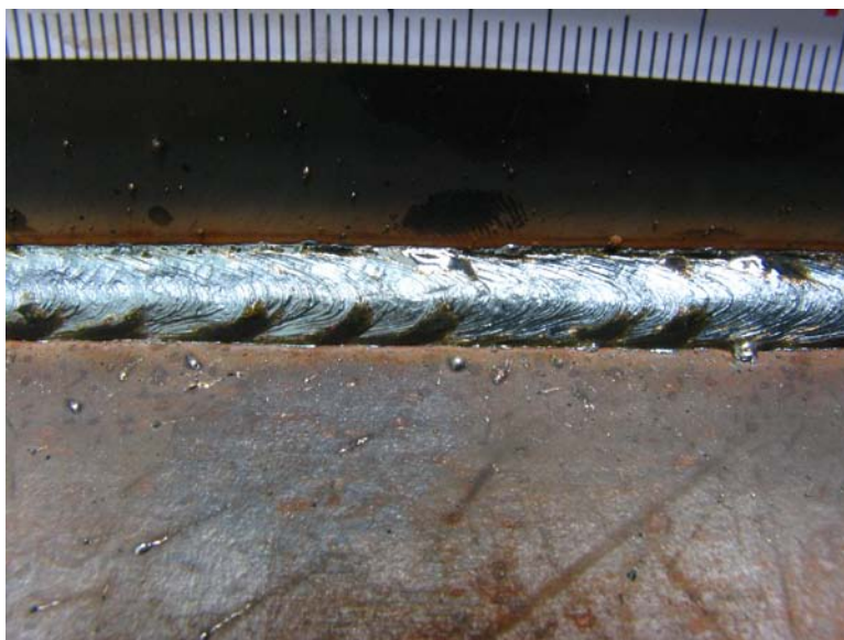
Slika 4.11 Uzorak 2., kutni spoj zavaren u zaštitnoj atmosferi \text{CO}_2
