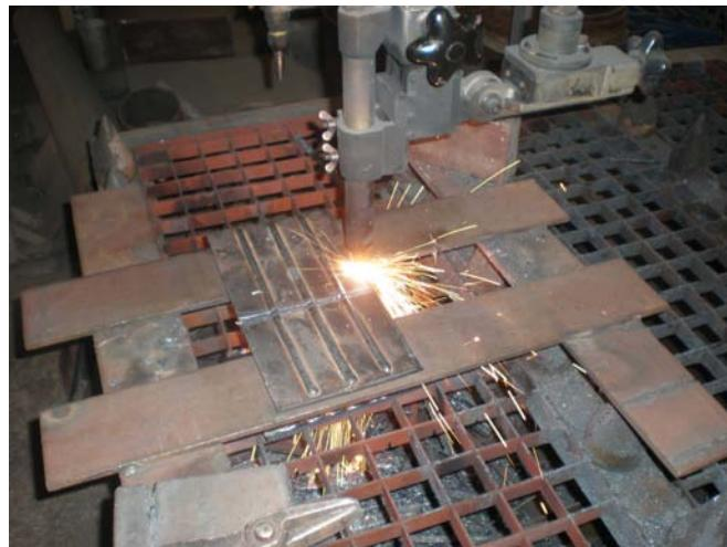
*Slika 4.15 Rezanje ploče s navarima plinskim postupkom na automatskoj rezačici „Uljanik“*
