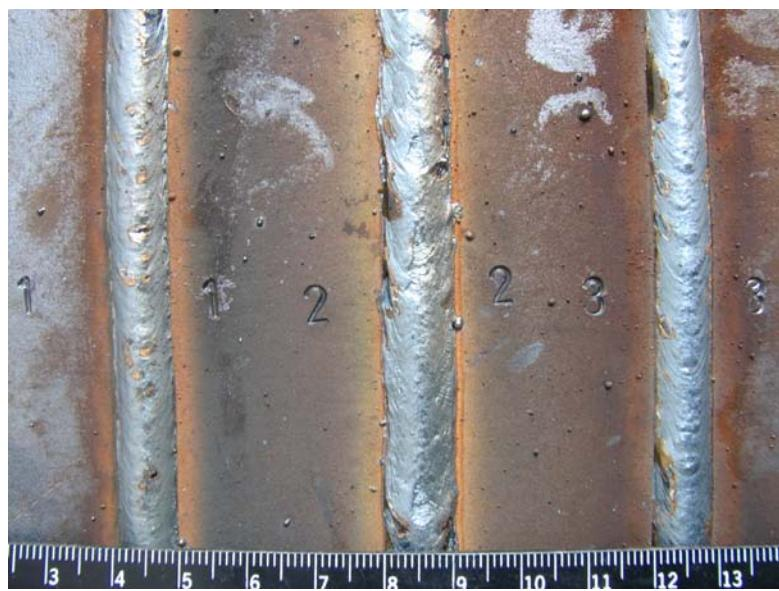
*Slika 4.14 Uzorci navareni u zaštiti eksperimentalnih mješavina*
