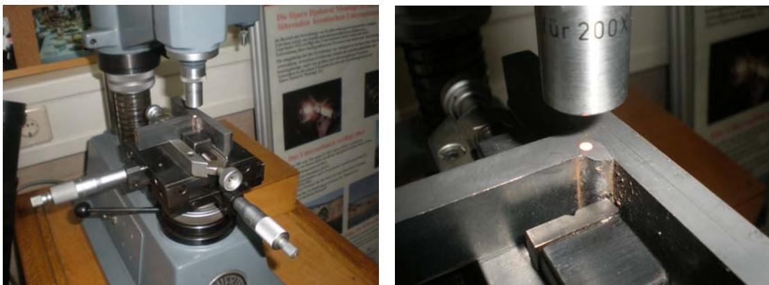
*Slika 4.19 Ispitivanje tvrdoće na Vickers tvrdomjeru modela HV<sub>10</sub>*
