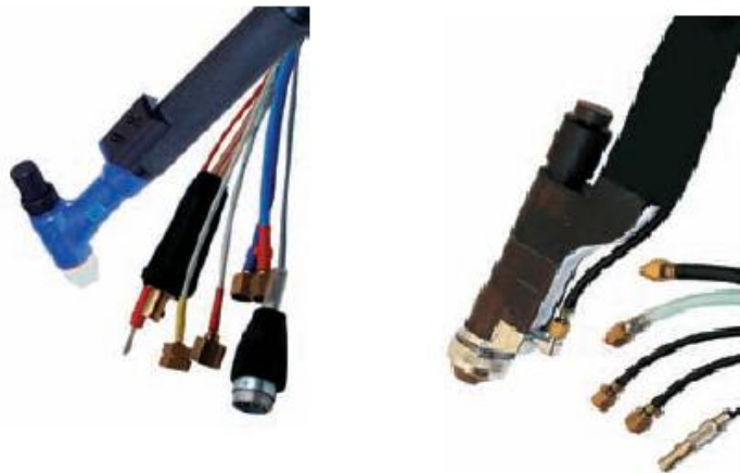
Slika 16. Pištolj za mikroplazma (lijevo) i plazma (desno) zavarivanje [17]
