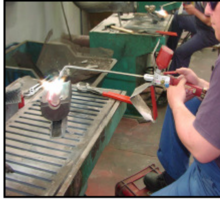
Slika 12. Ručno navarivanje kalupa[2]
