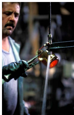
Slika 59. Ispitivanje staklenih spremnika u vrućoj zoni[3]
