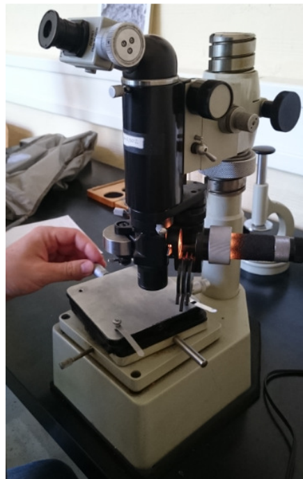
Slika 119. Postupak ispitivanja mikrotvrdoće
