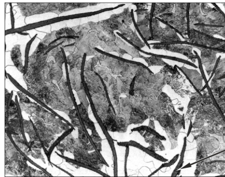
Slika 68. Mikrostruktura perlitno-feritnog sivog lijeva, povećanje 250:1[18]
