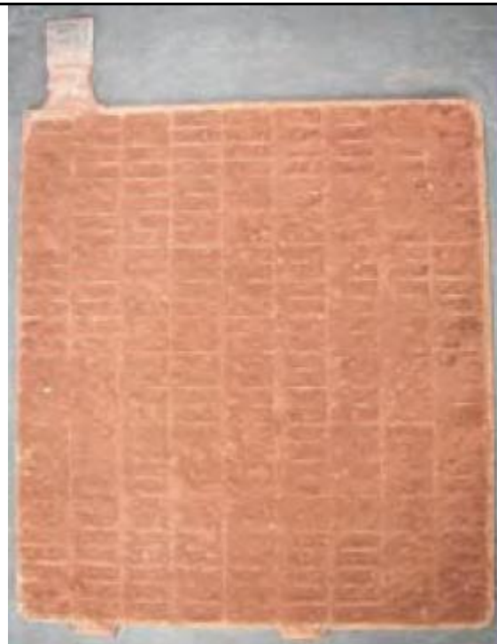
Slika 25 Pozitivna pastirana ploča, otvrdnjena i osušena
