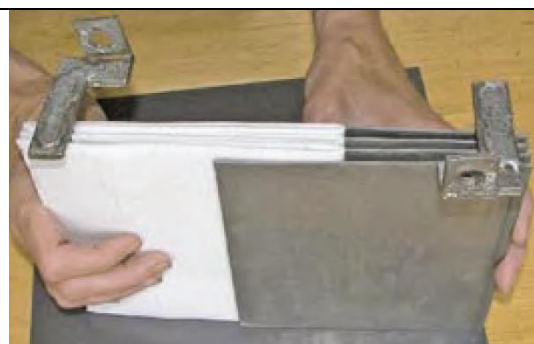
Slika 23 Formiranje pločnog paketa
