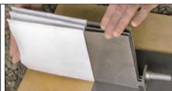
**Slika 22 Postavljanje separatora ploča na pozitivne ploče**
