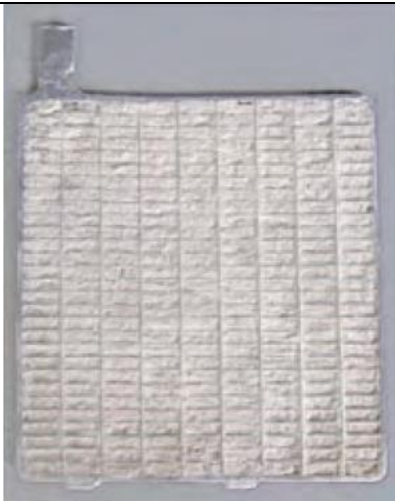
Slika 24 Negativna pastirana ploča, otvrdnjena i osušena
