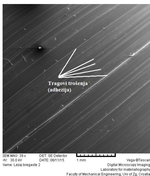
Slika 64. SEM analiza – osovina (rukavci ležajeva)
