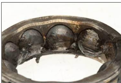
Slika 23. Primjer nepoželjnog djelovanja trenja [23]
