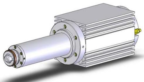
*Slika 5.4. Visokobrzinsko motorvreteno [23]*
