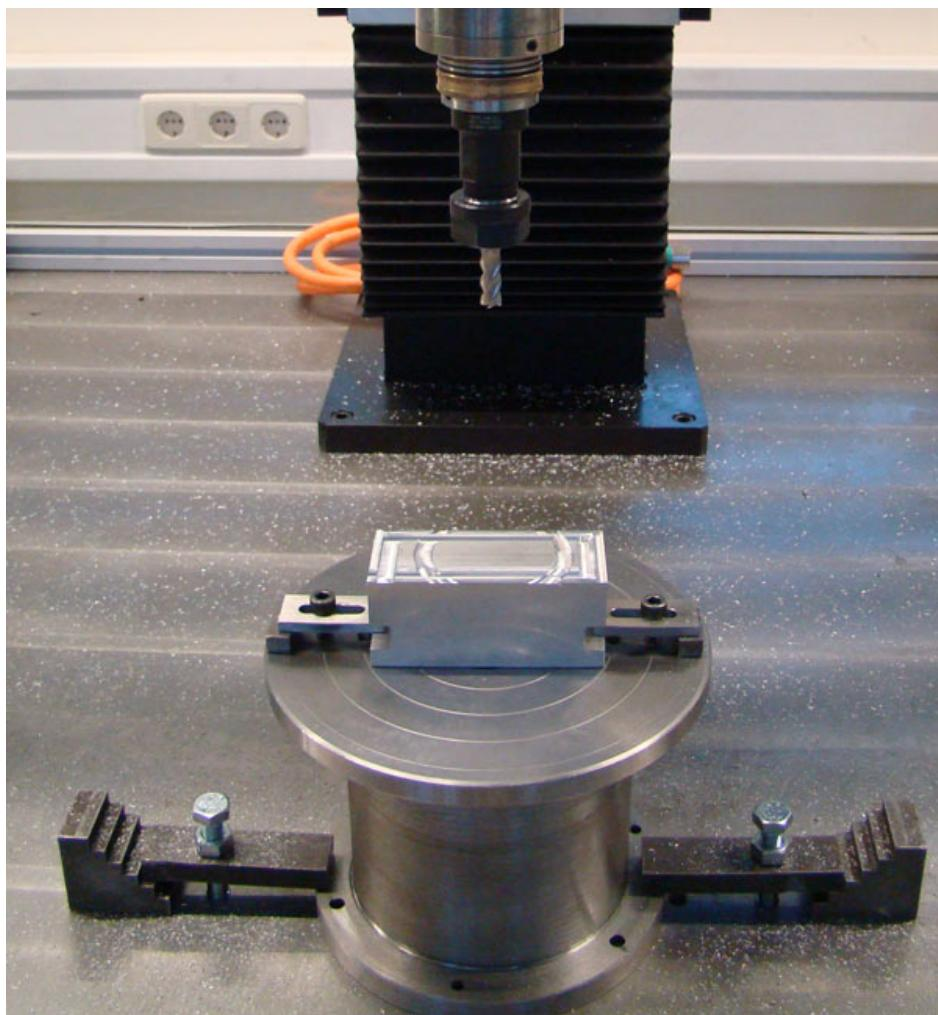
*Slika 5.13. Naprava za stezanje obradaka*
