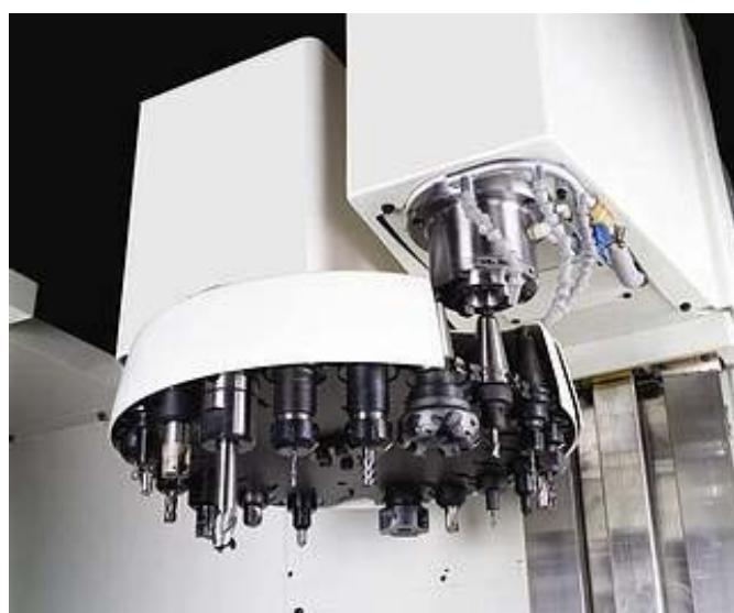
*Slika 3.4. Prikaz automatske izmjene alata [12]*
