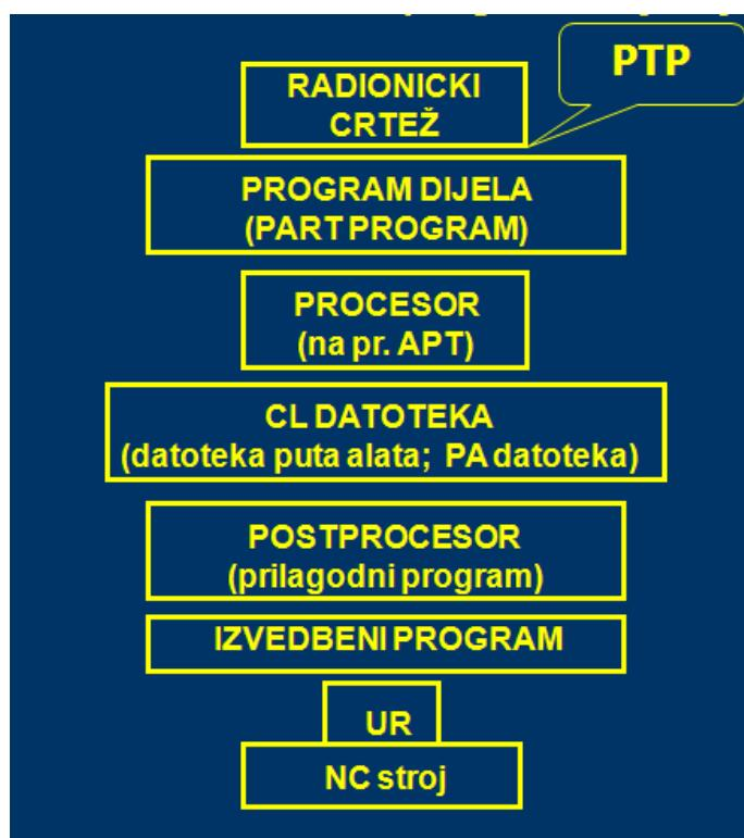
Slika 3.3. Prikaz automatiziranog programiranja NC strojeva [11]
