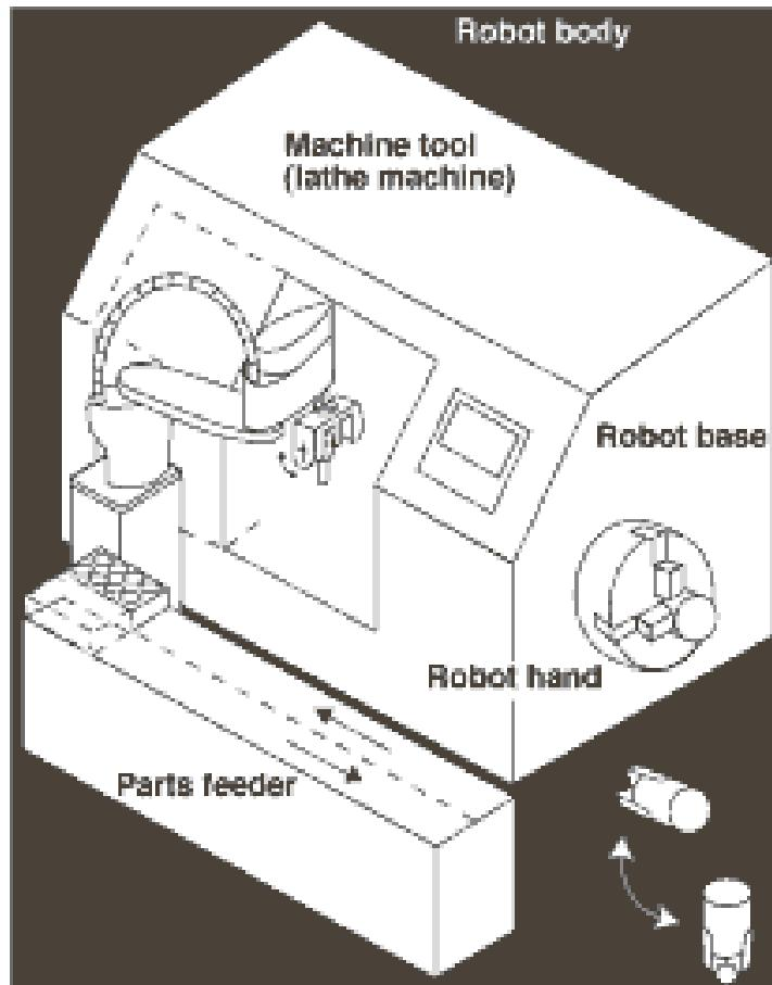
*Slika 4.6. Prikaz posluživanja obradnog centra SCARA robotom [21]*
