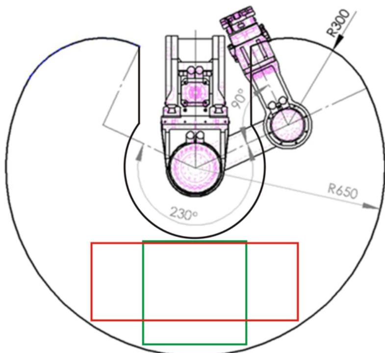
Slika 5.12. Radni prostor laboratorijskog SCARA robota [23]
