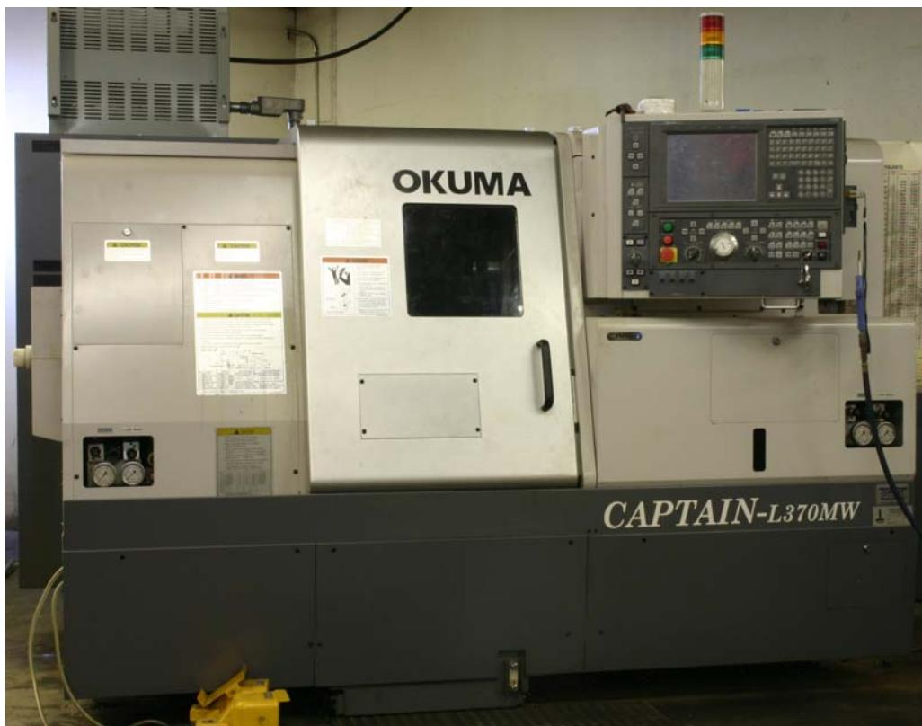
*Slika 2.2. Suvremeni CNC tokarski obradni centar [5]*
