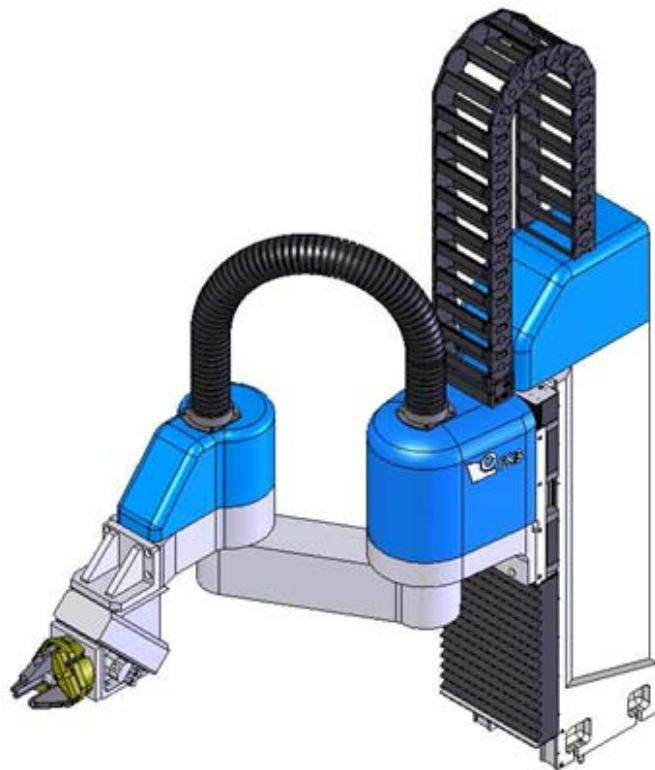
Slika 5.1. 3D model FSB Scara robota [23]
