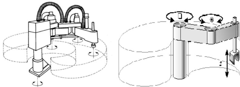
Slika 5.11. Radni prostor klasičnih SCARA robota [26]
