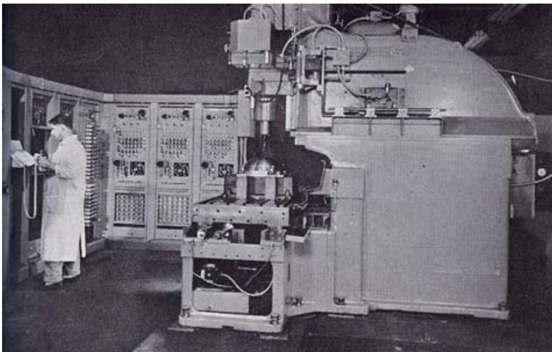
Slika 3.1. Prvi NC alatni stroj razvijen na MIT-u [9]
