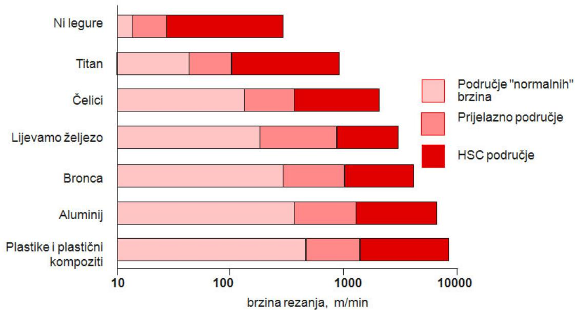
Slika 5.5. Brzine rezanja kod visokobrzinske obrade [24]
