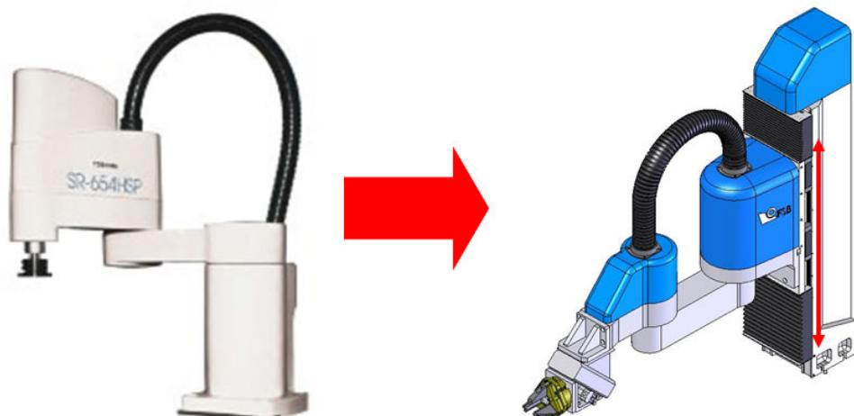
Slika 5.6. Standardna struktura SCARA robota i modificirana struktura [23]
