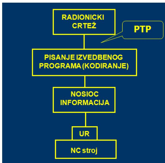
*Slika 3.2. Prikaz postupka ručnog programiranja NC strojeva [11]*
