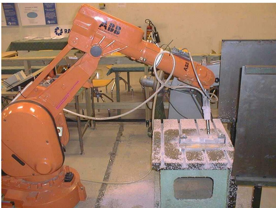
Slika 4.8. Robot vrši 5 - osnu obradu u aluminiju [22]
