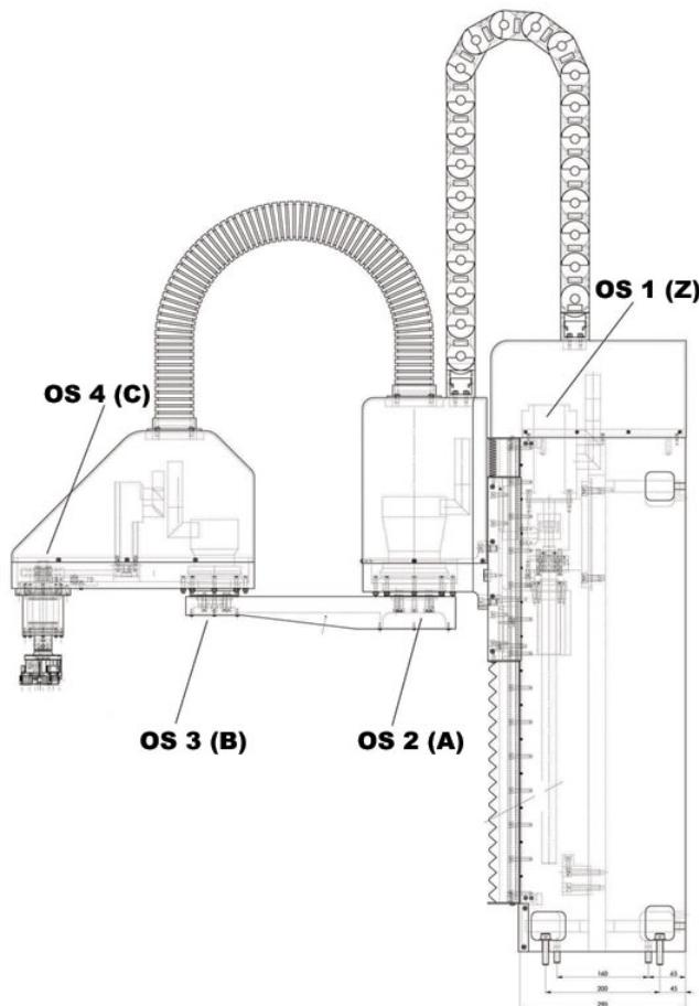
Slika 5.16. Struktura robota sa označenim osima [23]
