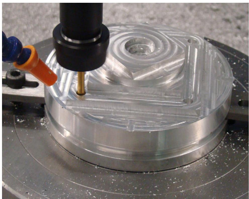
Slika 5.24. Obradivanje testnog izratka na laboratorijskom SCARA robotu
