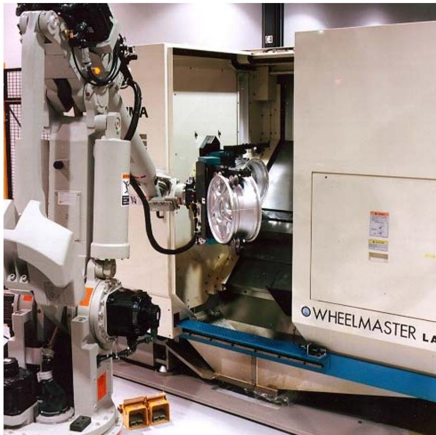
Slika 4.3. Robot skida obradak sa CNC stroja [18]
