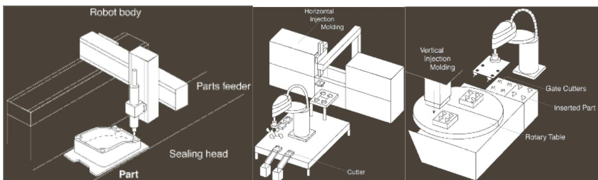
*Slika 4.7. Prikaz različitih područja primjene SCARA robota [21]*
