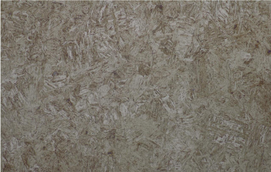
Slika 39b. Mikrostruktura malog zupčanika- sredina, povećanje 500x
