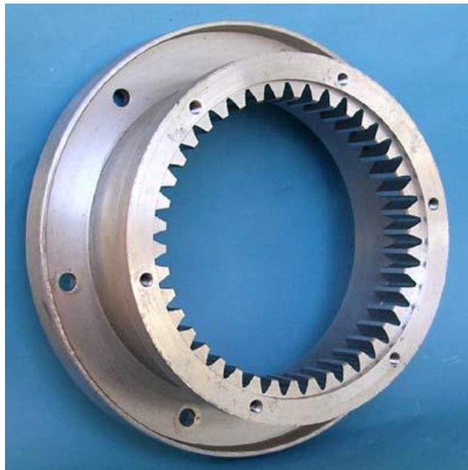
Slika 10. Unutarnji zubi zupčanika dobiveni iglom za provlačenje [4]
