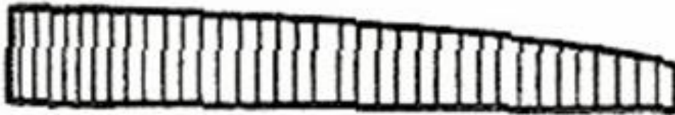
Slika 14a. Neparalelnost površine [7]
