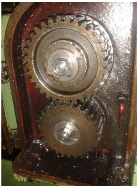
Slika 3.3 Zupčanički prijenosnici za namještanje brzine rezanja
