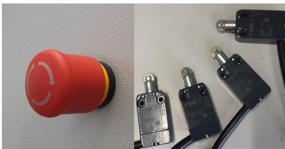
Slika 4.16 Tipkalo za stop u nuždi na elektro-ormaru i krajnji prekidači
