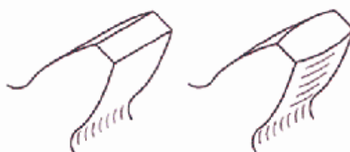
Slika 4.29 Ravno i bombirano ozubljenje u 3D
