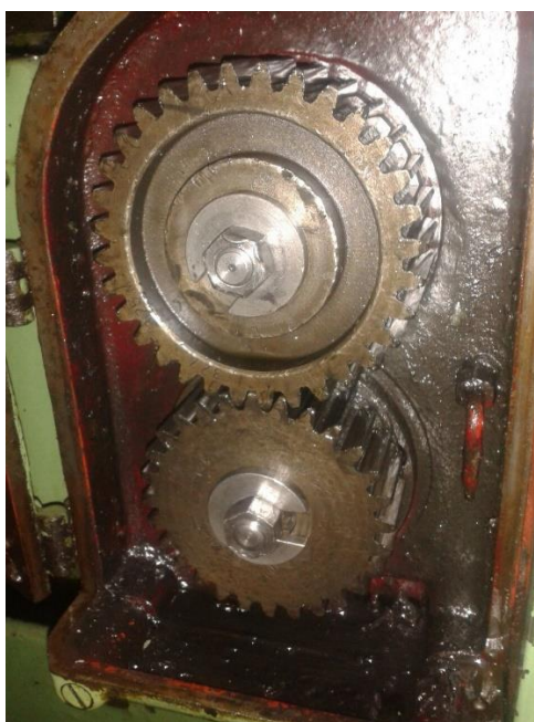
Slika 3.3 Zupčanički prijenosnici za namještanje brzine rezanja
