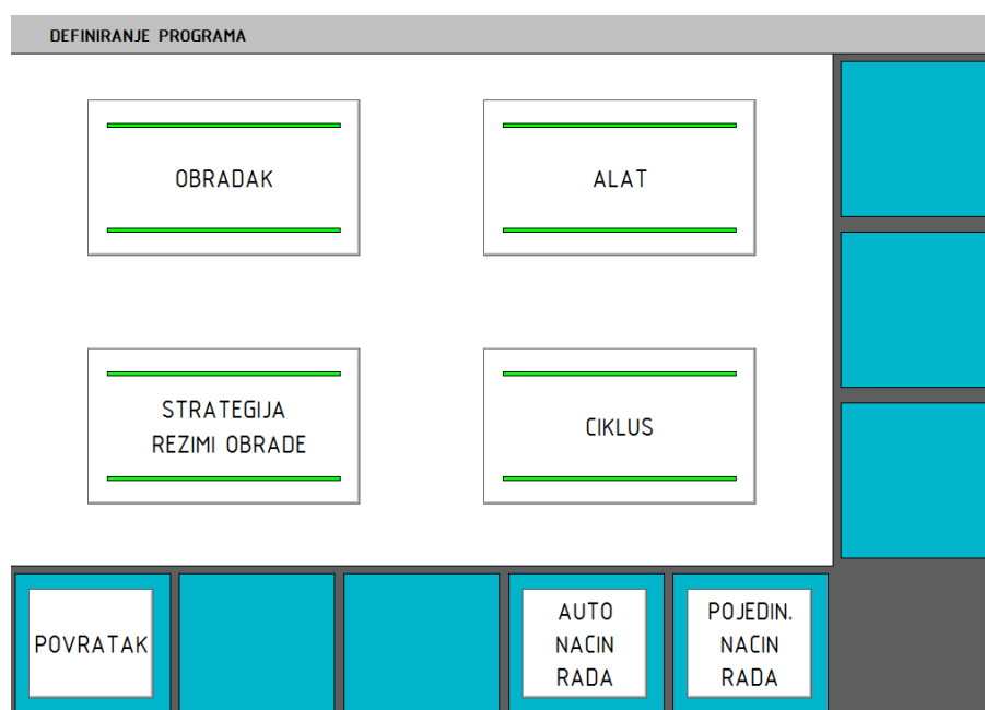
Slika 4.32 Izbornik DEFINIRANJE PROGRAMA u slučaju kada je stroj spreman za rad
