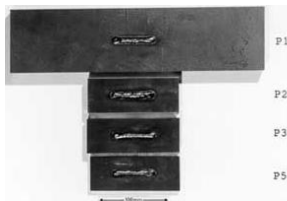
Slika 25. Ispitni uzorci Pellini metode [11]
