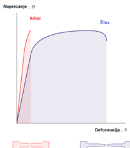
Slika 2. Tipični dijagram naprezanja za žilavi i krhki materijal [2].
