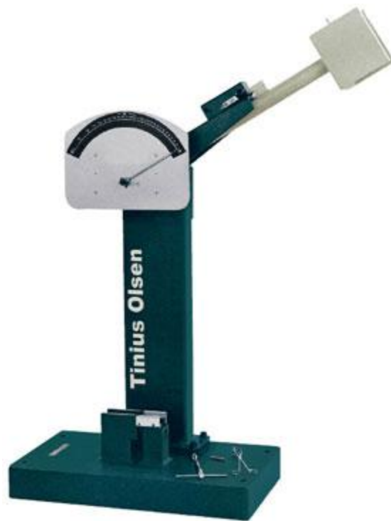
Slika 9. Uređaj za ispitivanje Charpy metodom, Tinius Olsen
