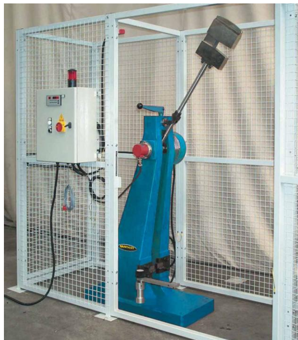
Slika 10. Uređaj za ispitivanje Charpy metodom, Atico
