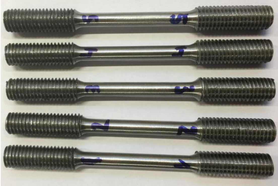
Slika 49. Epruvete za statičko vlačno ispitivanje
