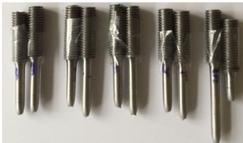
Slika 55. Prikaz lomova svih epruveta
