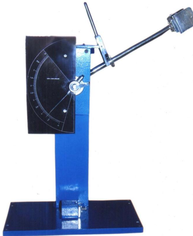
Slika 22. Uređaj za ispitivanje Izod metodom [9]
