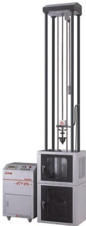
Slika 24. Pellini ispitni uređaj [10]
