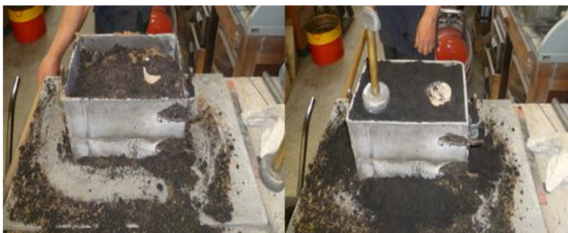
Slika 56. Punjenje gornjaka kalupa i sabijanje kalupne mješavine nakon dodavanja crne dopunske kalupne mješavine
