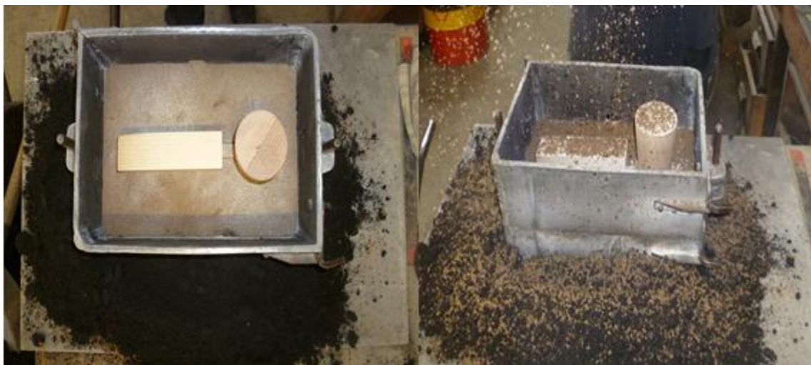
Slika 55. Postavljanje gornjaka kalupa i punjenje modelnom kalupnom mješavinom
