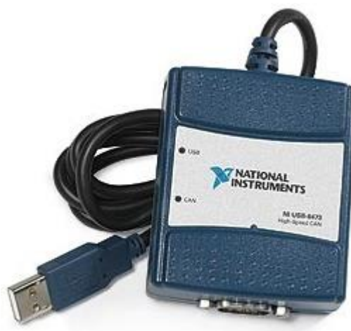
Slika 26. Dijagnostički uređaj NI USB-8473s.
