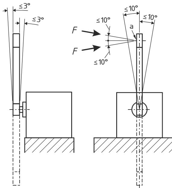
**Slika 4. Ispitivanje momentnog ključa u vertikalnom položaju [1]**
