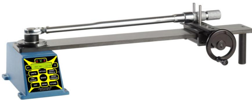
**Slika 10. STWCS merna jedinica s priključkom za opterećivanje [6]**
