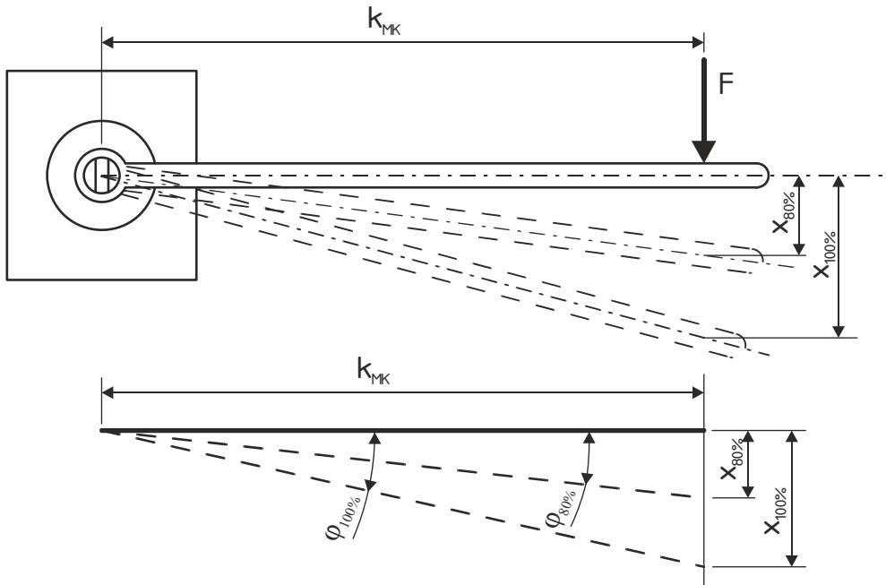
**Slika 28. Ispitivanje zakreta moment ključa pri opterećenju**
