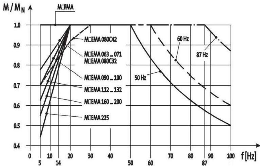
Slika 30. Karakteristika motora u ovisnosti o frekvenciji [9]
