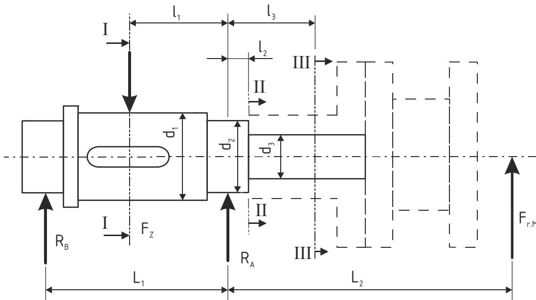
Slika 32. Sile na vratila V2, V3 i V4
