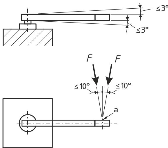
**Slika 5. Ispitivanje momentnog ključa u horizontalnom položaju. [1]**
