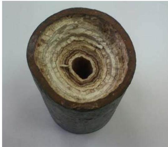
Slika 11. Kamenac u vodovodnim cijevima [16]
