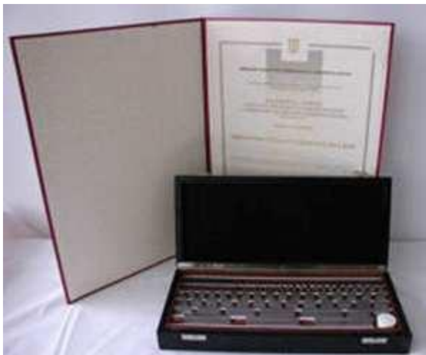
Slika 9. Planparalelne granične mjerke [15]
