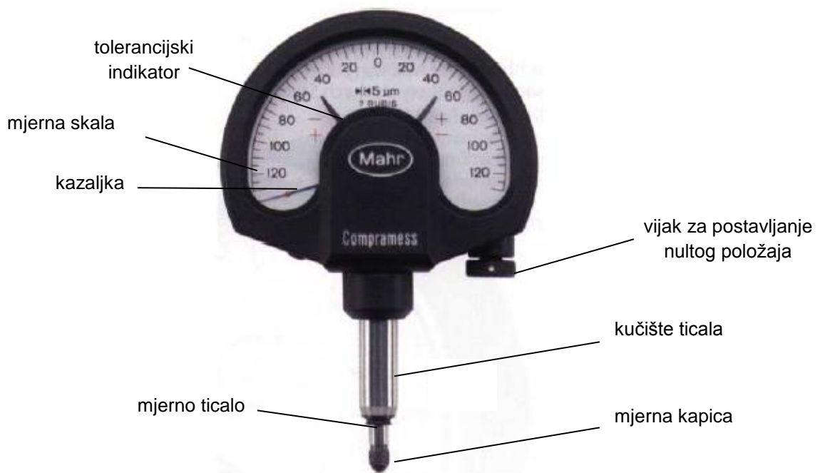
Slika 44. Sastavni dijelovi komparatora [7]
