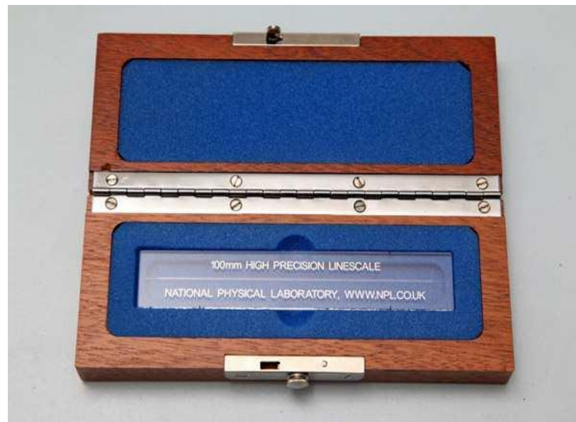
Slika 11. Precizna staklena mjerna skala NPL, SM/RET 228-513 [15]
