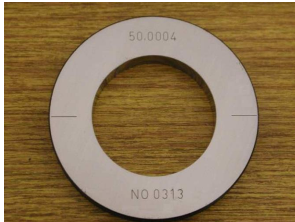
Slika 10. Etalonski mjerni prsten Joint [15]
